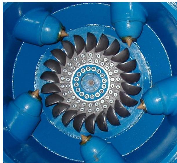
**Slika 6: Pelton turbina sa mlaznicama i rotorom**
