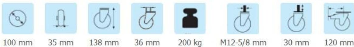
Slika 17. Kotačić s kočnicom 3801-RPB-100-F09 tvrtke Kama
