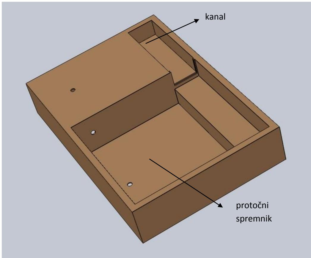
Slika 23. 3D model protočnog spremnika tvrtke Lepoglavec
