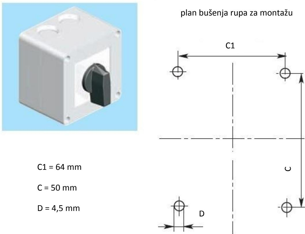
Slika 30. Izgled sklopke GN 12 tvrtke Končar i raspored rupa za montažu
