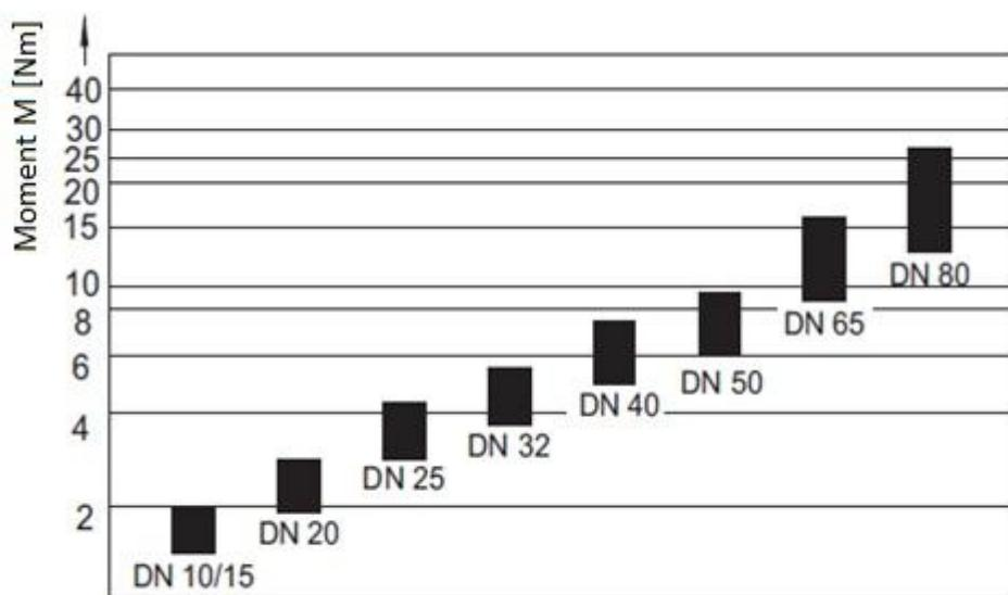
Slika 14. Potreban moment za regulaciju ventila S4 tvrtke Praher Valves
