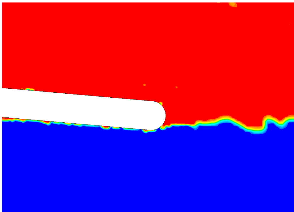
Slika 48: Uvećani dio slobodne površine u blizini zadnjeg dijela profila, ( \alpha = 5^\circ , D = 0.03 )
