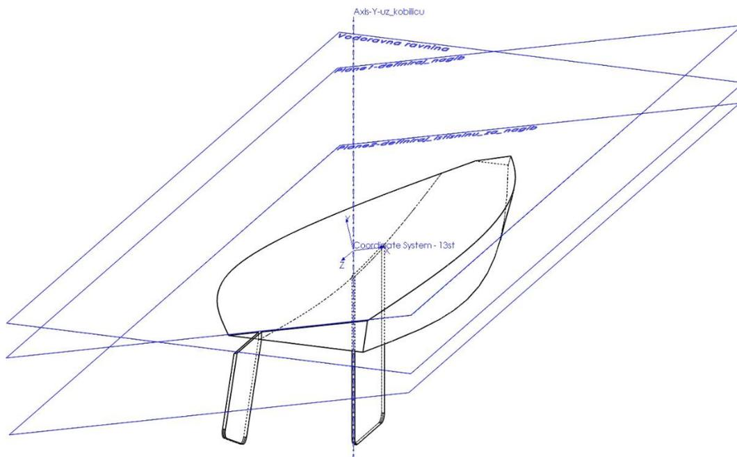
**Slika 16.** Izometrijski prikaz 3D modela s poprečnim (bočnim) nagibom od 13 stupnjeva
