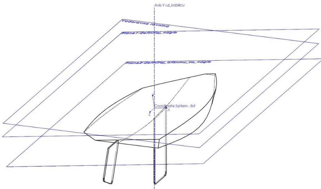
Slika 12. Izometrijski prikaz 3D modela s poprečnim (bočnim) nagibom od 8 stupnjeva
