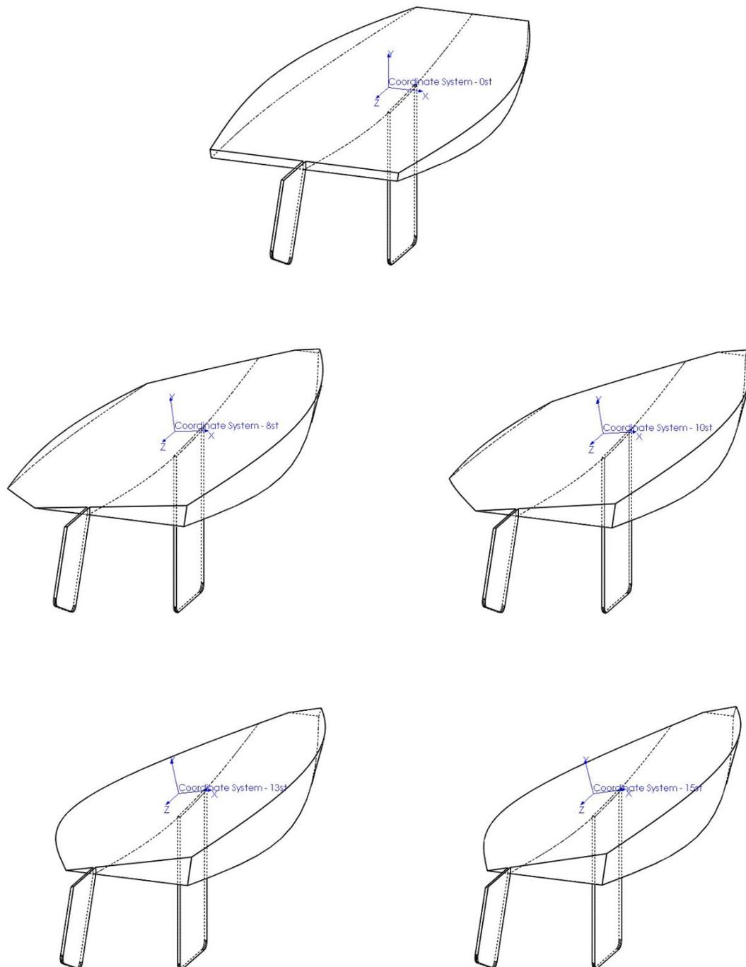
**Slika 19. Usporedni prikaz poprečnih (bočnih) nagiba**
