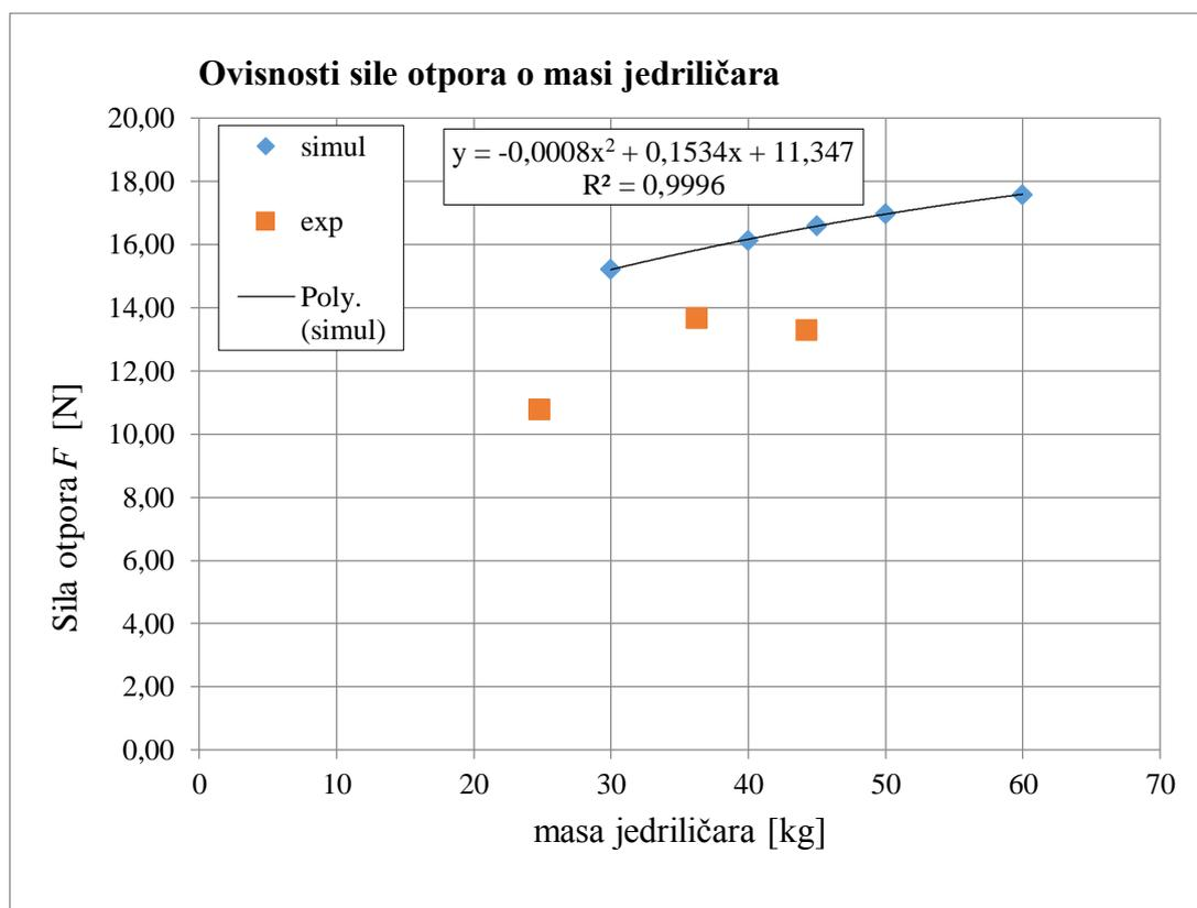
**Slika 65. Ovisnosti sile otpora o masi jedriličara, usporedba simulacije i izmjerenih podataka**
