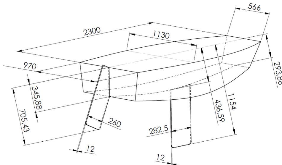
Slika 7. Osnovne dimenzija prikazane na 3D modelu
