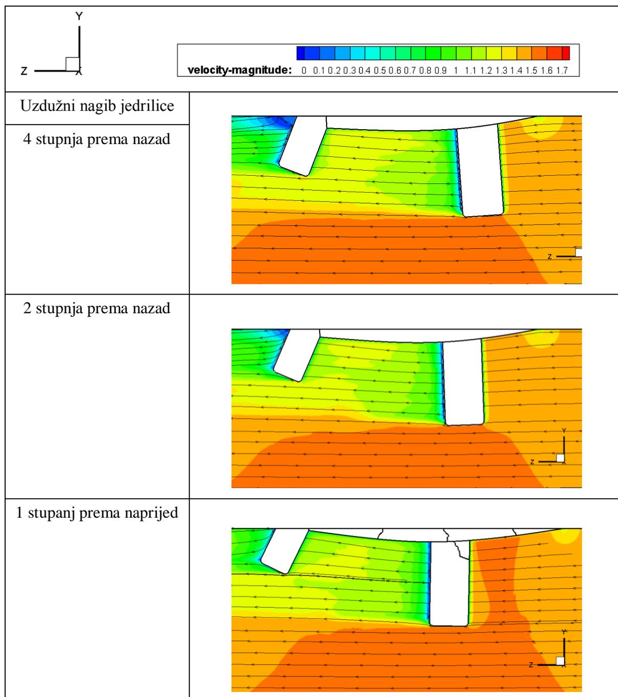
Slika 57. Promjena polja apsolutne brzine s uzdužnim nagibom jedrilice
