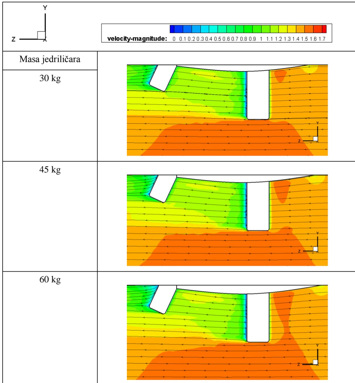
Slika 55. Promjena polja apsolutne brzine s masom jedriličara
