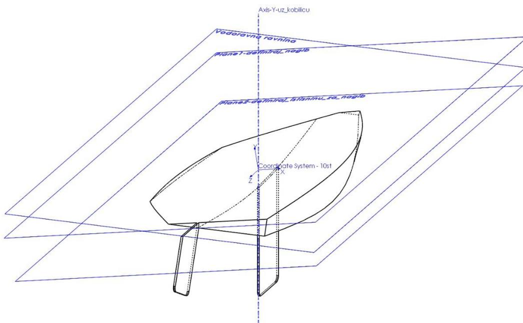
**Slika 14.** Izometrijski prikaz 3D modela s poprečnim (bočnim) nagibom od 10 stupnjeva
