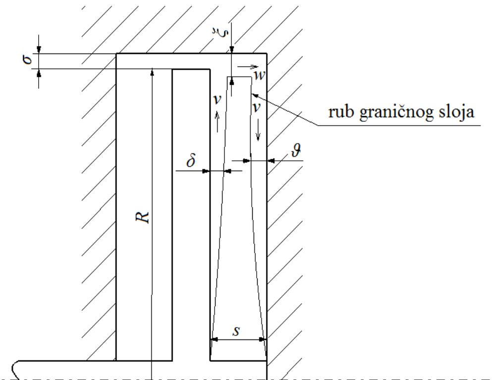
Slika 15. Granični slojevi rotirajućeg diska u kućištu
