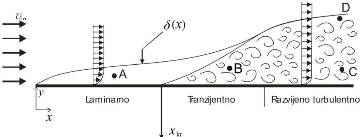
**Slika 1. Prijelaz iz laminarnog u turbulentno strujanje**
