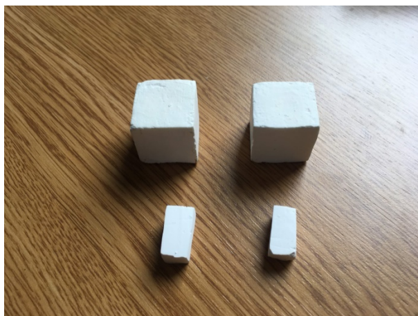
Slika 43. Keramički uzorci nakon sinteriranja
