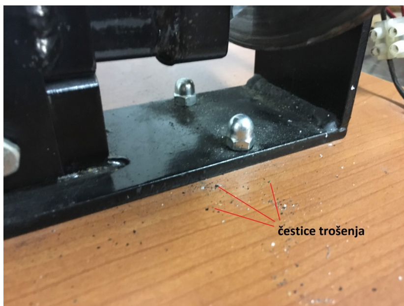
Slika 52. Čestice trošenja ispod uređaja za ispitivanja
