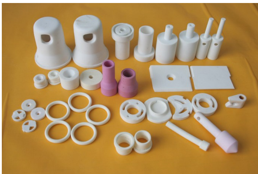
Slika 11. Primjeri raznih dijelova napravljenih od \text{Al}_2\text{O}_3 keramike [22]
