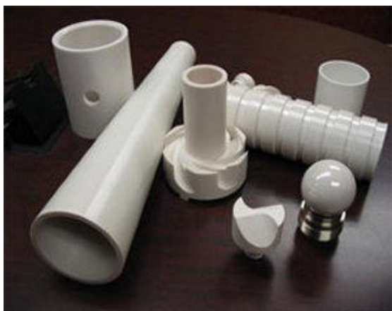
Slika 12. Primjeri dijelova od ZrO_2 keramike [25]
