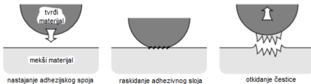
Slika 19. Faze adhezivnog trošenja [33]
