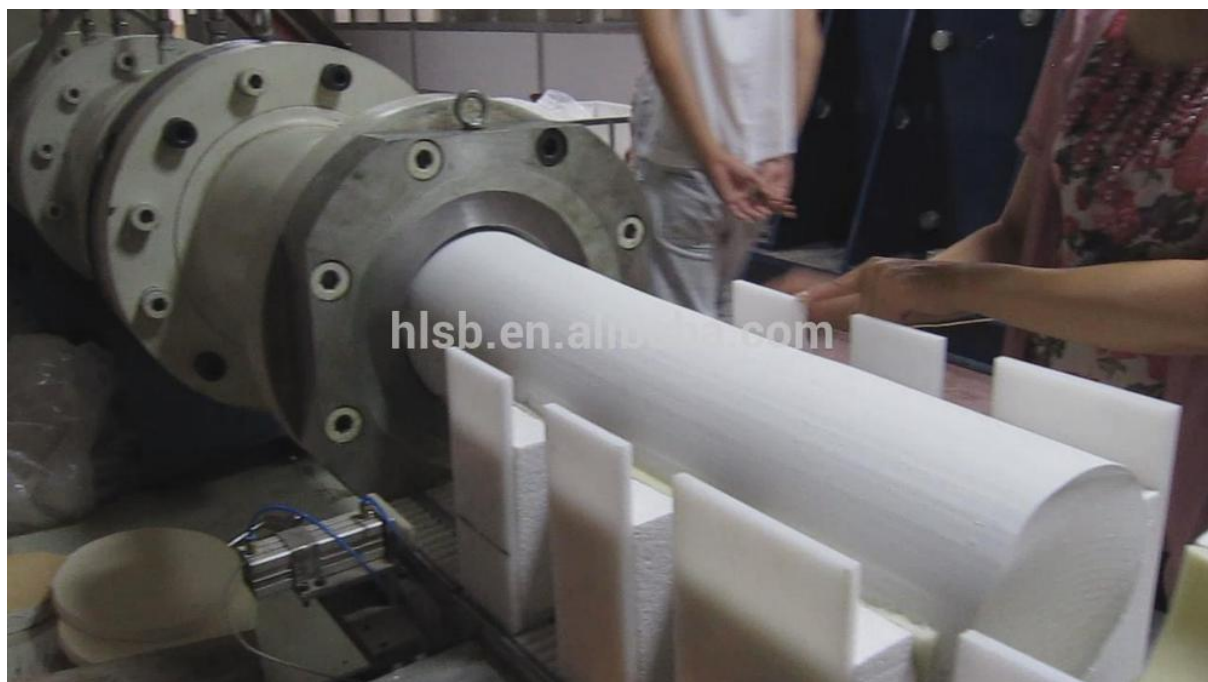
Slika 3. Ekstrudiranje keramičkog sirovca [9]
