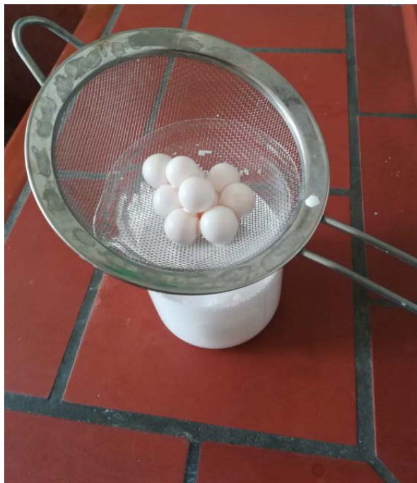
Slika 35. Odvajanje kuglica mlina cijedenjem
