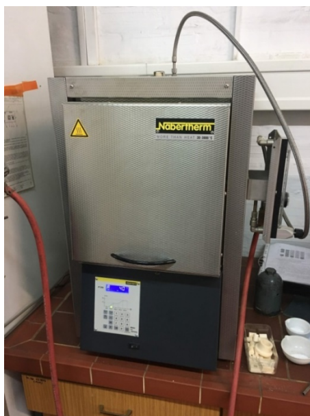
Slika 41. Laboratorijska peć za sinteriranje Nabertherm P310
