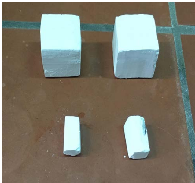
Slika 40. Sirovci nakon zelene obrade
