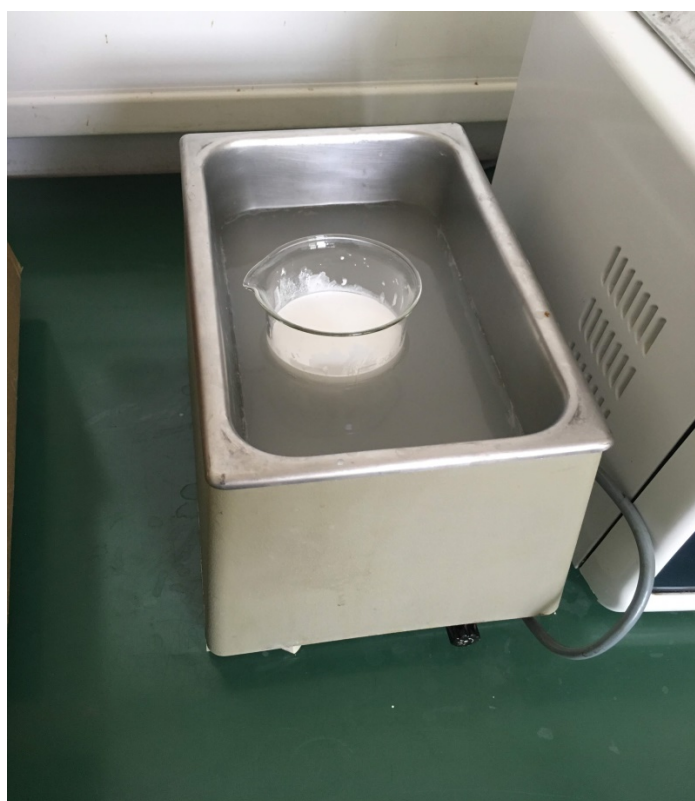
Slika 36. Suspenzija u ultrazvučnoj kupelji
