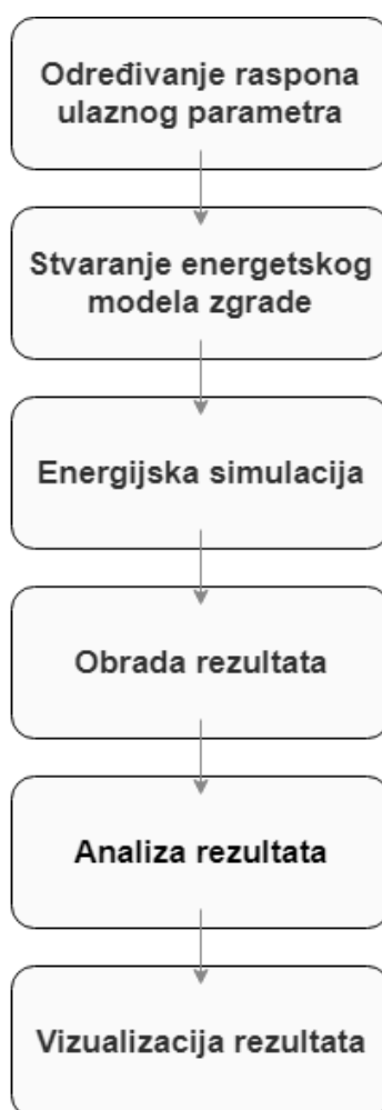
Slika 13 Dijagram toka strukturiranog procesa analize osjetljivosti [9]
