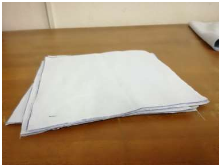
Slika 5.3. Platno kao ojačalo izrezano na zadane dimenzije kalupa
