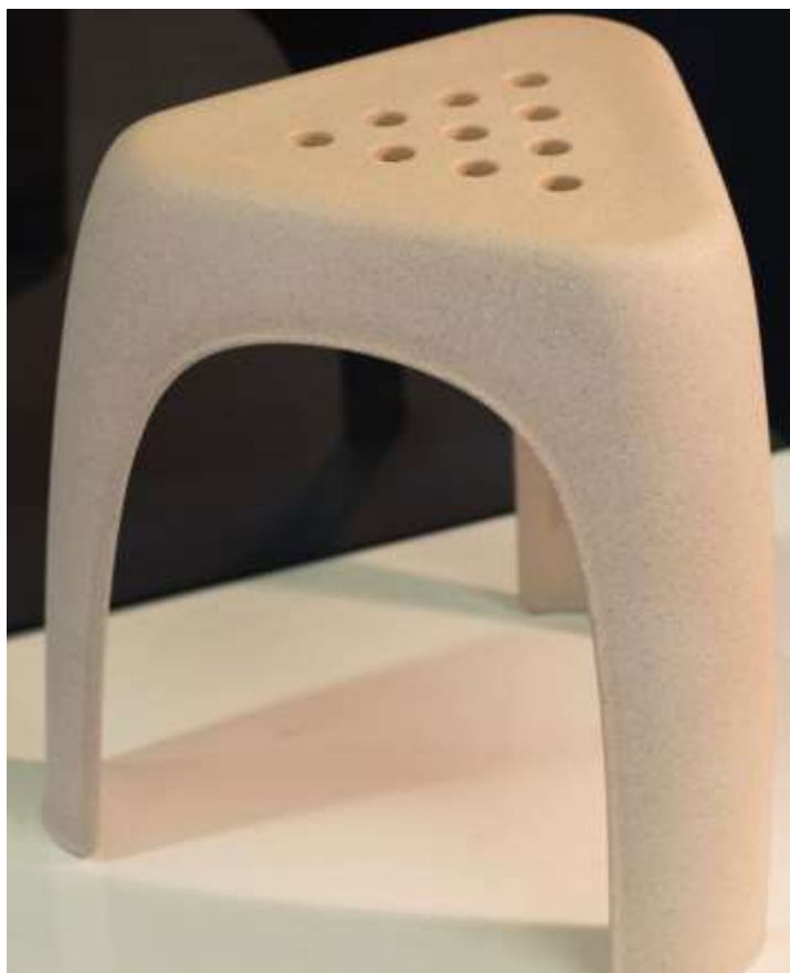
Slika 4.12. Stolica ojačana prirodnim vlaknima lana u PLA-matrici [34]
