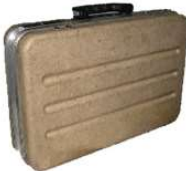
Slika 4.15. Kovčeg izrađen od kompozitnog materijala ojačanog lanenim vlaknima [35]
