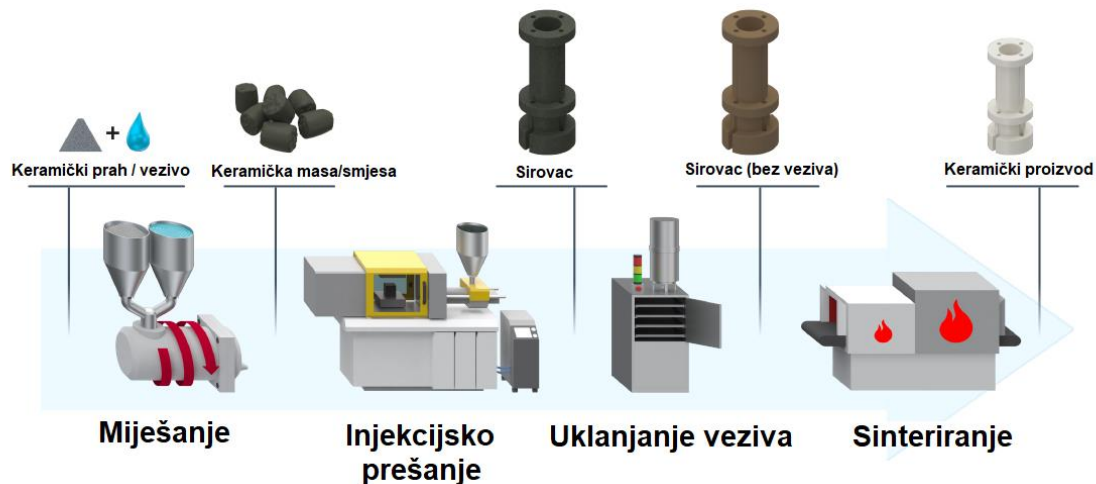
Slika 11. Postupak injekcijskog prešanja keramike (CIM)[17]
