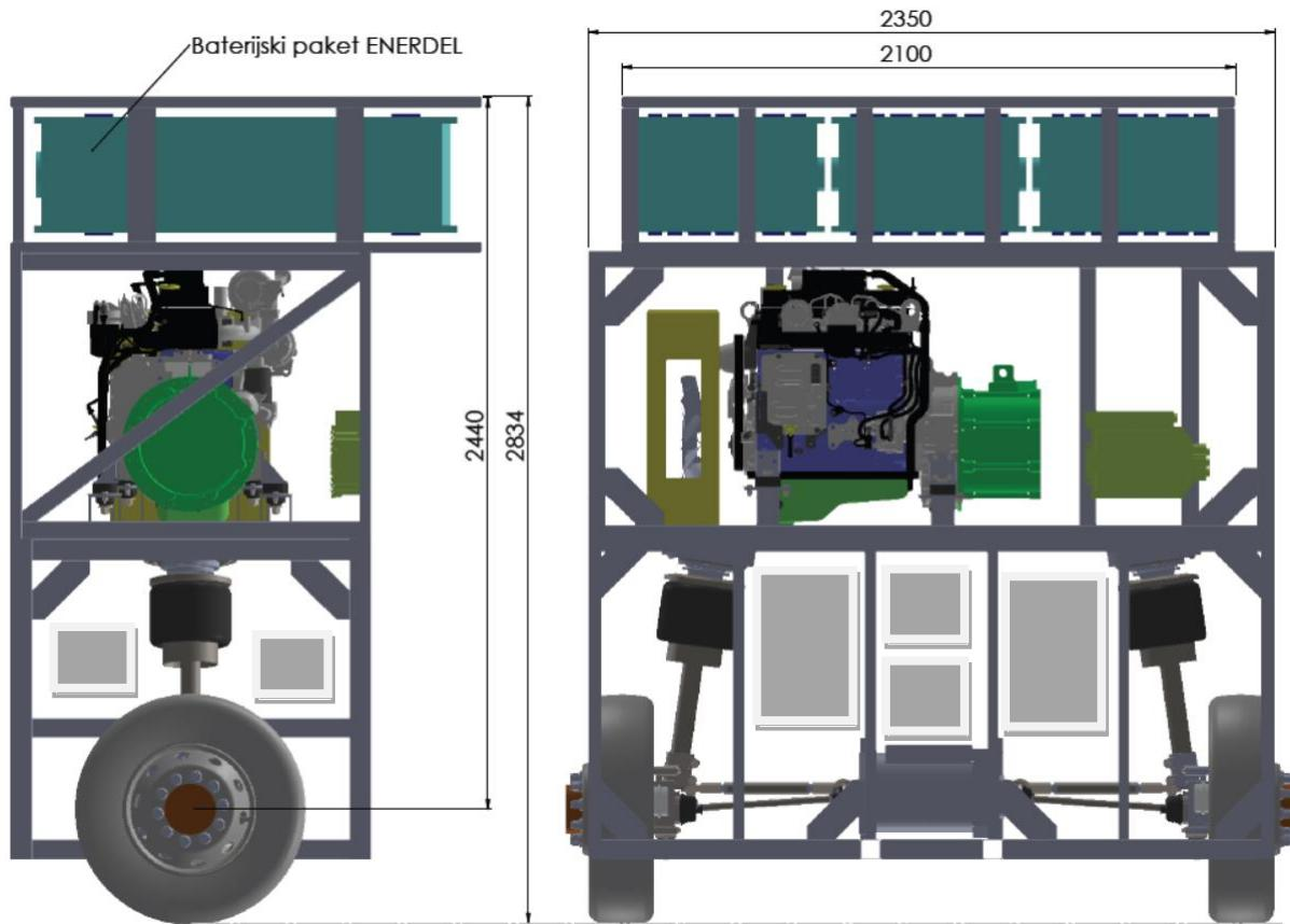
**Slika 9.10. Konfiguracija s modulom sklopa baterijskog paketa smještenim na krovu vozila**
