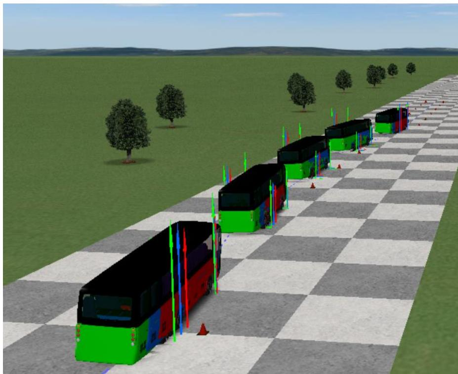
**Slika 2.11. Simulacija dvostrukе izmjene pravca u CarSim programskom paketu [7.]**
