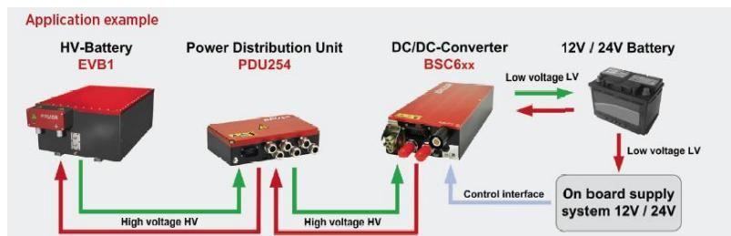
Slika 3.11. Prikaz ugradnje DC-DC konvertera tvrtke Brusa [19.]
