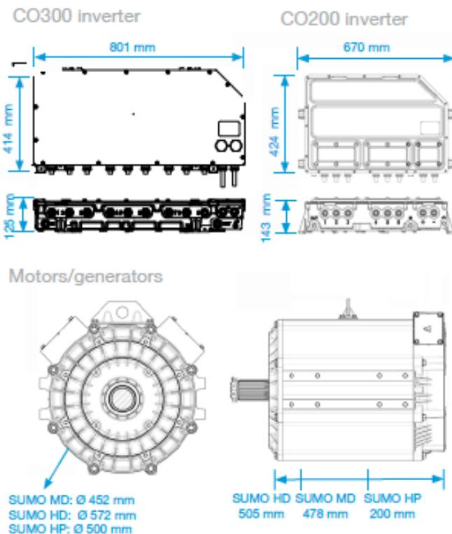
**Slika 4.8. Dimenziije invertera i motora/generatora SUMO MD, SUMO HD i SUMO HP konfiguracije [28.]**
