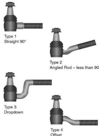
**Slika 7.6. Moguće izvedbe krajnika bočne vodilice [51.]**
