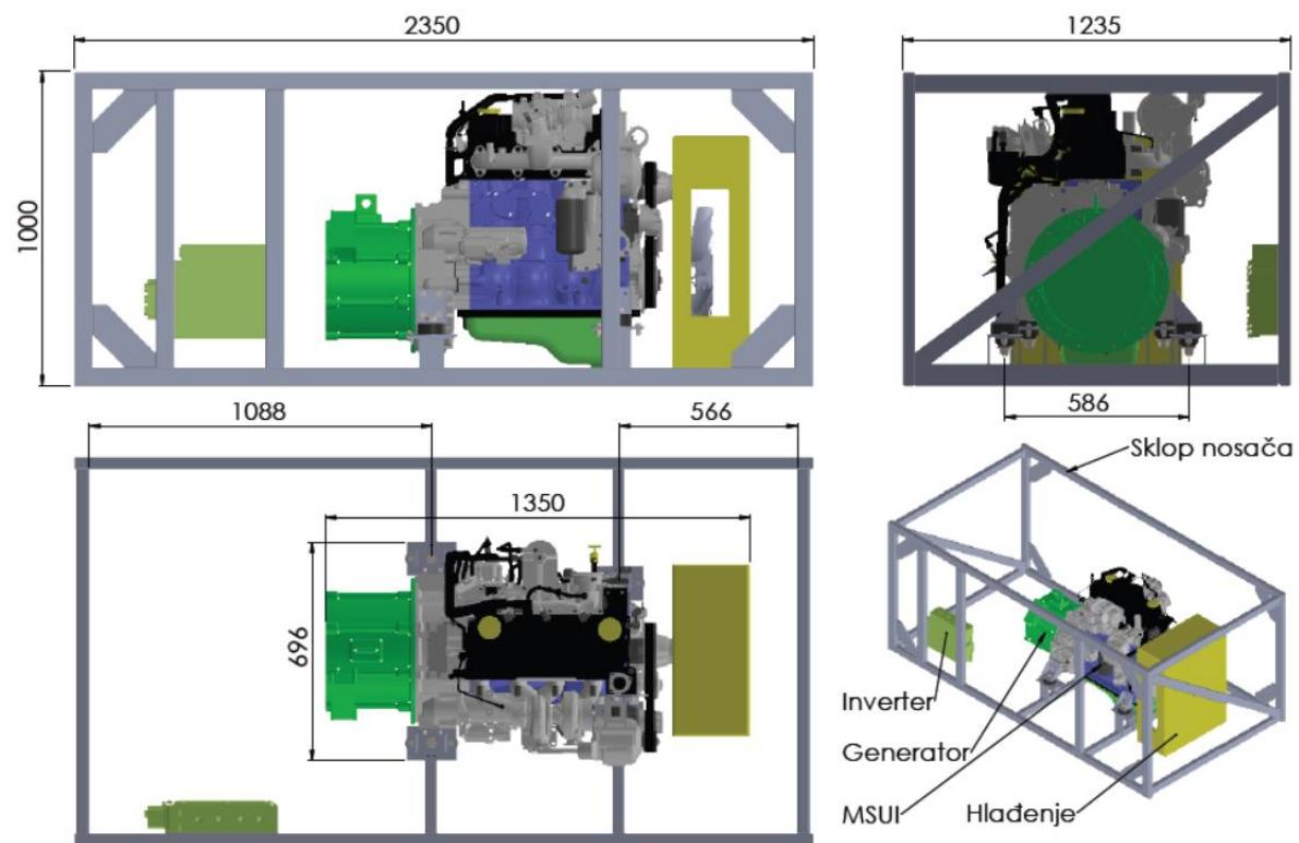
Slika 9.7. Modul sklopa MSUI, generatora i invertera, modul 2
