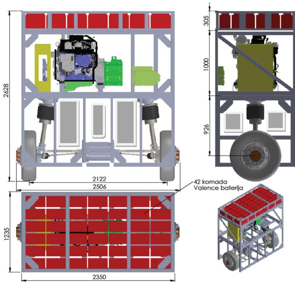
Slika 9.13. Modul baterija manjeg kapaciteta smješten na krovu
