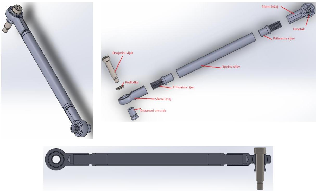
Slika 7.11. Sklop bočne vodilice ovjesa
