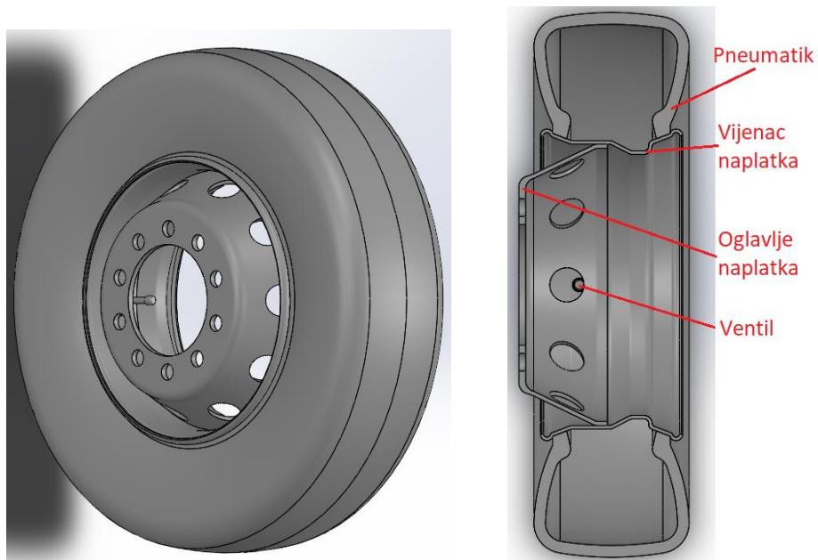
**Slika 8.12. Prikaz 3D modela sklopa pneumatika i naplatka**
