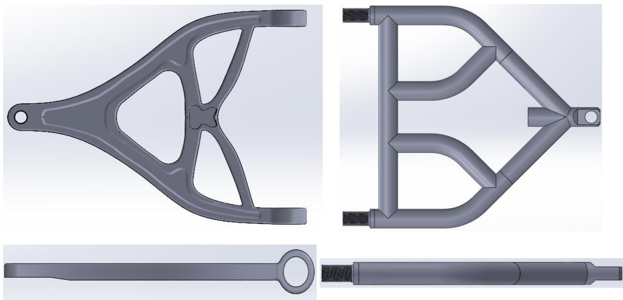
**Slika 7.4. Prikaz 3D modela lijevane izvedbe (desno) i zavarene izvedbe s krajnicima (desno) donjeg poprečnog ramena**
