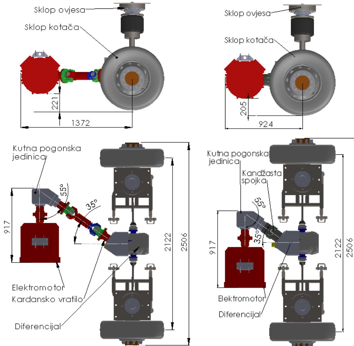
Slika 9.5. Izvedbe pogonskog sustava sa kutnom pogonskom jedinicom
