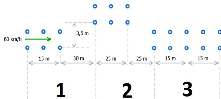
**Slika 2.10. Izgled ispitne staze DLC ispitne procedure**
