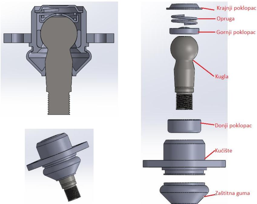
**Slika 7.10. Sklop kuglastog zgloba donjem poprečnog ramena**
