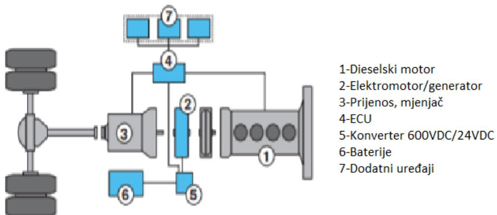
**Slika 3.5. Izvedba pogonskog sustava Volvo 7900 Hybrid autobusa [14.]**
