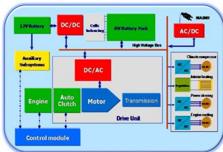
**Slika 3.10. Prikaz toka električnog napona unutar hibridnog vozila [18.]**
