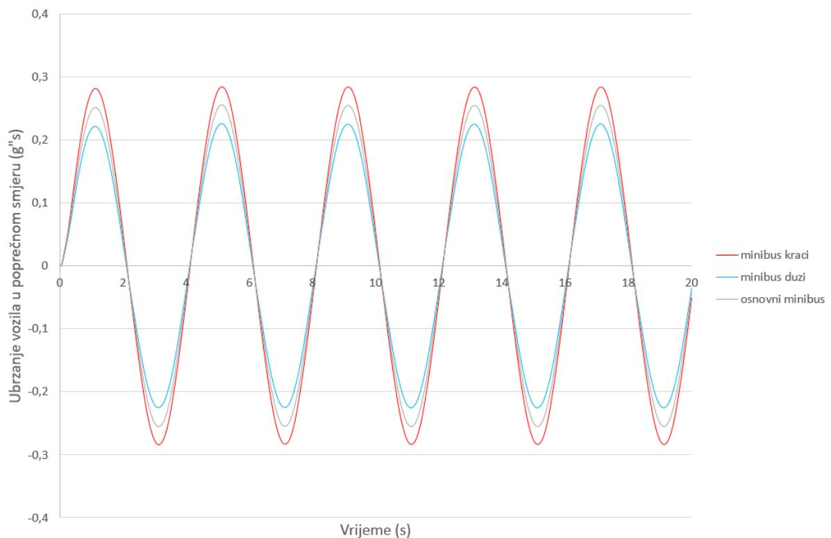
**Slika 2.16. Utjecaj duljine vozila na bočno ubrzanje kod Sine Wave Steer Input procedure**
