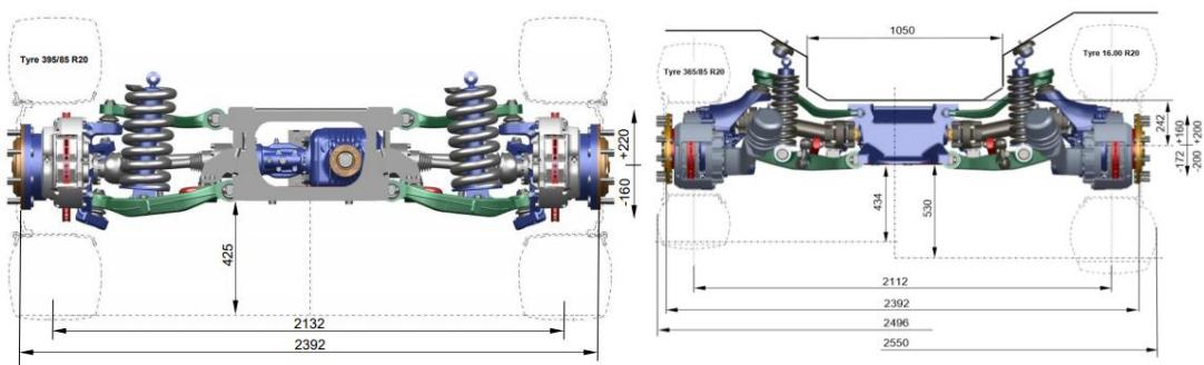
Slika 4.13. Dimenziije osovina AX 80 (lijevo) i AX 75 (desno) [30.]
