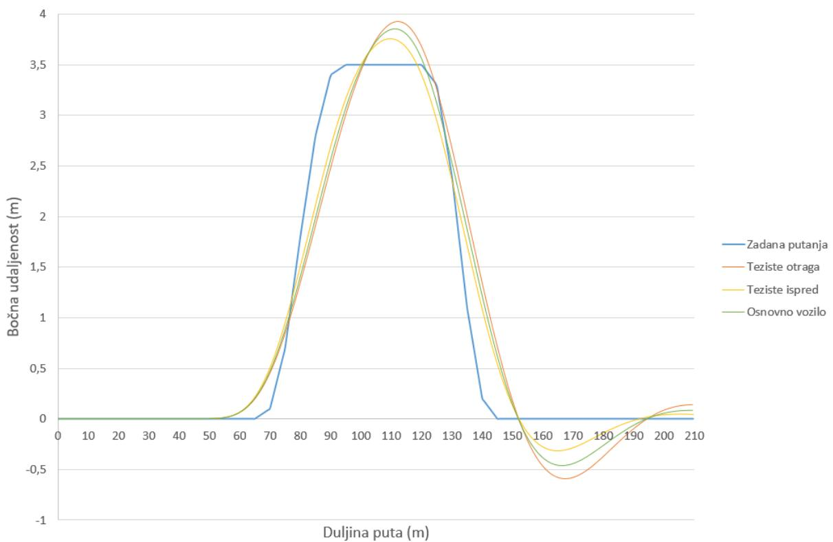
**Slika 2.12. Odstupanje vozila različitih konfiguracija položaja težišta od zadane putanje kod ispitne procedure dvostrukog promjene pravca gibanja**
