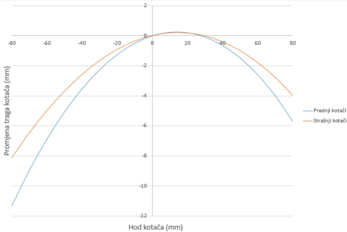
Slika 5.5. Ovisnost traga kotača i hoda kotača
