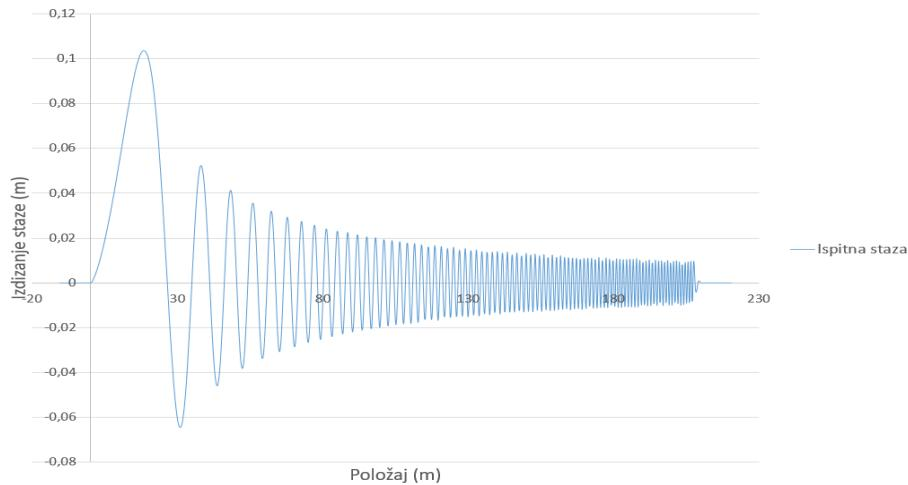
**Slika 2.8. Sinusoidna pobuda podlogom kod Bounce Sine Sweep procedure**
