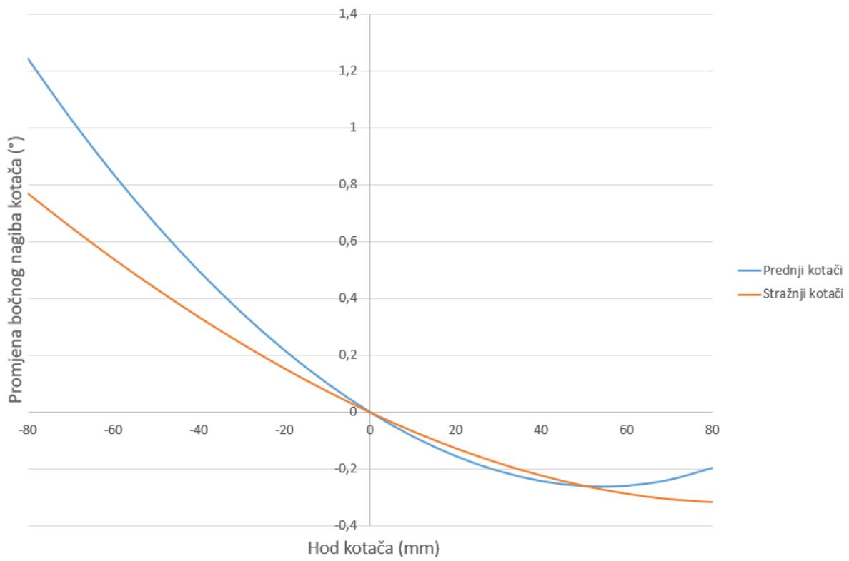
Slika 5.2. Ovisnost bočnog nagiba kotača i hoda kotača
