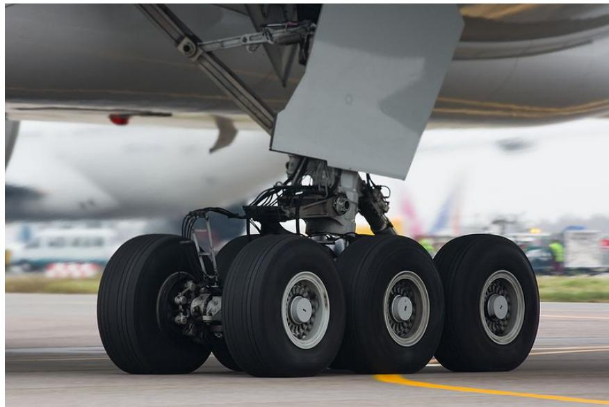
Slika 1: Stražnji stajni trap, Boeing 777
