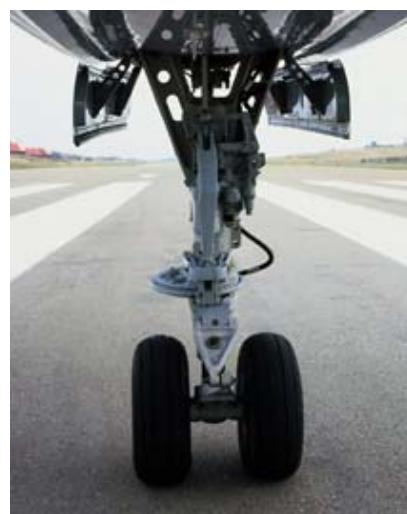
Slika 13: Prednji stajni trap, Saab 340
