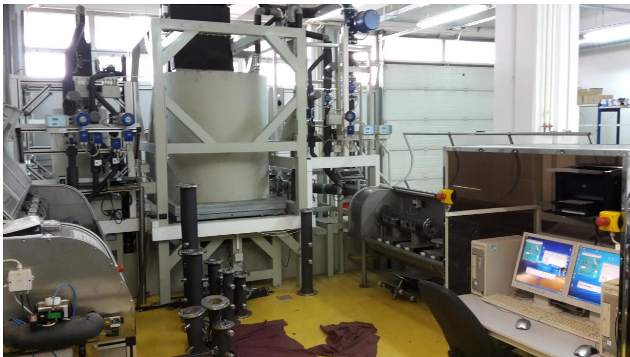
Slika 22. Umjeravanje mjerila protoka na ispitnoj liniji MT10/15-40
