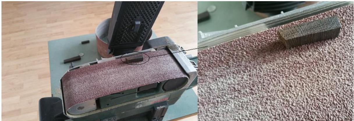
**Slika 39. Stolna brusilica i obrada uzorka**
