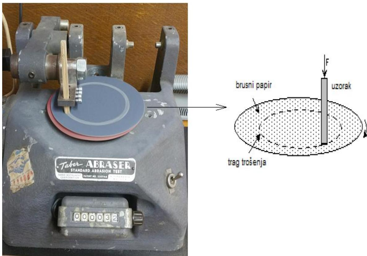
Slika 42. Uredaj za ispitivanje otpornosti na abrazijsko trošenje „Taber abrader“
