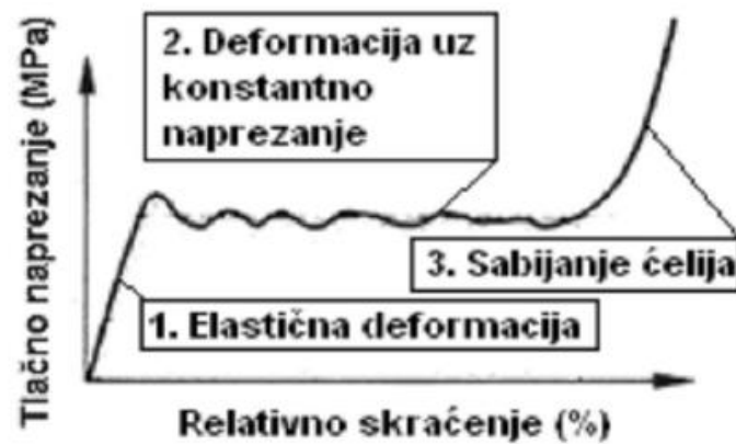
Slika 15 Dijagrama tlačnog naprezanja i tlačne deformacije metalne pjene [5]
