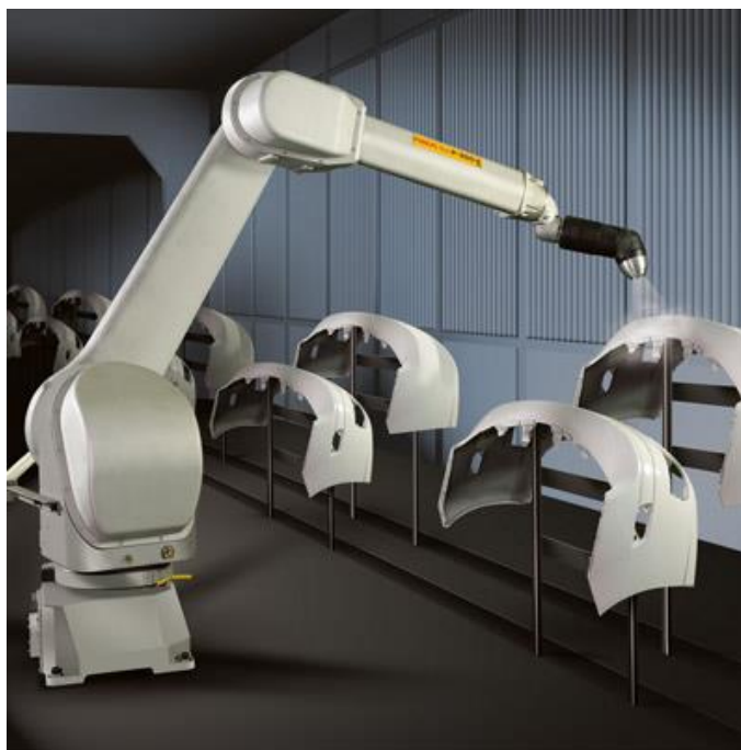
Slika 16. FANUC roboti za bojanje [20]
