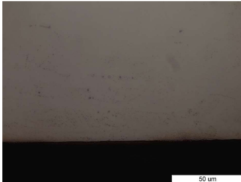
Slika 47. Prikaz rubnog sloja uzorka prevučenog u TENIFER kupci
