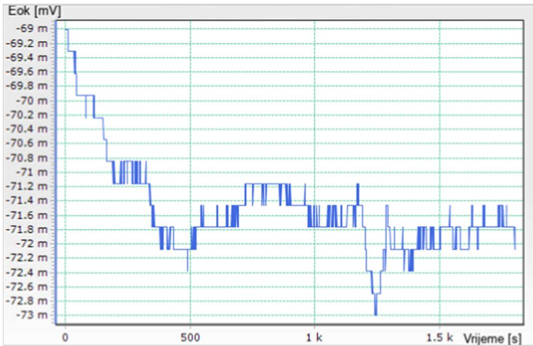
**Slika 39.** Dijagram potencijala otvorenog strujnog kruga za uzorak Ti6Al4V prevučen
