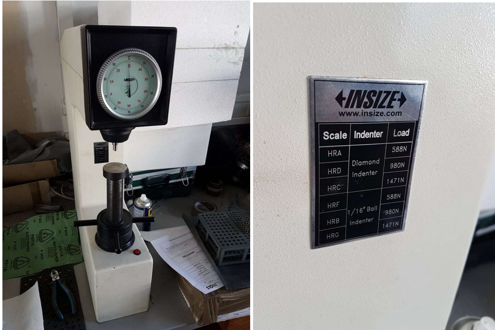
Slika 30. Tvrdomjer korišten za ispitivanje adhezivnosti prevlake
