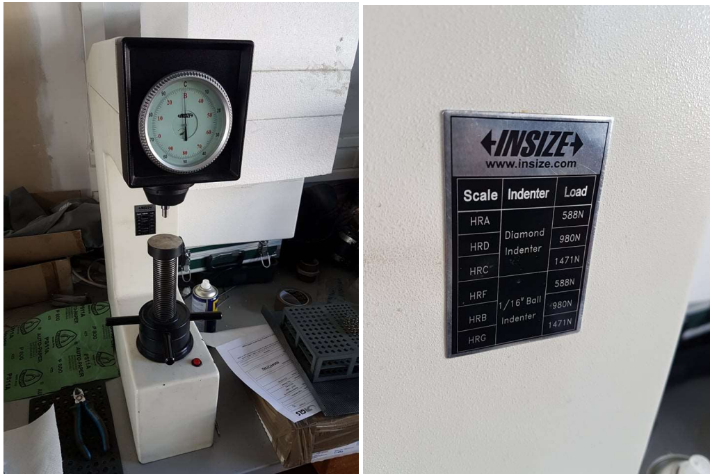
Slika 30. Tvrdomjer korišten za ispitivanje adhezivnosti prevlake
