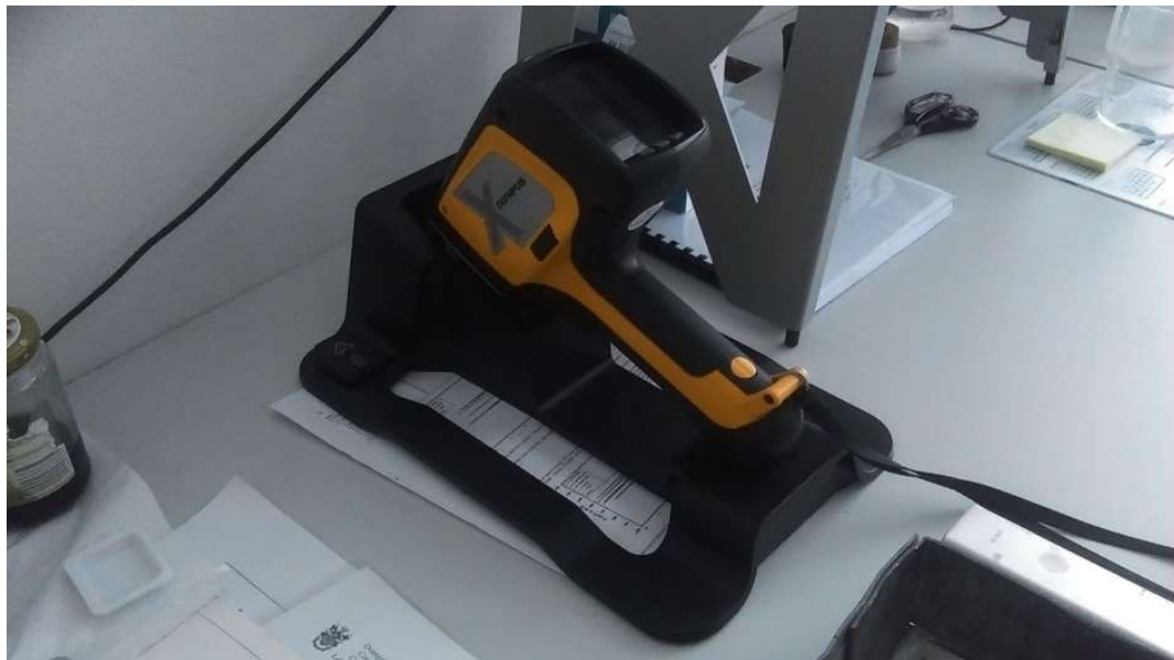
Slika 17. Uređaj Olympus X za određivanje kemijskog sastava
