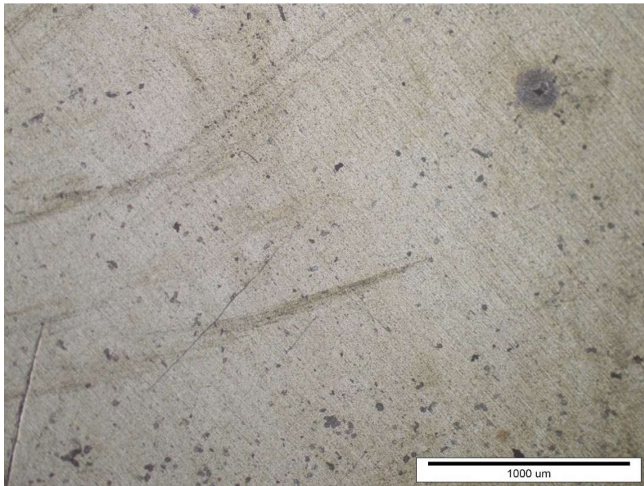
Slika 35. Uzorak nitriran u plazmi (povećanje 50x)
