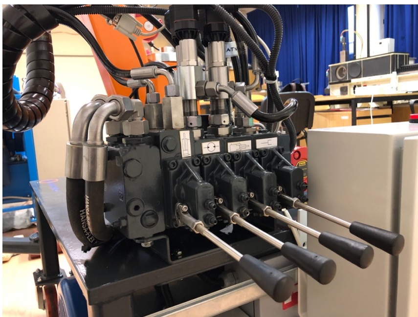
Slika 2. Proporcionalni ventilski blok s označenim segmentima
