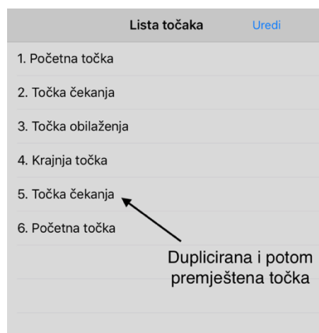
Slika 30. Prikaz tablice točaka nakon dupliciranja točke i njenog premještanja na željenu poziciju u tablici
