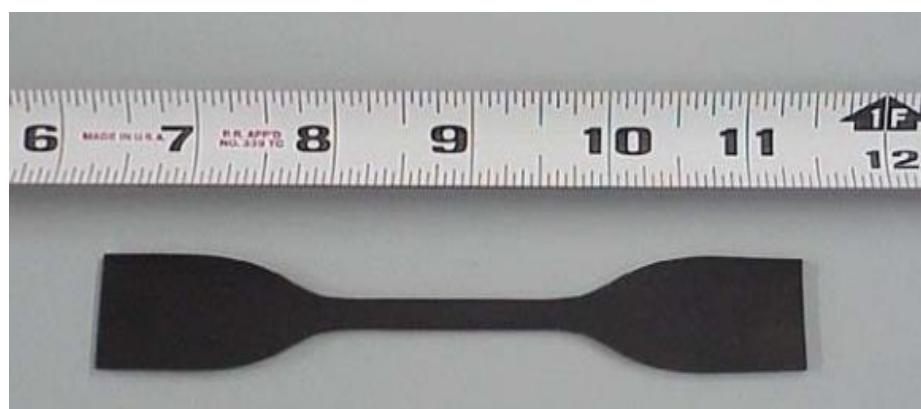
Slika 4. Epruveta od elastomera (gume) [3]
