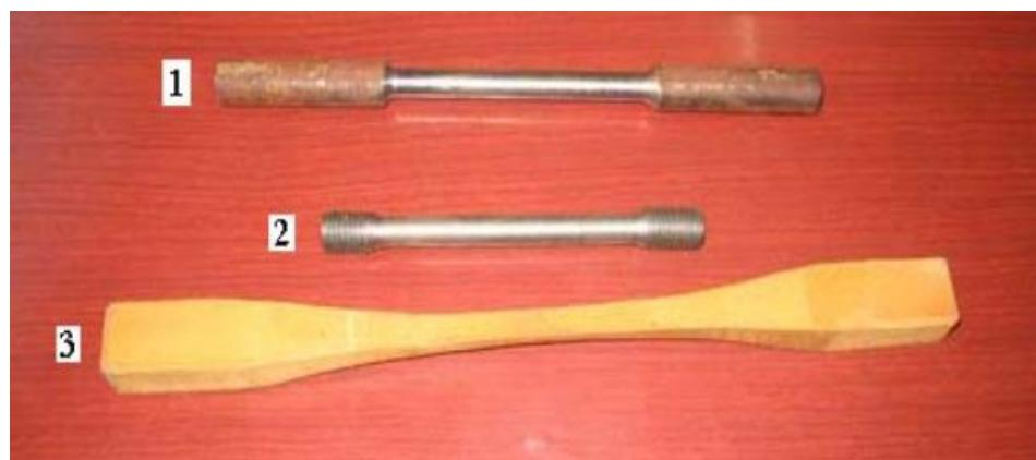
**Slika 6. Epruvete od čelika (1), nodularnog ljeva (2), drva (3) [3]**
