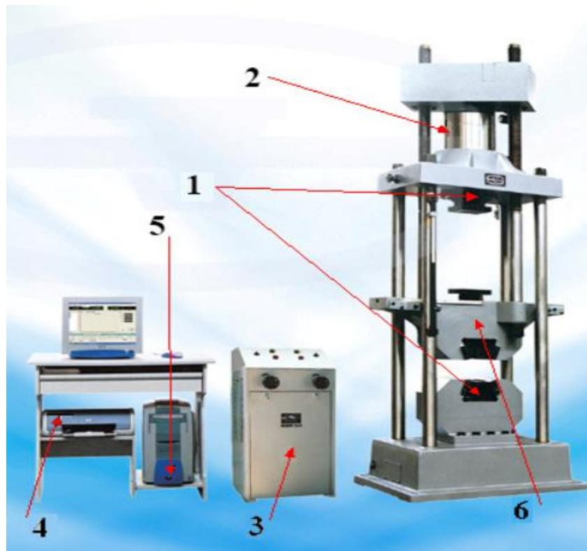
**Slika 18. Suvremena hidraulička kidalica [6]**
