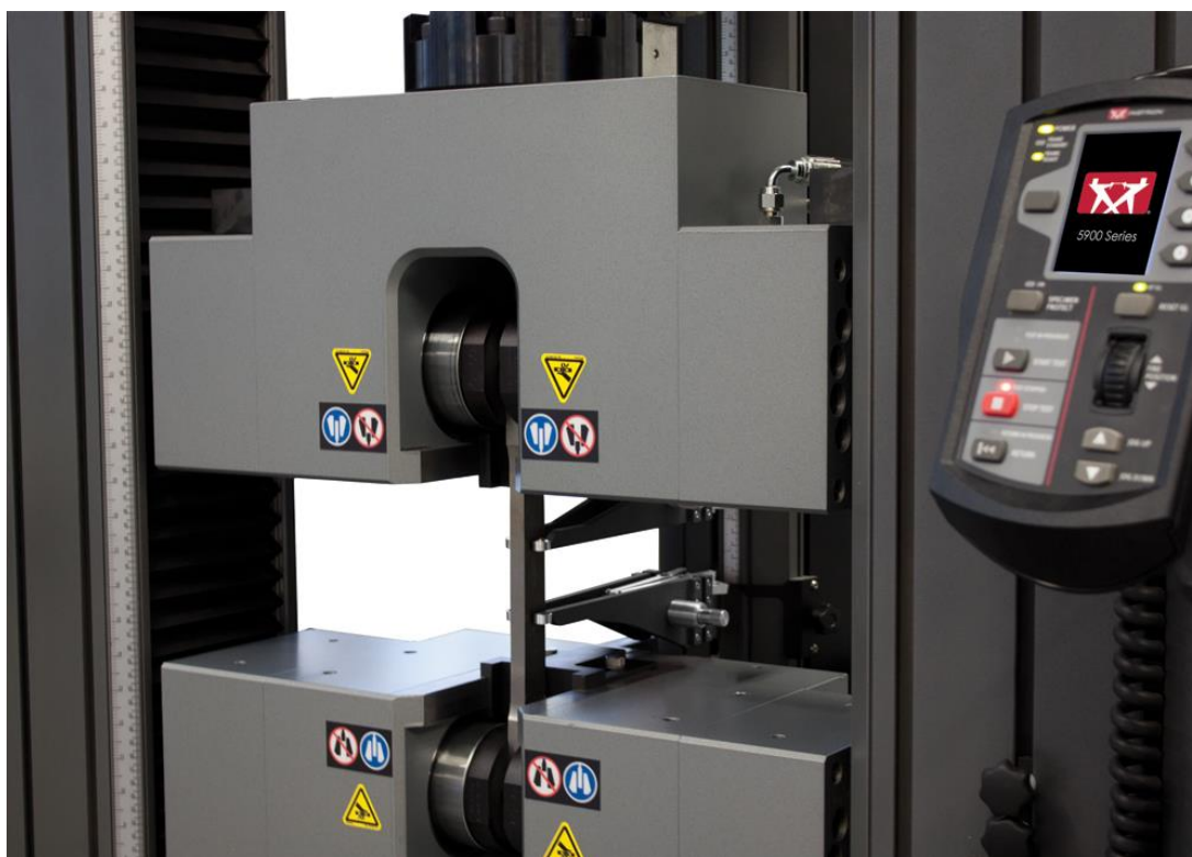
Slika 20. Primjer stezanja ispitnih uzoraka u stezne čeljusti kidalice [8]
