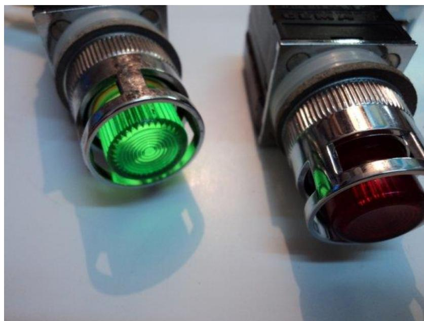
*Slika 19. Tipkala s LED osvjetljenjem*
