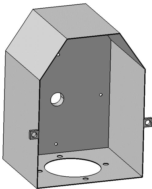
Slika 13. Kućište mlina
