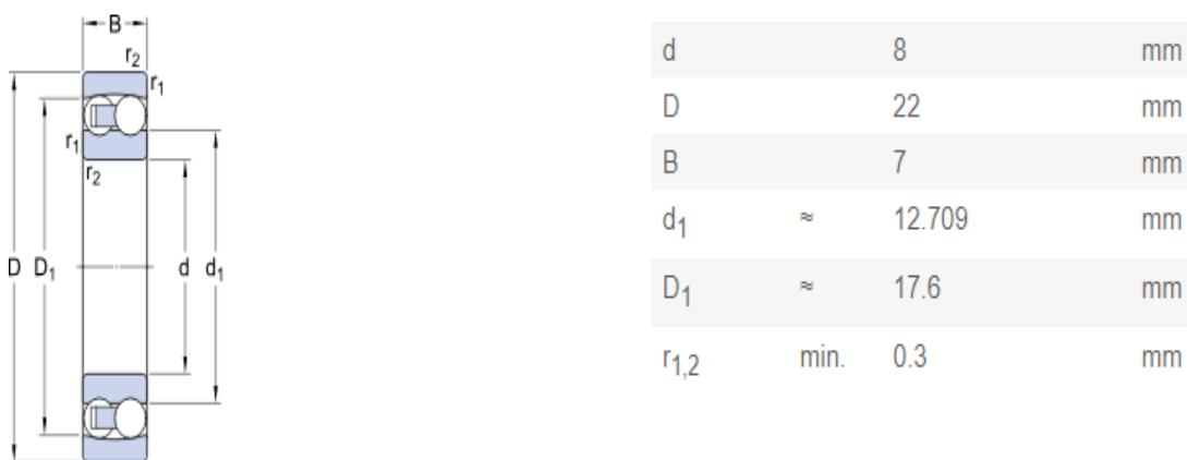
Slika 4. Dimenzije kugličnog ležaja elektromotora transportnog sustava [4]
