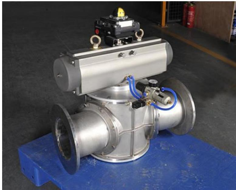
*Slika 16. Pneumatski ventili specijalne izvedbe*
