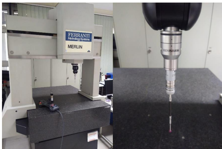
Slika 7. Trokoordinatni mjerni uređaj i mjerno ticalo
