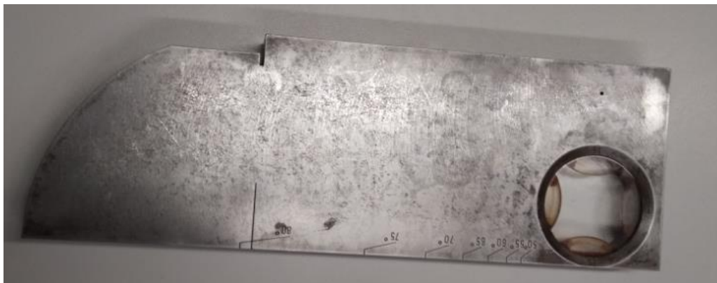
Slika 12. Prikaz površine 300 mm x 100 mm (D) etalona br. 1
