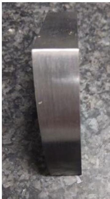
Slika 17. Prikaz mjerne površine kod R25 mm etalona br. 2
