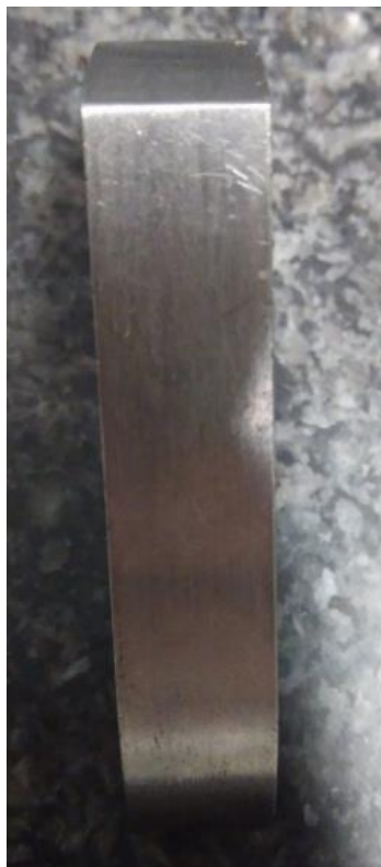
Slika 16. Prikaz mjerne površine kod R50 mm etalona br. 2
