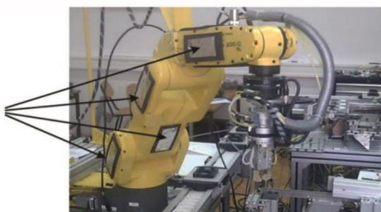
Slika 3. Raspored senzora [2]
