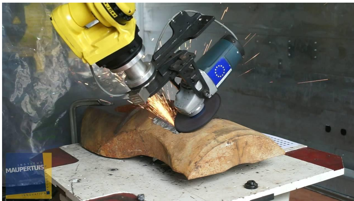
Slika 2. Brušenje zahtjevnije površine pomoću robota
