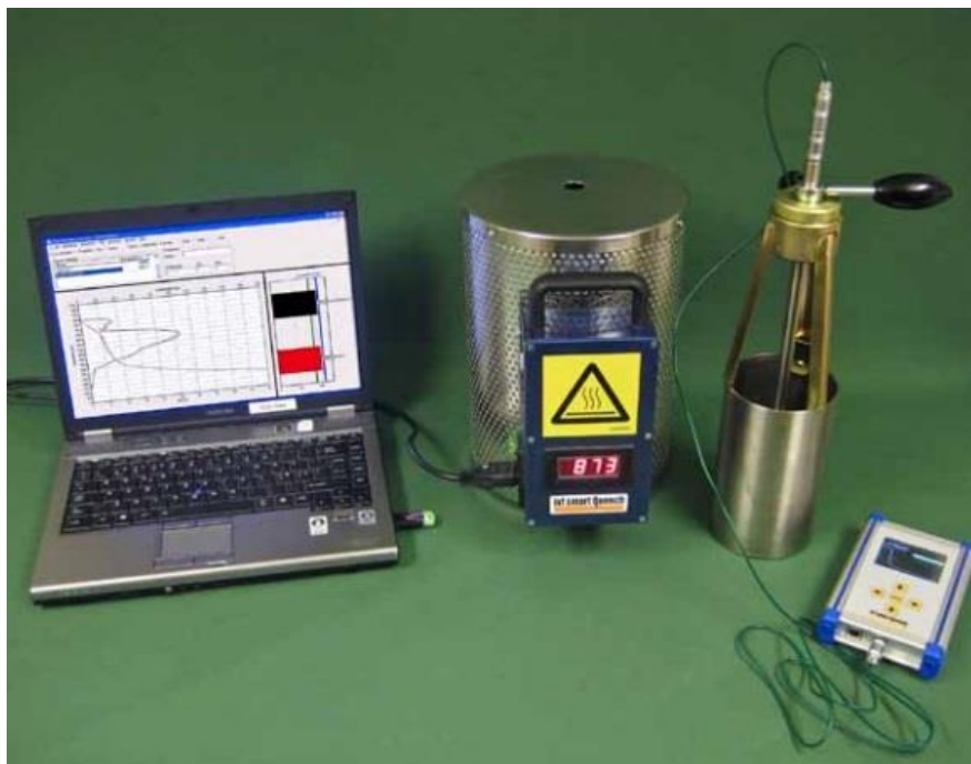
Slika 13. Mjerni sustav IVF Smart Quench za ispitivanje krivulja ohlađivanja prema normi ISO 9950; ASTM D6200 [10]
