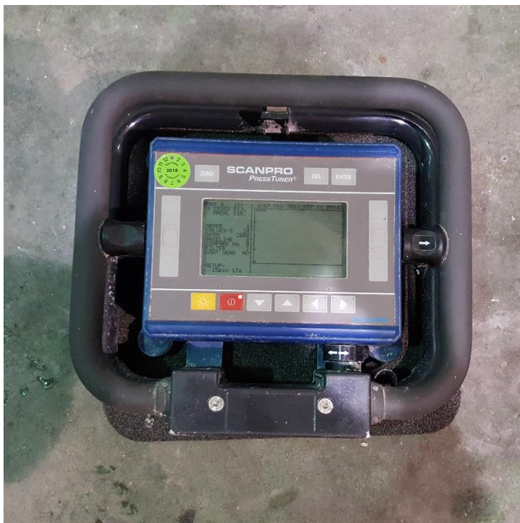
Slika 30. ScanPro – PressTuner uređaj koji koristi mirkrovalove
