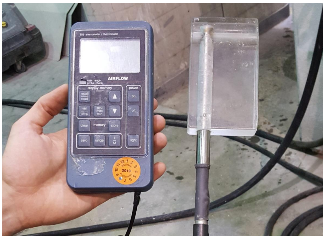
Slika 28. Uređaj za mjerenje protoka zraka
