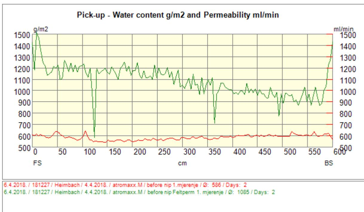
Slika 53. Pick-up, prvo mjerjenje, CD količina vode i propusnost
