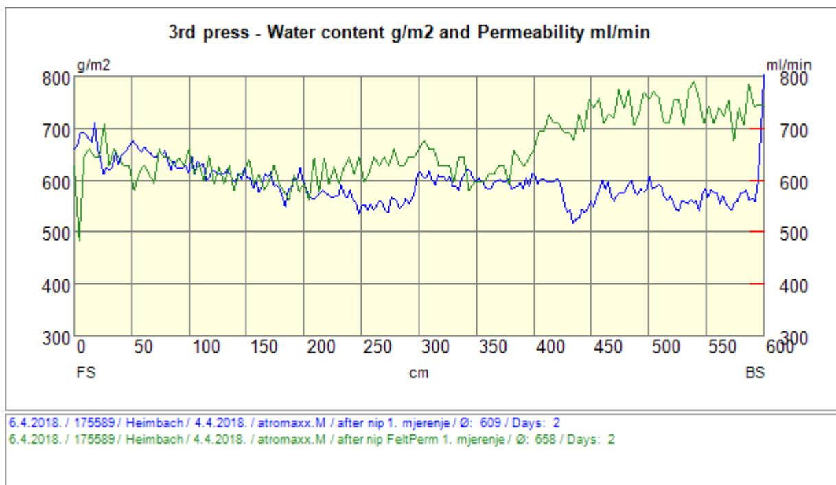
Slika 65. Treći donji filc, prvo mjerjenje, CD količina vode i propusnost
