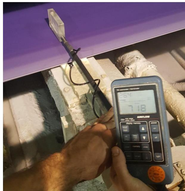
Slika 32. Mjerenje brzine prolaska zraka iznad vakuumske kutije
