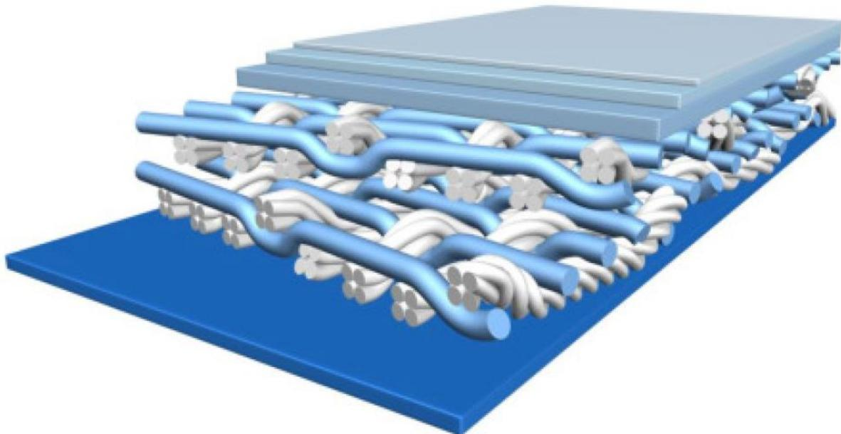
Slika 4. Uvećani prikaz strukture filca [4]
