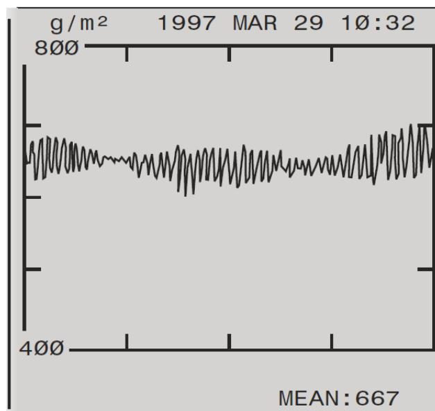
Slika 21. Profil uslijed iskrivljenog valjka[9]
