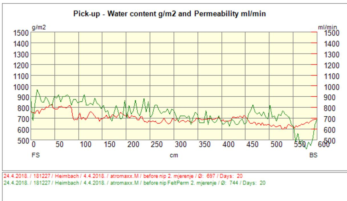
Slika 73. Pick-up ponovljeno, drugo mjerjenje, CD količina vode i propusnost
