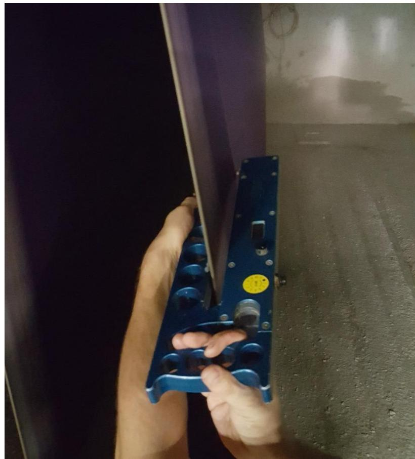
Slika 31. Postupak mjerena debljine filca u pokretu
