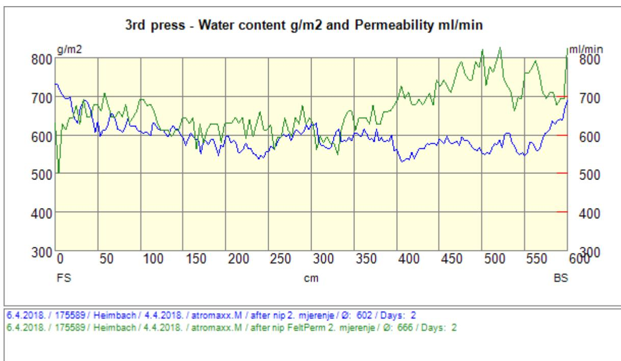
Slika 67. Treći donji filec, drugo mjerjenje, CD količina vode i propusnost
