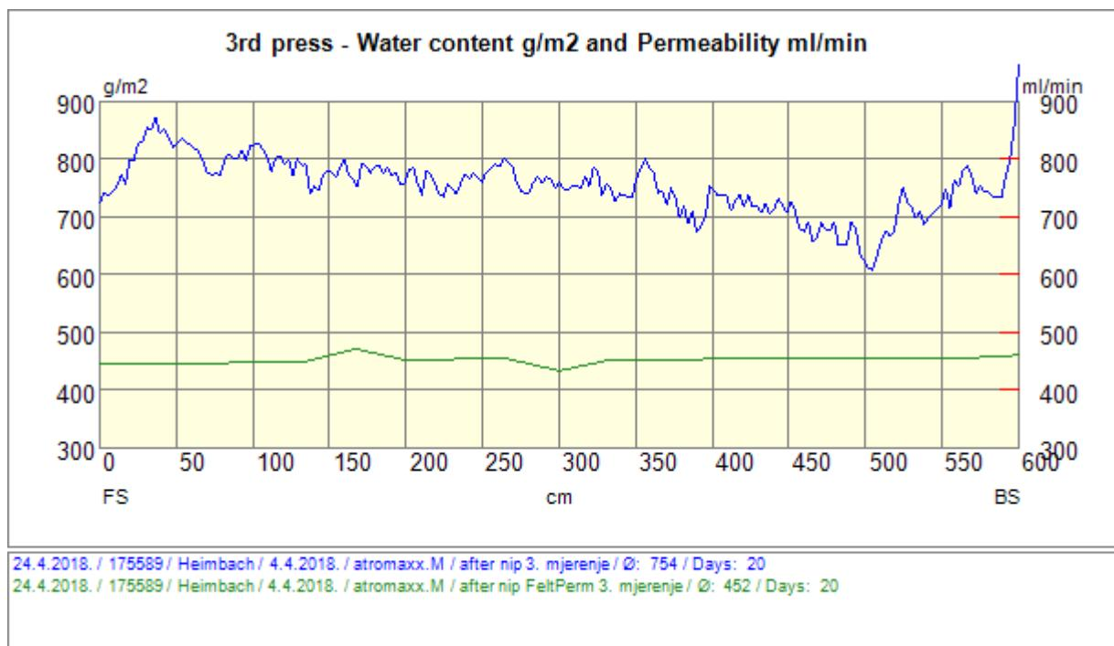
Slika 87. Treći donji filc ponovljeno, treće mjerjenje, CD količina vode i propusnost
