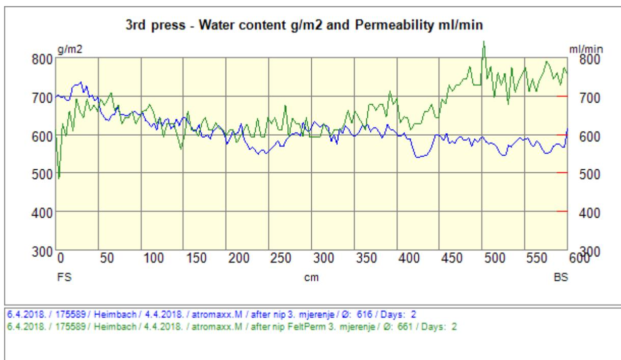
Slika 69. Treći donji filc, treće mjerjenje, CD količina vode i propusnost
