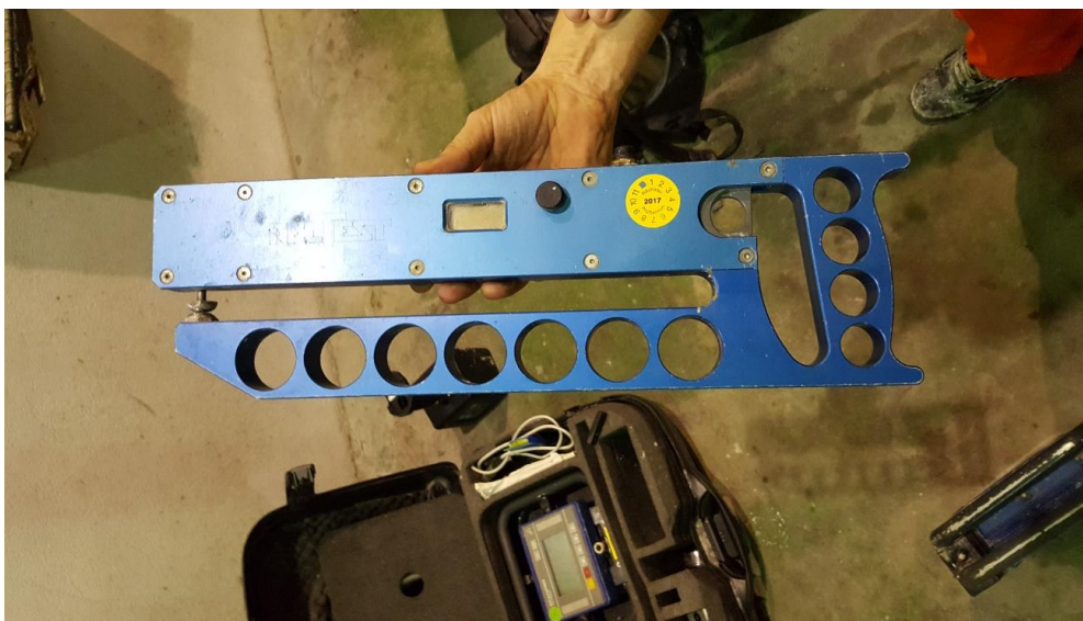
Slika 25. Uređaj za mjerenje debljine filca
