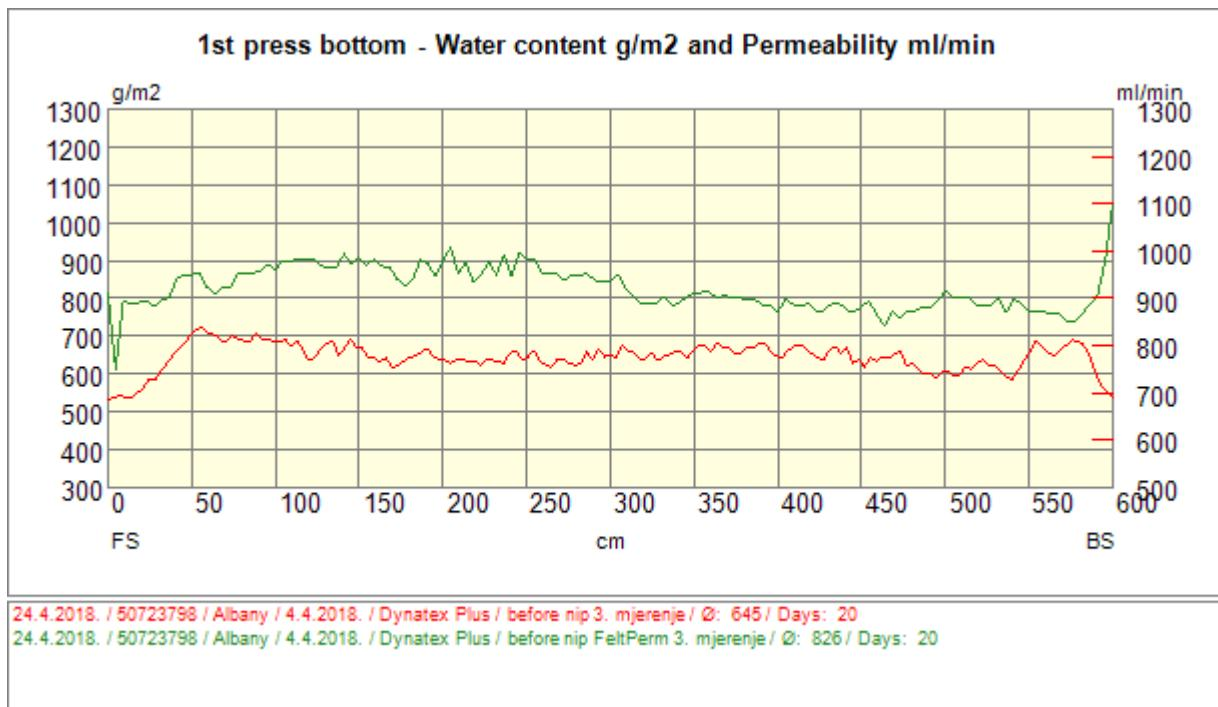
Slika 81. Prvi donji filc ponovljeno, treće mjerjenje, CD količina vode i propusnost
