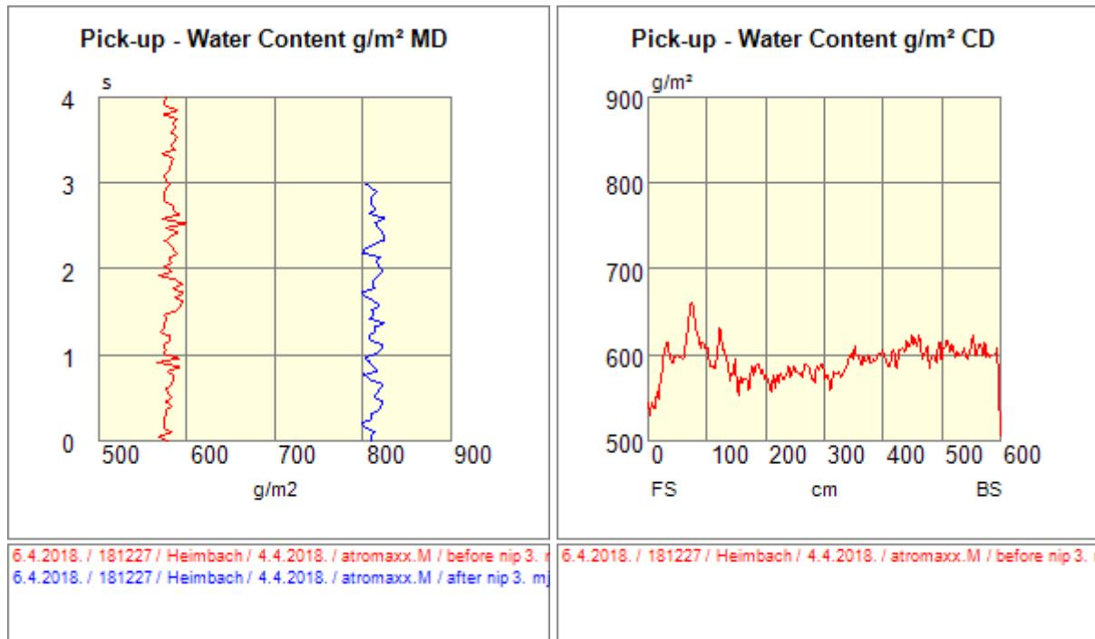
Slika 56. Pick-up, treće mjerjenje, MD i CD količine vode
