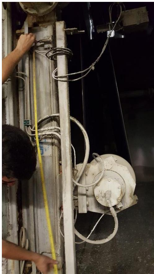
Slika 37. Pozicioniranje za mjerjenje preostalog/iskorištenog hoda napinjača
