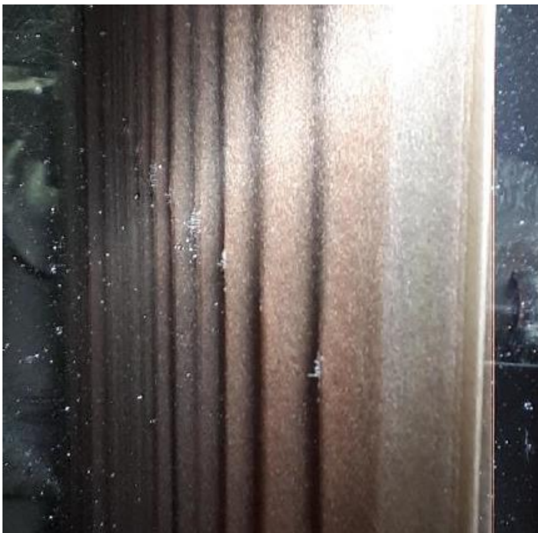
Slika 36. Stražnja strana filca prilikom pranja visokotlačnim špicama
