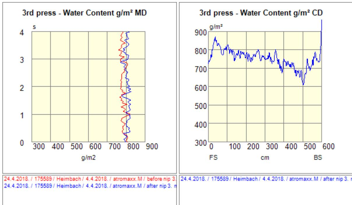
Slika 86. Treći donji filc ponovljeno, treće mjerjenje, MD i CD količina vode
