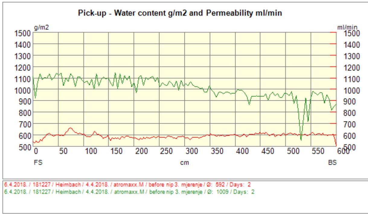
Slika 57. Pick-up, treće mjerjenje, CD količina vode i propusnost
