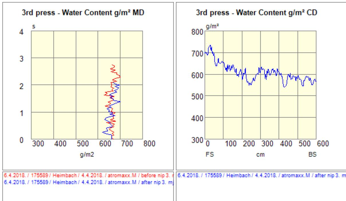
Slika 68. Treći donji filc, treće mjerjenje, MD i CD količina vode
