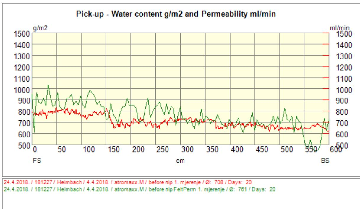
Slika 71. Pick-up ponovljeno, prvo mjerjenje, CD količina vode i propusnost
