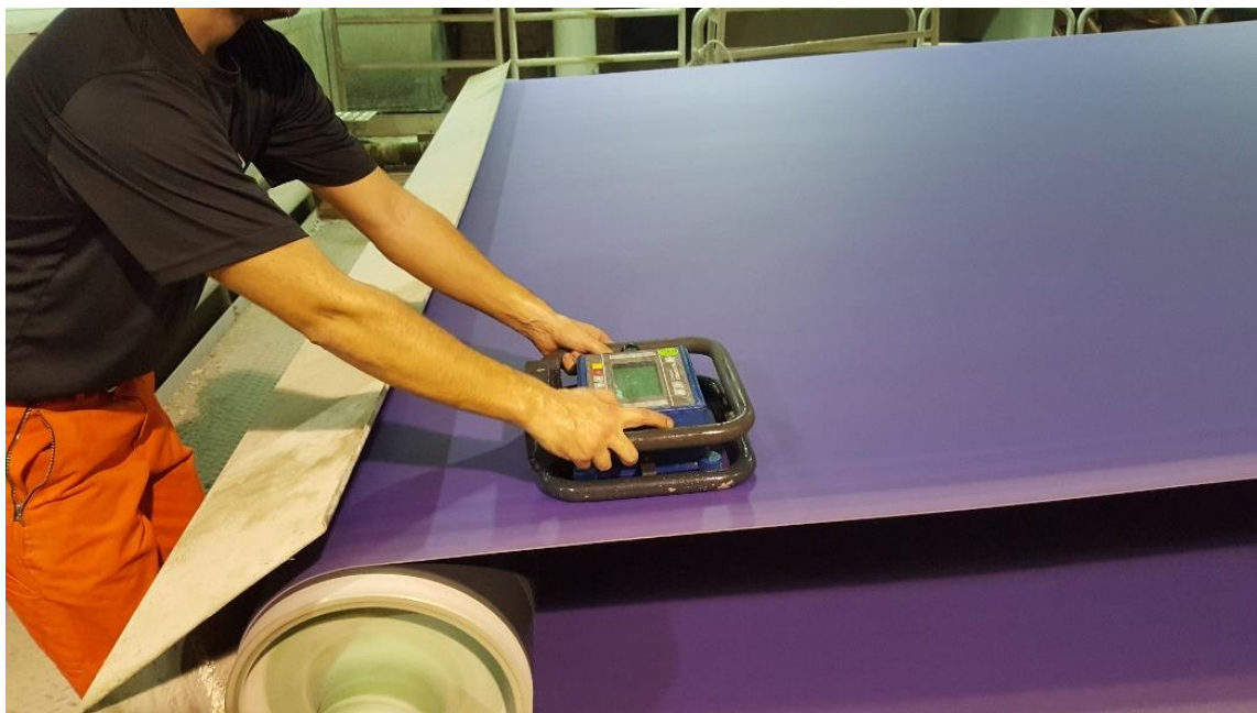
Slika 34. Postavljanje uređaja na filc
