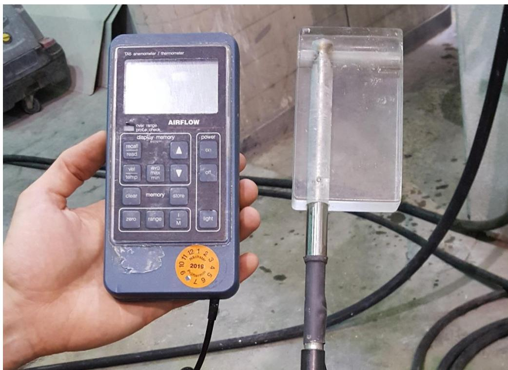
Slika 28. Uređaj za mjerjenje protoka zraka
