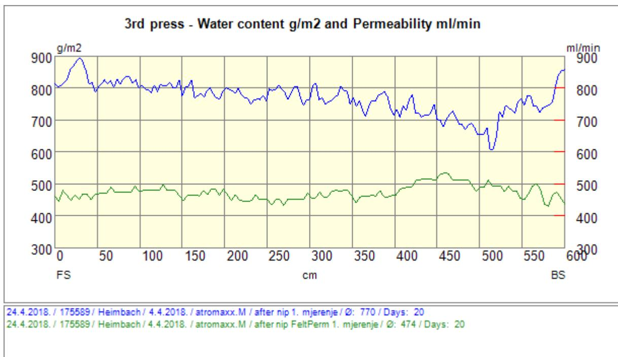
Slika 83. Treći donji filc ponovljeno, prvo mjerjenje, CD količina vode i propusnost
