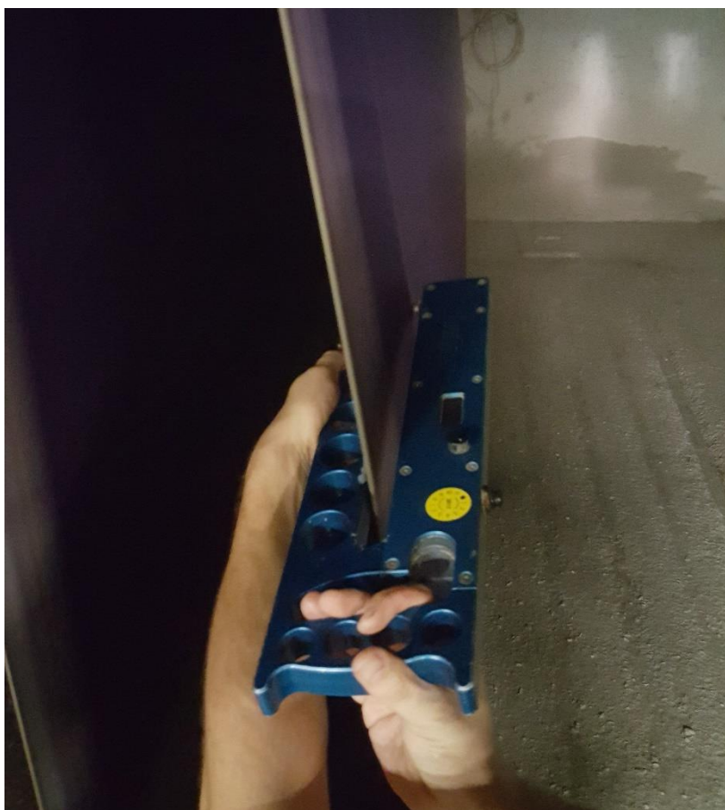
Slika 31. Postupak mjerenja debljine filca u pokretu
