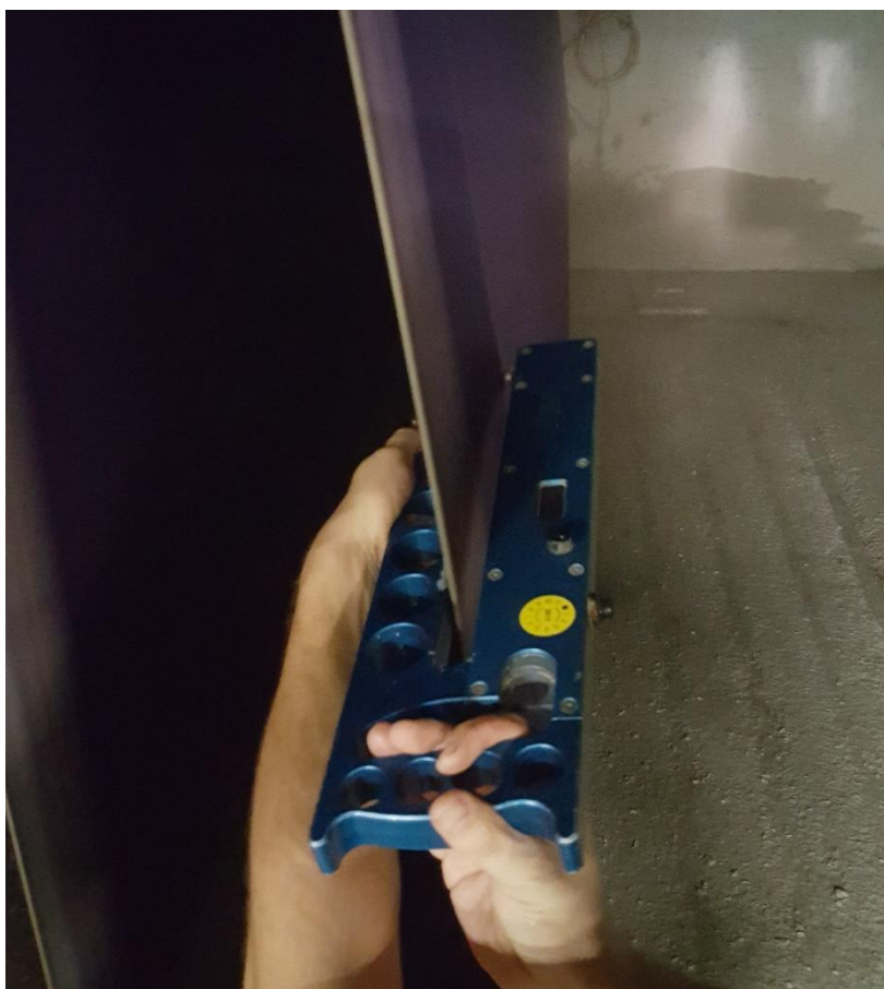
Slika 31. Postupak mjerenja debljine filca u pokretu
