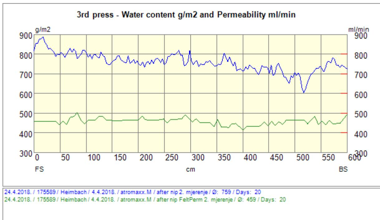
Slika 85. Treći donji filc ponovljeno, drugo mjerjenje, CD količina vode i propusnost
