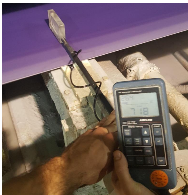
Slika 32. Mjerenje brzine prolaska zraka iznad vakuumske kutije
