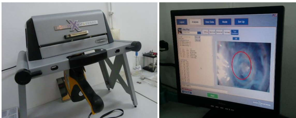
Slika 21. Oprema za utvrđivanje kemijskog sastava uzoraka – Olympus XRF analizator.
