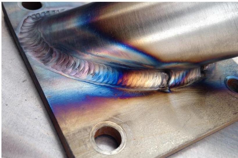
Slika 2. Obojenja površine nastala unosom topline postupkom zavarivanja [16].
