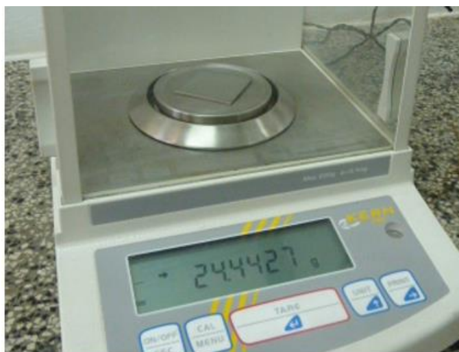
Slika 22. Mjerenje mase uzorka – digitalna vaga Kern ABS.
