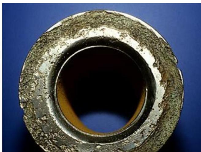
Slika 6. Korozija u procjepu na prirubnici od čelika AISI 316L (EN 1.4404) – cjevovod morske vode [24].
