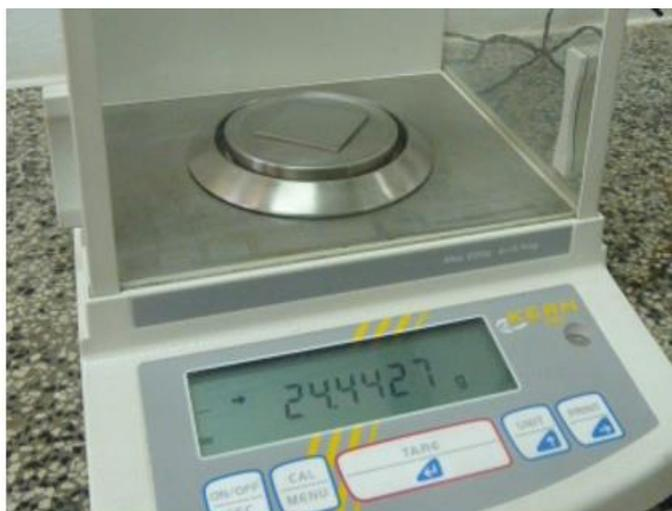
Slika 22. Mjerenje mase uzorka – digitalna vaga Kern ABS.
