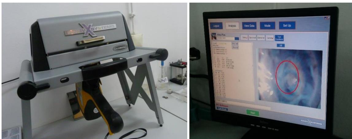
Slika 21. Oprema za utvrđivanje kemijskog sastava uzoraka – Olympus XRF analizator.
