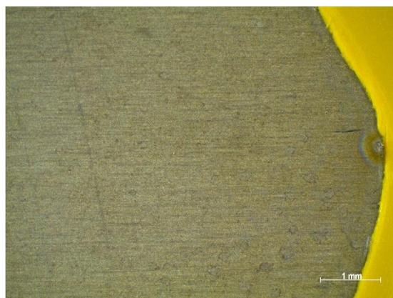
**Slika 35. Detalj površine kemijski obrađenog uzorka otopinom 1 nakon cikličke polarizacije u viski-gaziranoj vodi – vidljivo je nastalo korozijsko oštećenje koje potvrđuje eluciju metalnih iona.**
