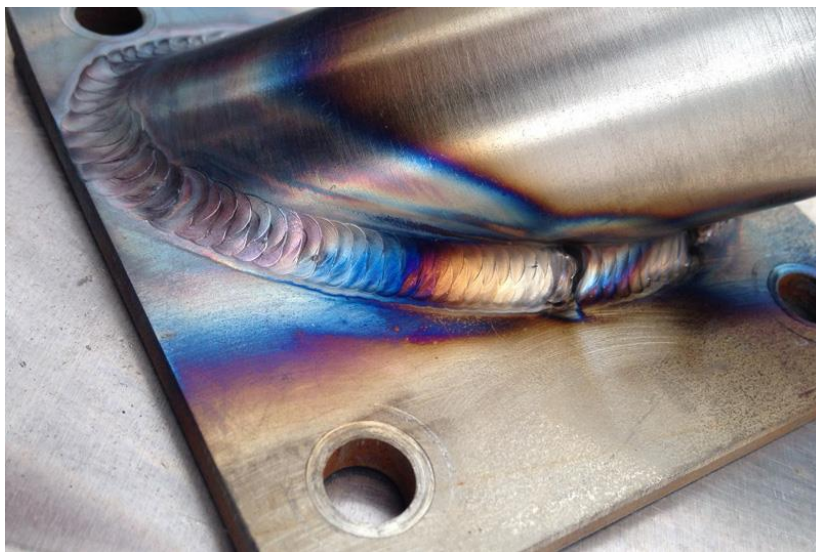
Slika 2. Obojenja površine nastala unosom topline postupkom zavarivanja [16].
