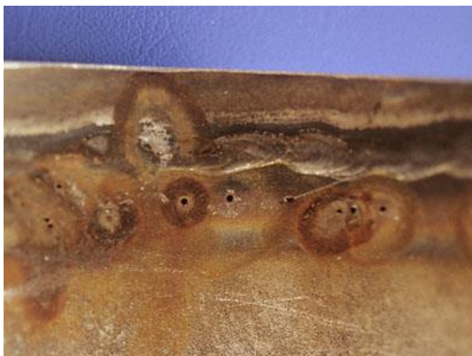
Slika 3. Rupičasta korozija na čeliku AISI 304 (EN 1.4301) uzrokovana neuklonjenim toplinskim obojenjima nastalim zavarivanjem [24].
