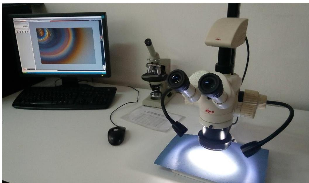
Slika 23. Oprema za ispitivanje površine uzoraka – stereomikroskop Leica MZ6.
