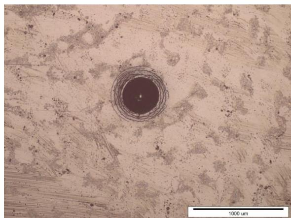
**Slika 22.** Otisak Rockwell-ovog C indentora na uzorku C2 31
