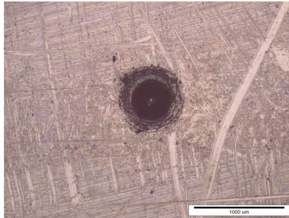
Slika 26. Otisak Rockwell-ovog C indentora na uzorku D2 31
