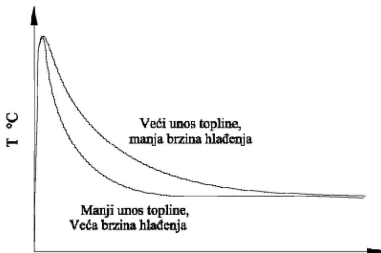
Slika 2.22 Utjecaj unesene topline na brzinu ohlađivanja [14]
