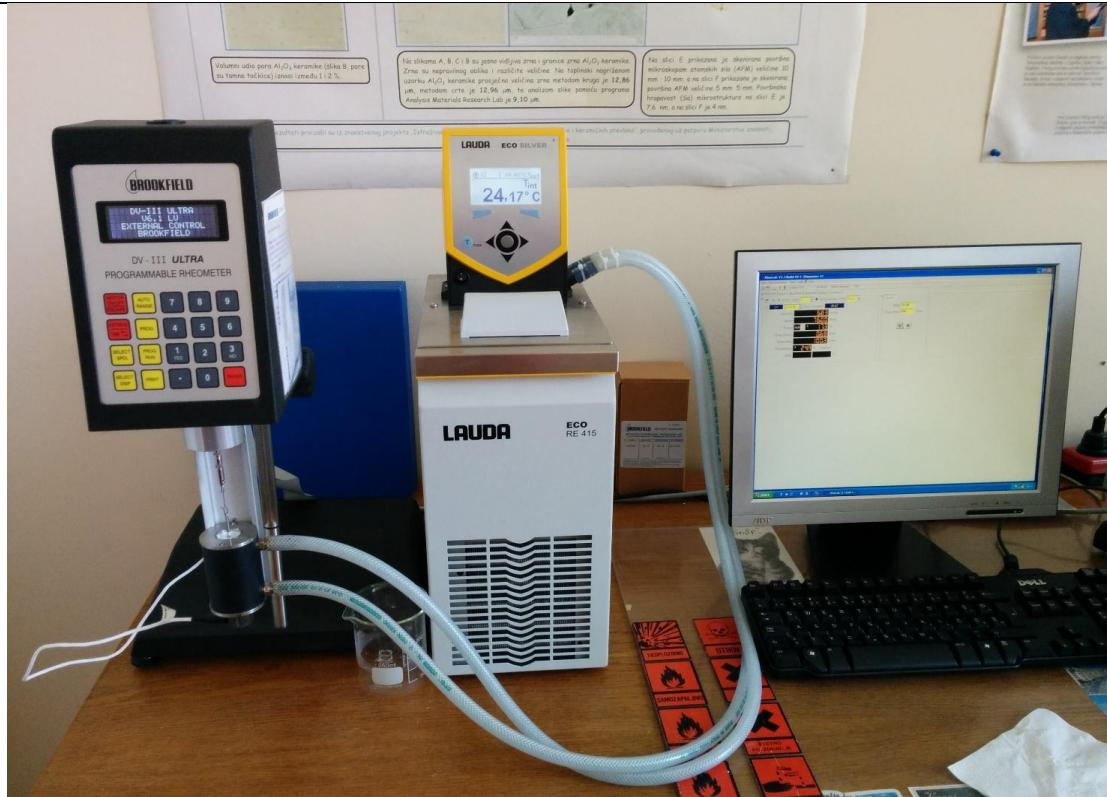
Slika 20. Rotacijski viskozimetar Brookfield DV-III Ultra [9]
