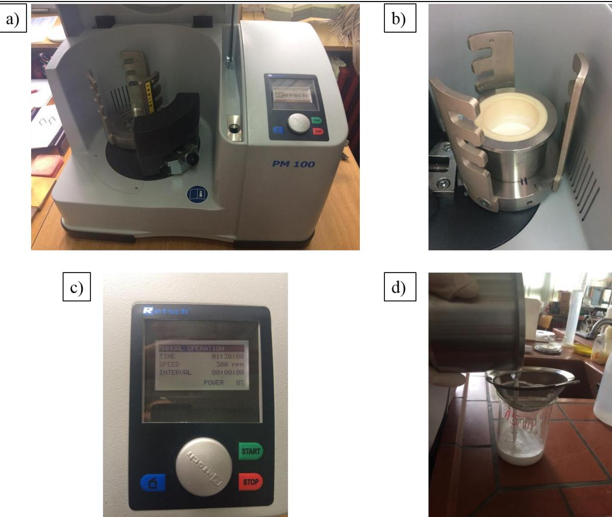
Slika 18. Homogenizacija suspenzija: (a) planetarni kuglični mlin Retsch PM 100; (b) unutrašnjost mlinova s posudom za homogenizaciju; (C) sučelje mlinova; (D) filtracija suspenzije
