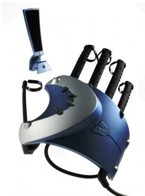
Slika 22. Rukavica P5 data glove [21]
