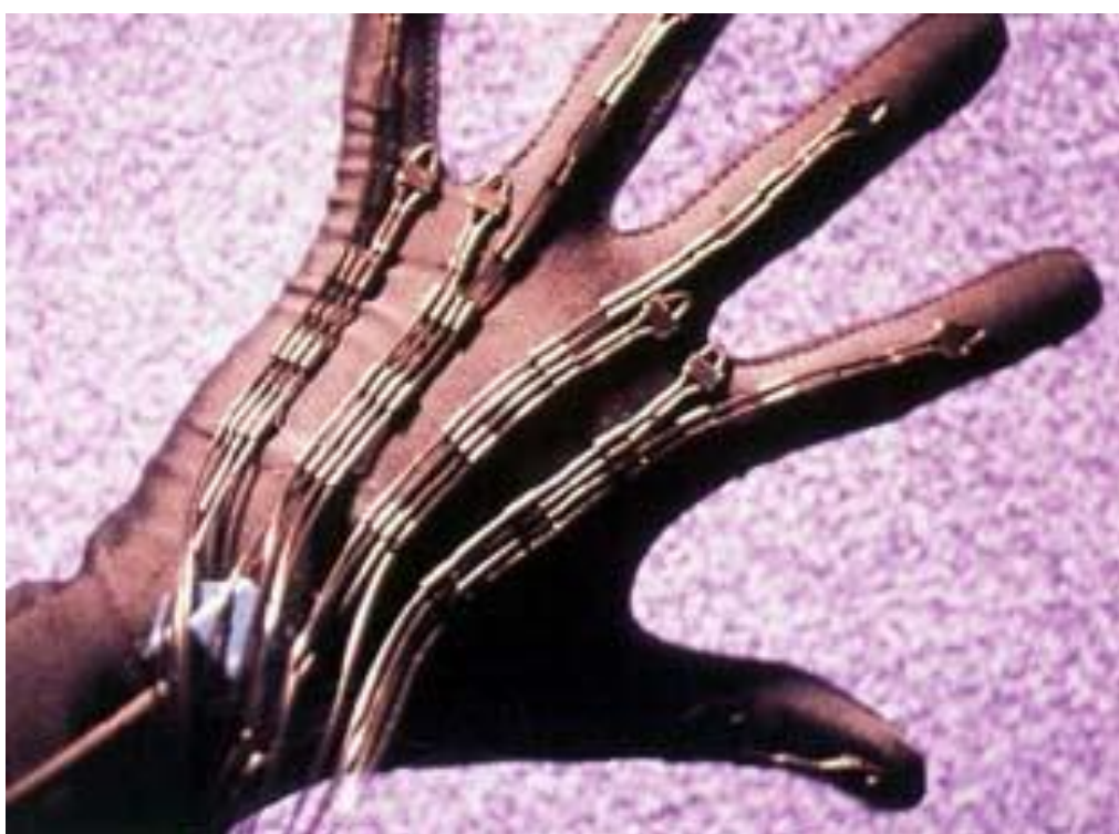
Slika 15. Zimmermanova podatkovna rukavica – The data glove [20]
