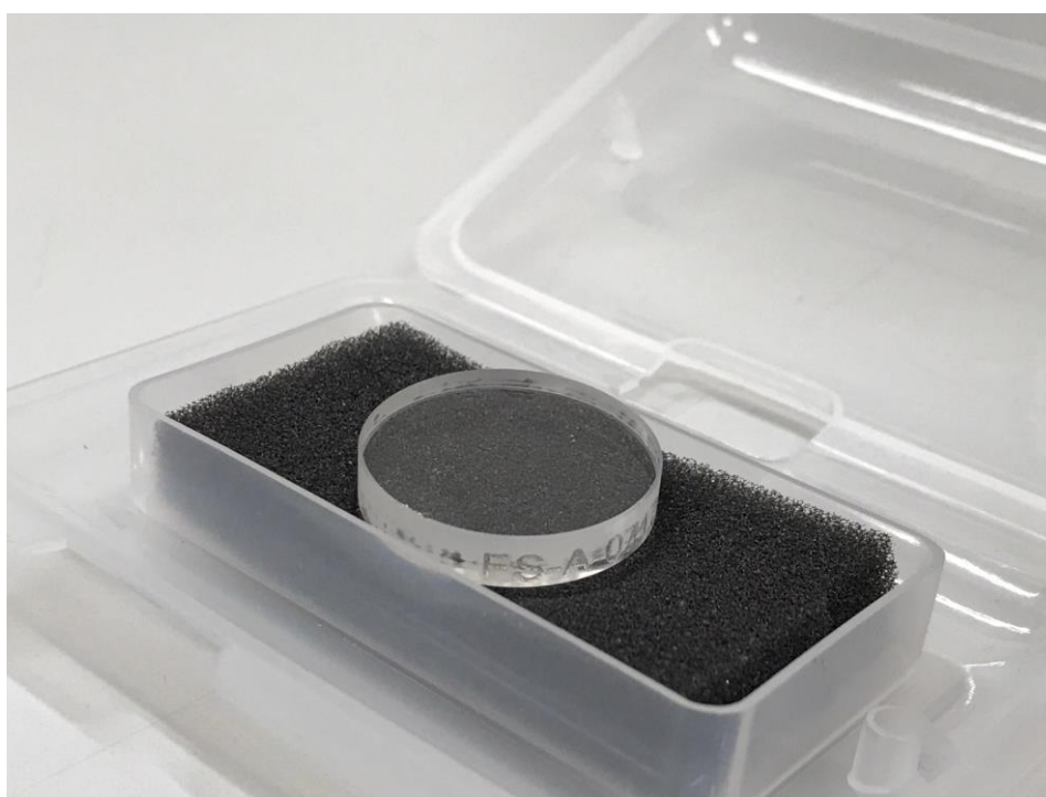
Slika 18. Referentna pločica tvrdoće; fused silica
