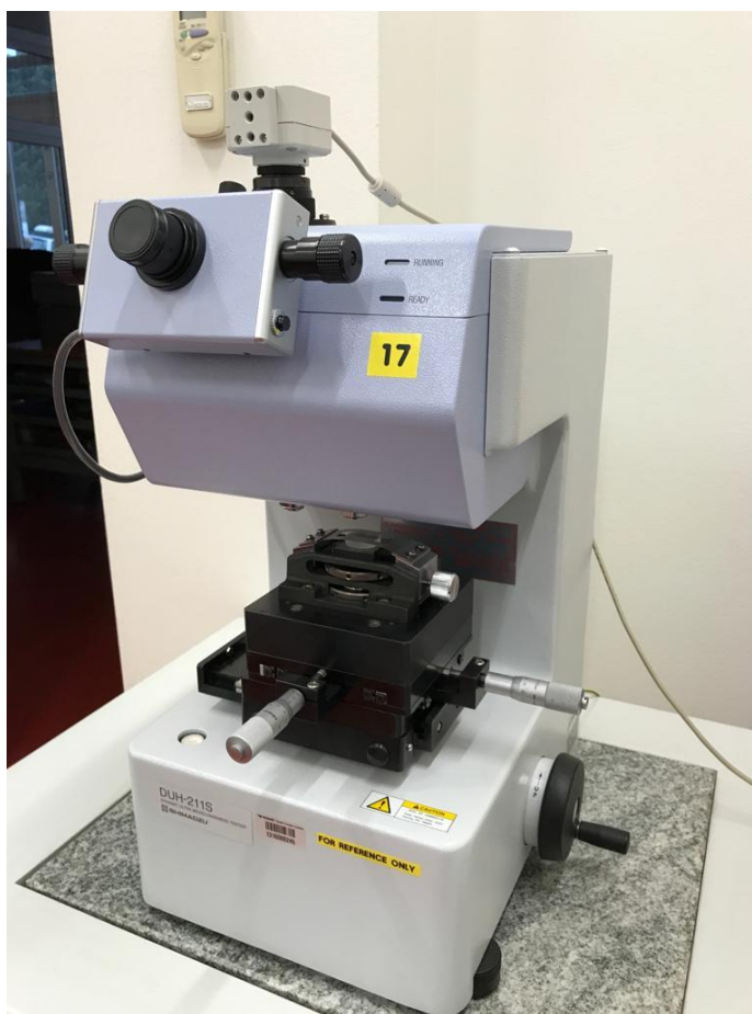
Slika 17. DUH uređaj za ispitivanje nanoindentacije
