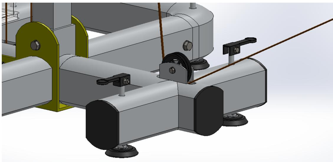
**Slika 50 Detalj prikaza sklopa vanjskog kućišta kolotura**
