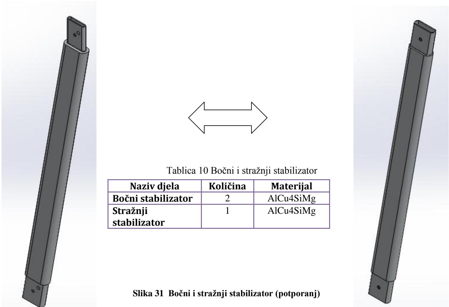
**Slika 31 Bočni i stražnji stabilizator (potporanj)**
