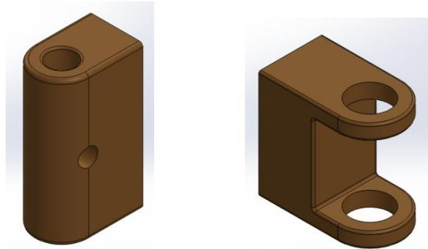
**Slika 42 Čahura užeta u čahura kućišta kolotura**
