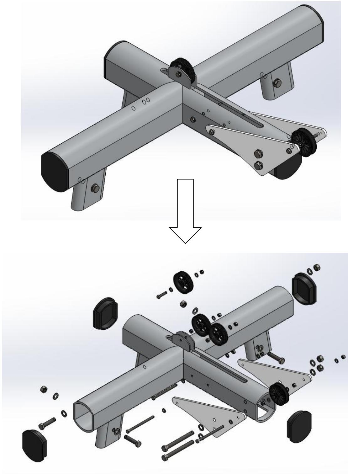
Slika 29 Sklop gornjeg kućišta i njegovi dijelovi
