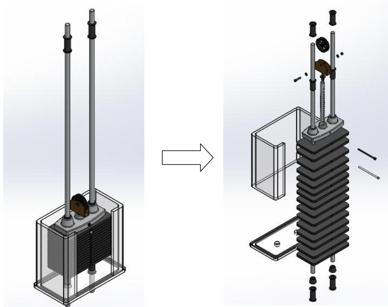
Slika 28 Sklop središnjeg kućišta i njegovi dijelovi
