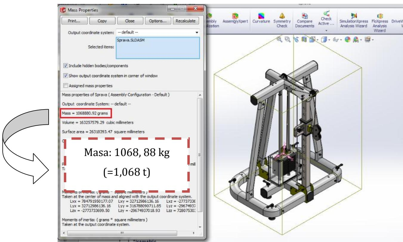
Slika 36 Ukupna masa sprave (nosivi dijelovi od čelika)
