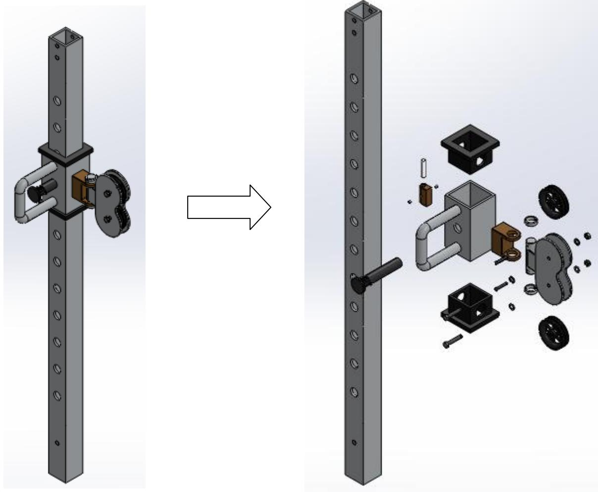
Slika 27 Sklop klizača i njegovi dijelovi
