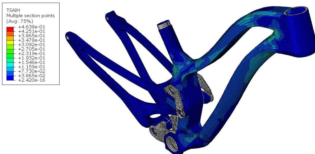
Slika 35. Rezultati Tsai-Hill kriterija popuštanja za prvi sloj [45°] kompozitne konstrukcije
