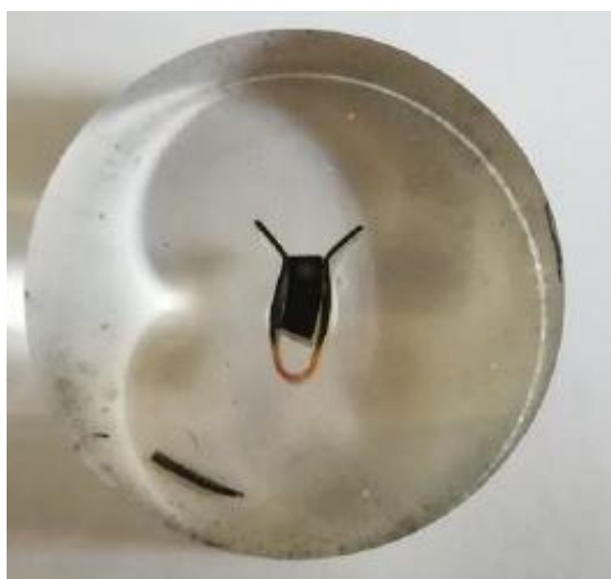
Sl. 60 Metalografski pripremljen ispitni uzorka za određivanje efektivne dubine nitriranja
