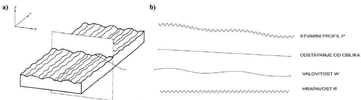
Sl. 33 Određivanje [11] : a) profila površine, b) odstupanja profila
