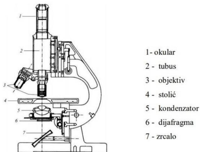
Sl. 39 Osnovni dijelovi svjetlosnog mikroskopa [ 21]
