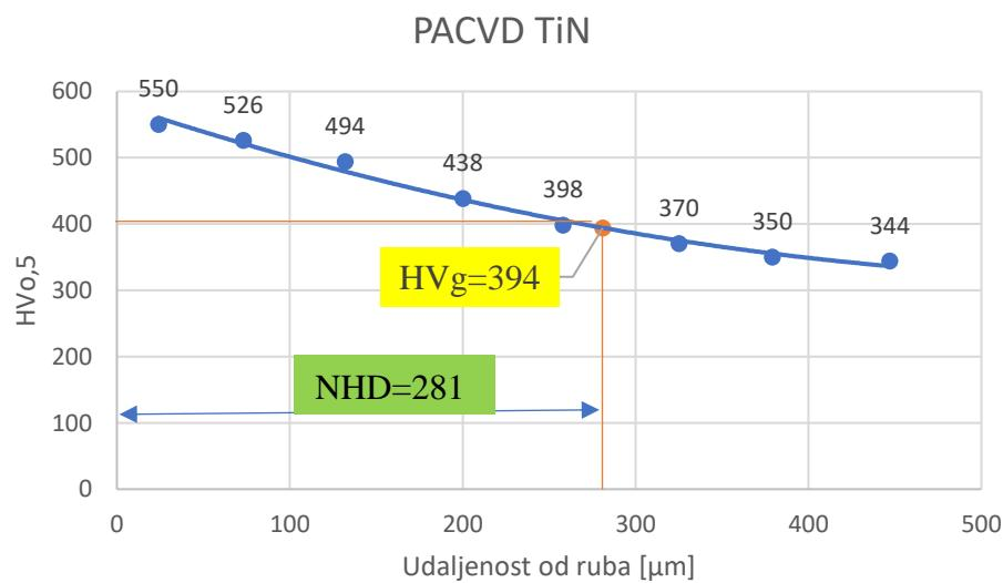
Sl. 63 Raspored mikrotvrdoće u površinskom sloju uzorka prevučenih prevlakom TiN PACVD TiN
