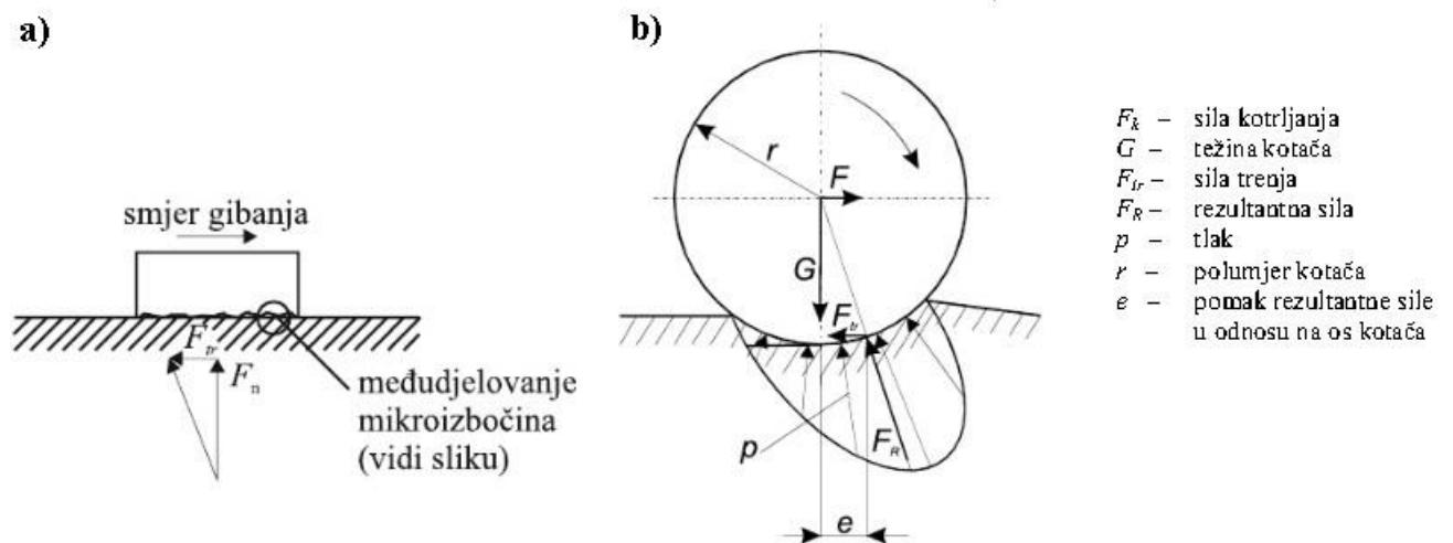
Sl. 5 Trenje a) klizanja, b) kotrljanja [3]
