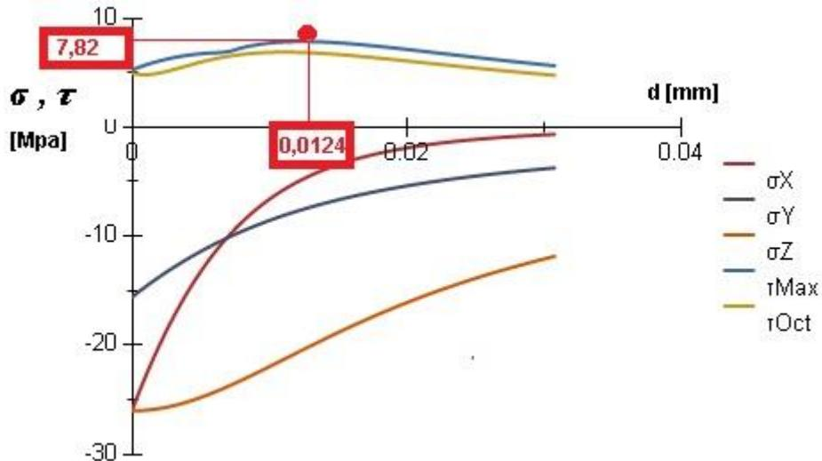
Sl. 25 Raspored naprezanja obzirom na udaljenost od površine
