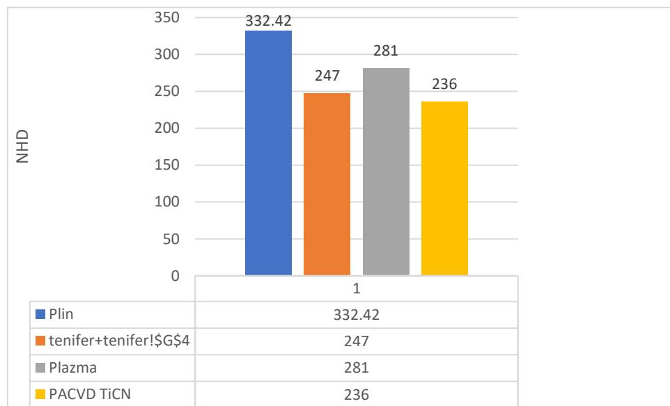
**Sl. 66 Efektivne dubine nitriranja za uzorke s tretiranim površinom**
