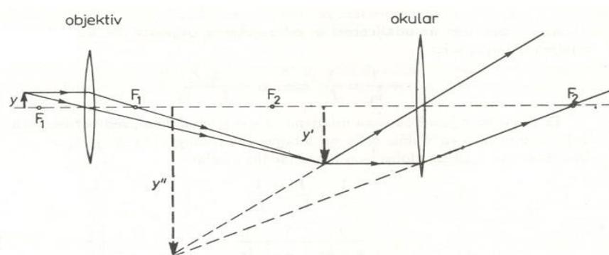
Sl. 40 Princip rada svjetlosnog mikroskopa [ ]
