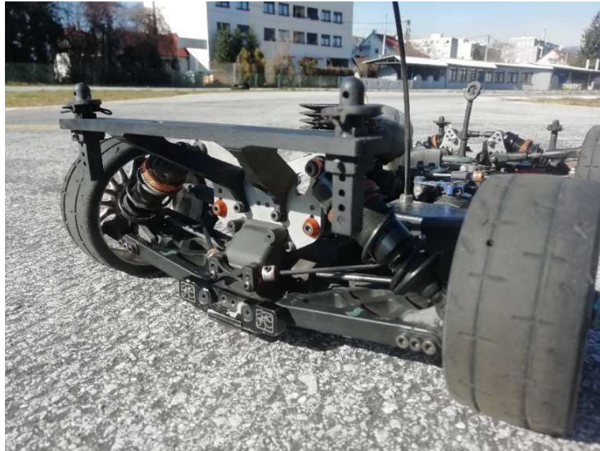
Slika 35. Stražnji nosač karoserije na GT modelu
