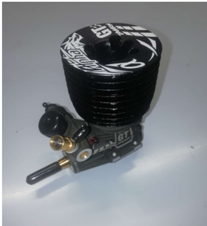
Slika 2. Primjer nitro motora s unutrašnjim izgaranjem. Prikazan motor je za klasu 1:8 GT, proizvođača Alpha
