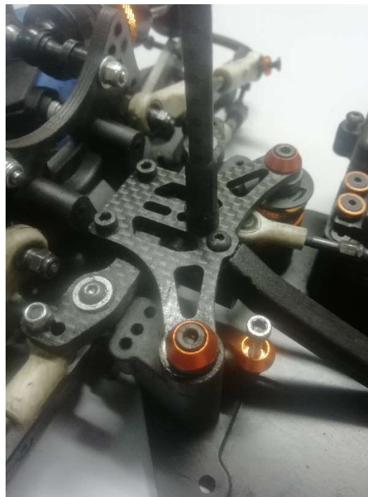
Slika 50. Ugrađena Ackermann geometrija na GT model
