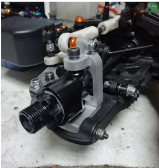
Slika 66. Instaliran novi 0° nosač glavčine na GT modelu
