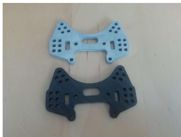
Slika 76. Prednji nosači amortizera, od AlMg3 aluminijiske legure i ugljičnih vlakana
