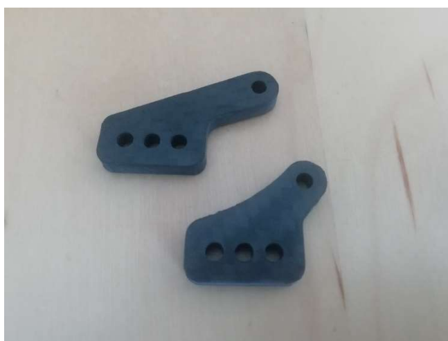
Slika 80. Prednji i stražnji donji prihvat amortizera
