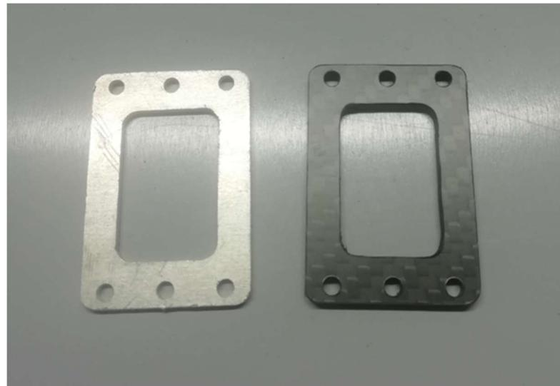
**Slika 70. Izradene gornje pločice za montiranje centrifugalne spojke, iz AlMg3 aluminijiske legure i ugljičnih vlakana**
