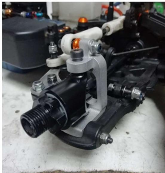
**Slika 66. Instaliran novi  $0^\circ$  nosač glavčine na GT modelu**
