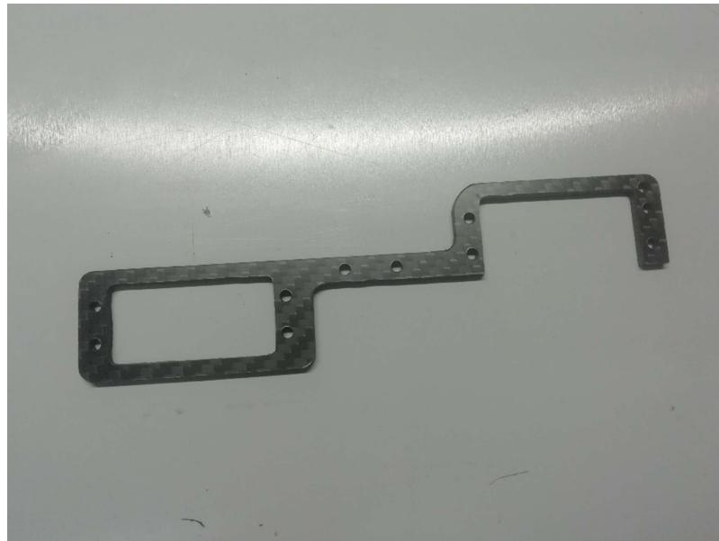
Slika 85. Servo ploča izrađena iz ugljičnih vlakana
