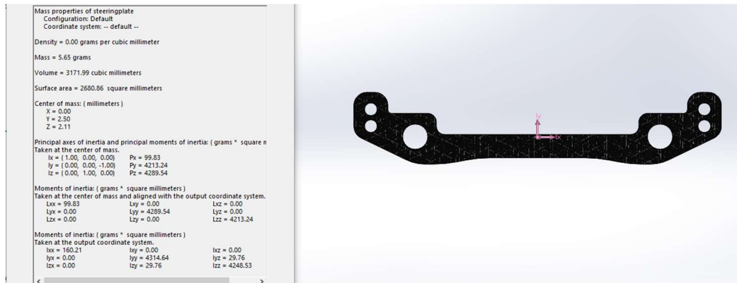
Slika 49. Masa pozicije izrađene iz ugljičnih vlakana
