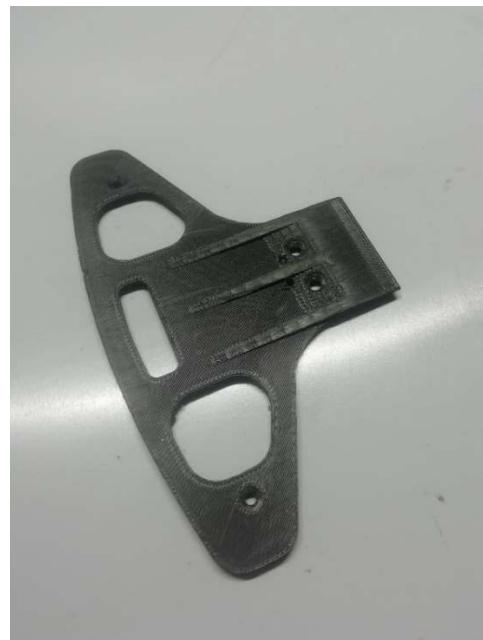
**Slika 27. Izrađen 3D printani donji nosač spužvastog odbojnika**
