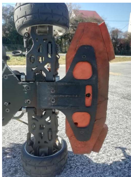
Slika 28. Prednji branik postavljen na GT modelu
