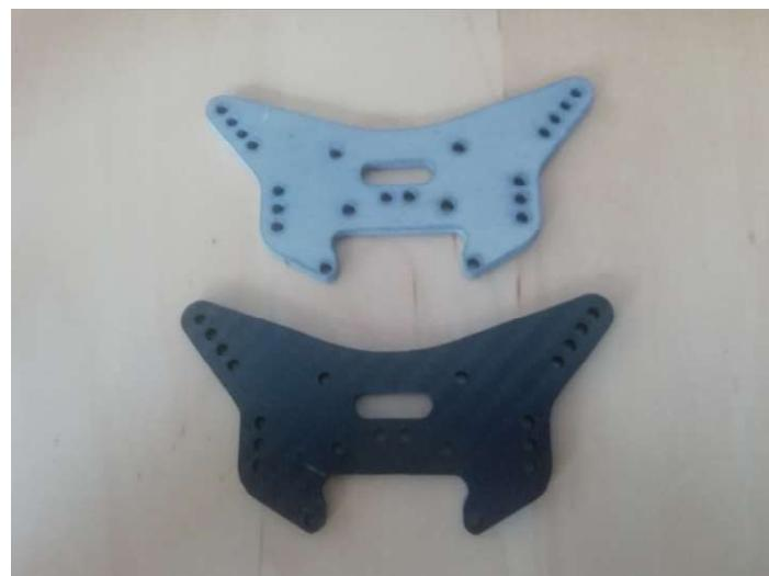
Slika 77. Stražnji nosači amortizera, od AlMg3 aluminijiske legure i ugljičnih vlakana
