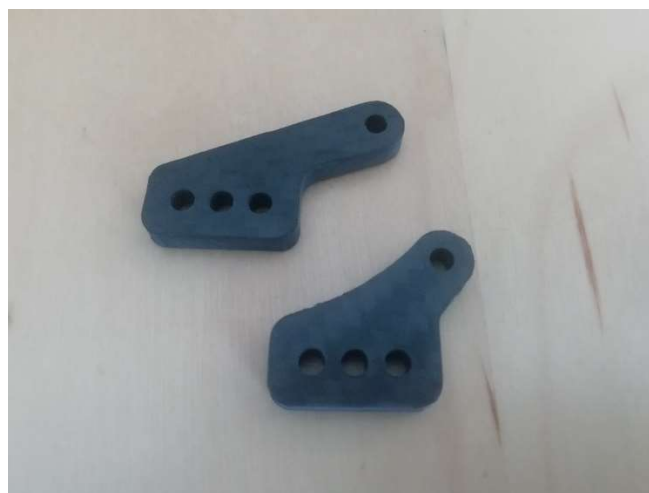
Slika 80. Prednji i stražnji donji prihvat amortizera
