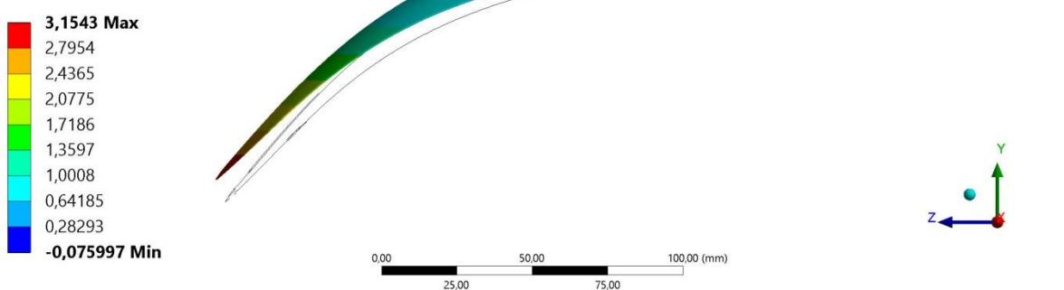
**Slika 54.** Grafički prikaz raspodijele pomaka krila u smjeru z-osi po površini krila
