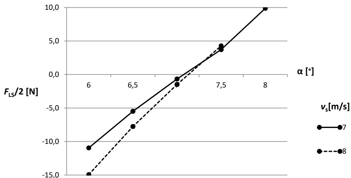
**Slika 75.** Dijagramski prikaz rezultata sile uzgona na polumodelu stražnjeg krila u ovisnosti o parametru  $\alpha$  pri  $v_s = 7 \text{ m/s}$  i  $v_s = 8 \text{ m/s}$ ,  $\Delta l_F = 0$
