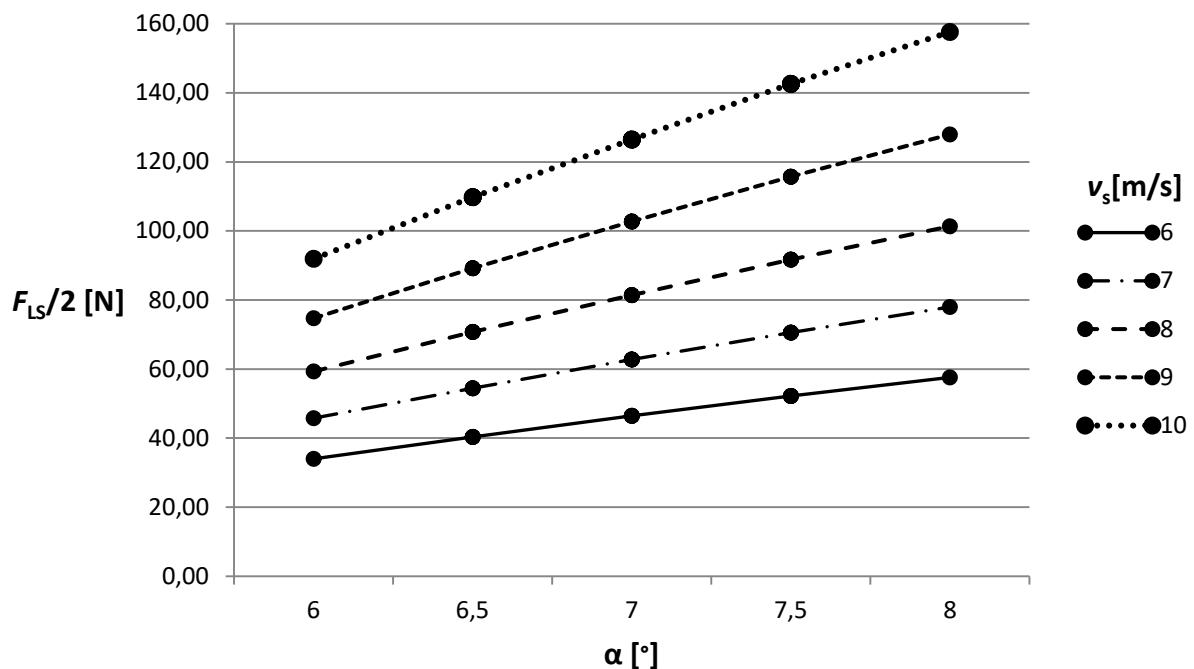
**Slika 58.** Dijagramske prikaze sile uzgona na izdvojenom stražnjem krilu  $F_{LS}/2$  za različite upadne kuteve i brzine nastrujavanja fluida
