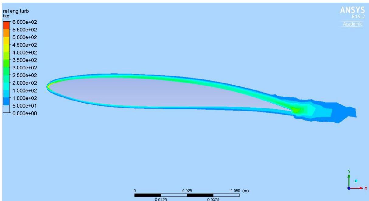
Slika 47. Polje bezdimenzijskog koeficijenta kinetičke energije turbulentacija  $C_{TKE} = k/k_{ulaz}$ ,  $\alpha = 6^\circ$ ,  $v_s = 10$  m/s, ravnina  $z = 0$
