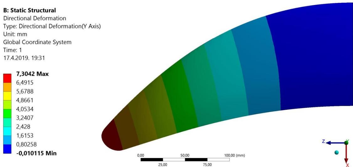
**Slika 53.** Grafički prikaz raspodijele pomaka krila u smjeru y-osi po površini krila
