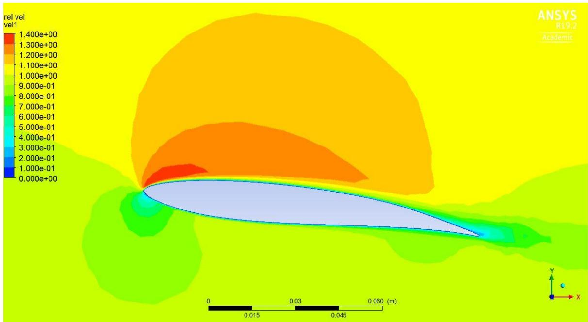
Slika 44. Polje bezdimenzijskog koeficijenta brzine  $C_d = v/v_s$ ,  $\alpha = 8^\circ$ ,  $v_s = 6 \text{ m/s}$ , ravnina  $z = 0$
