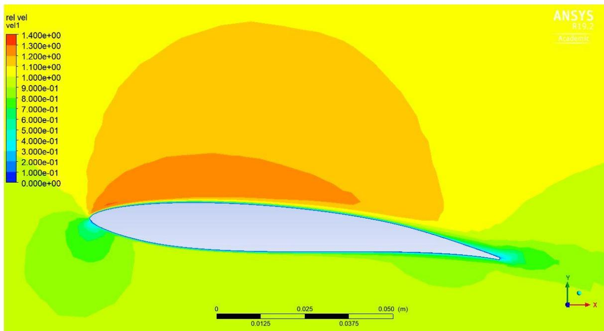
Slika 42. Polje bezdimenzijskog koeficijenta brzine  $C_v = v/v_s$ ,  $\alpha = 6^\circ$ ,  $v_s = 10 \text{ m/s}$ , ravnina  $z = 0$
