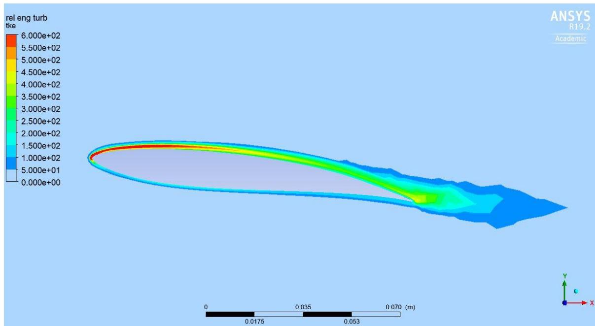
**Slika 48.** Polje bezdimenzijskog koeficijenta kinetičke energije turbulentacija  $C_{TKE} = k/k_{ulaz}$ ,  $\alpha = 8^\circ$ ,  $v_s = 10 \text{ m/s}$ , ravnina  $z = 0$
