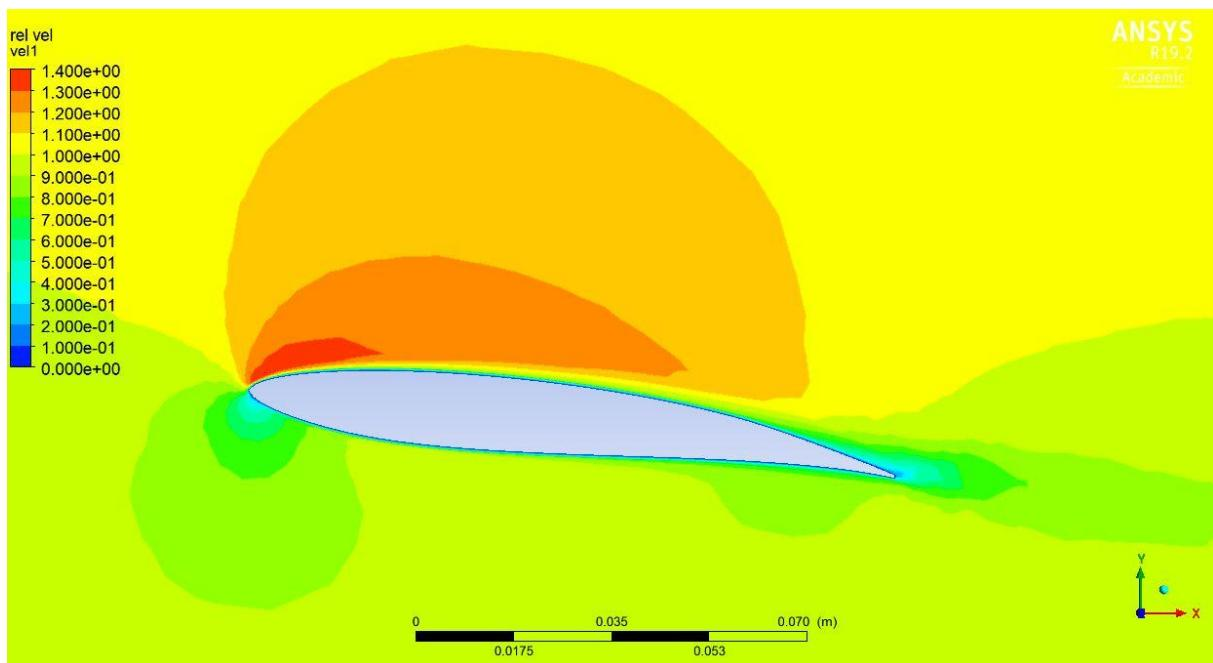
Slika 43. Polje bezdimenzijskog koeficijenta brzine  $C_v = v/v_s$ ,  $\alpha = 8^\circ$ ,  $v_s = 10 \text{ m/s}$ , ravnina  $z = 0$
