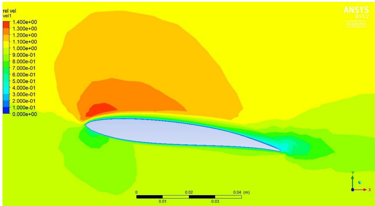
**Slika 40.** Polje bezdimenzijskog koeficijenta brzine  $C_v = v/v_s$ ,  $\alpha = 8^\circ$ ,  $v_s = 10 \text{ m/s}$ , ravnina  $z = 0,75 w$
