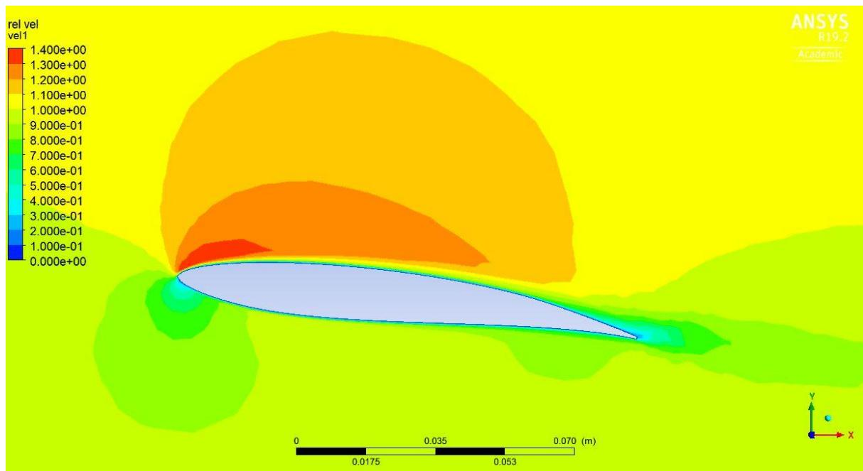
**Slika 41.** Polje bezdimenzijskog koeficijenta brzine  $C_v = v/v_s$ ,  $\alpha = 8^\circ$ ,  $v_s = 10 \text{ m/s}$ , ravnina  $z = 0$
