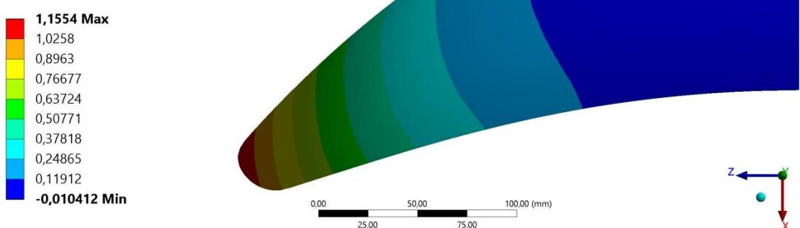
**Slika 55.** Grafički prikaz rasodijele pomaka krila u smjeru x-osi po površini krila
