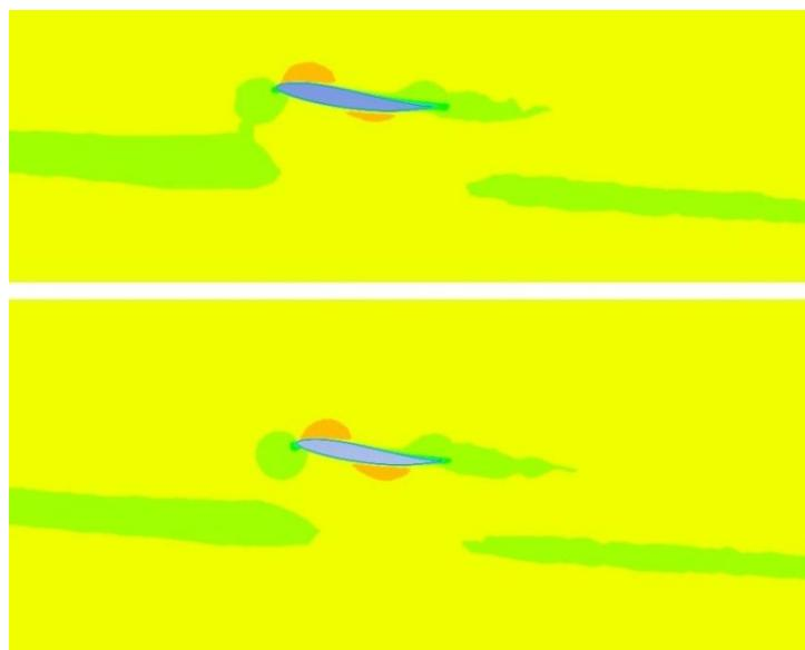
**Slika 74.** Usporedni ravninski prikaz  $z = 0$  polja brzine oko stražnjeg krila za  $\Delta l_F = +0,1\text{m}$  (gore) i  $\Delta l_F = -0,1\text{m}$  (dolje),  $\alpha = 7^\circ$ ,  $v_s = 7 \text{ m/s}$
