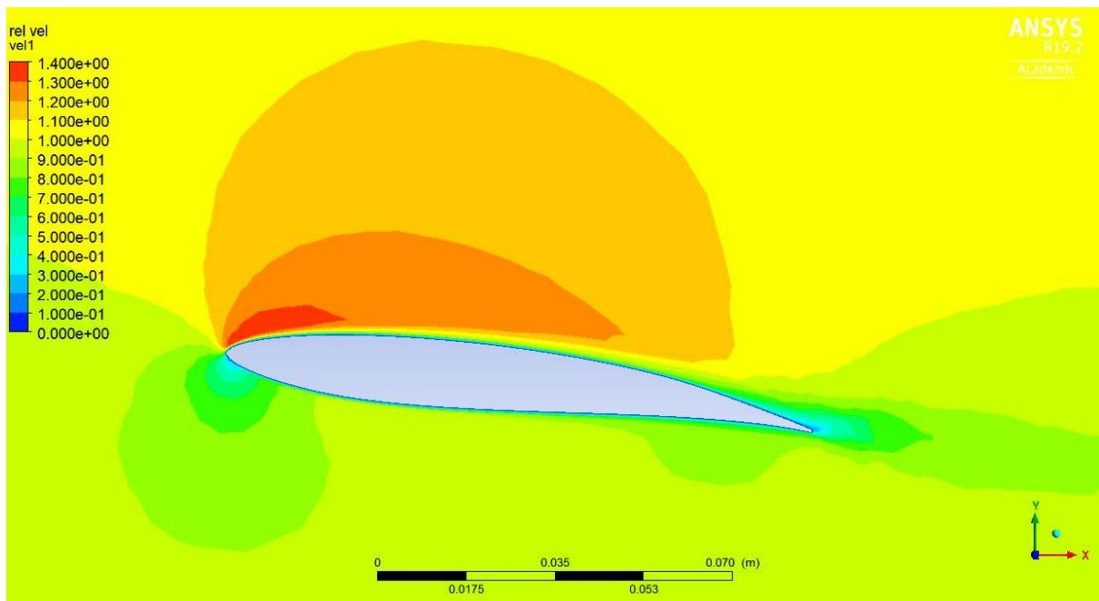
Slika 45. Polje bezdimenzijskog koeficijenta brzine  $C_d = v/v_s$ ,  $\alpha = 8^\circ$ ,  $v_s = 10 \text{ m/s}$ , ravnina  $z = 0$
