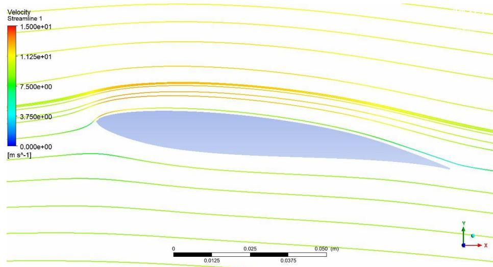
**Slika 33.** Strujnice  $\alpha = 8^\circ$ ,  $v_s = 10 \text{ m/s}$ , ravnina  $z = 0$
