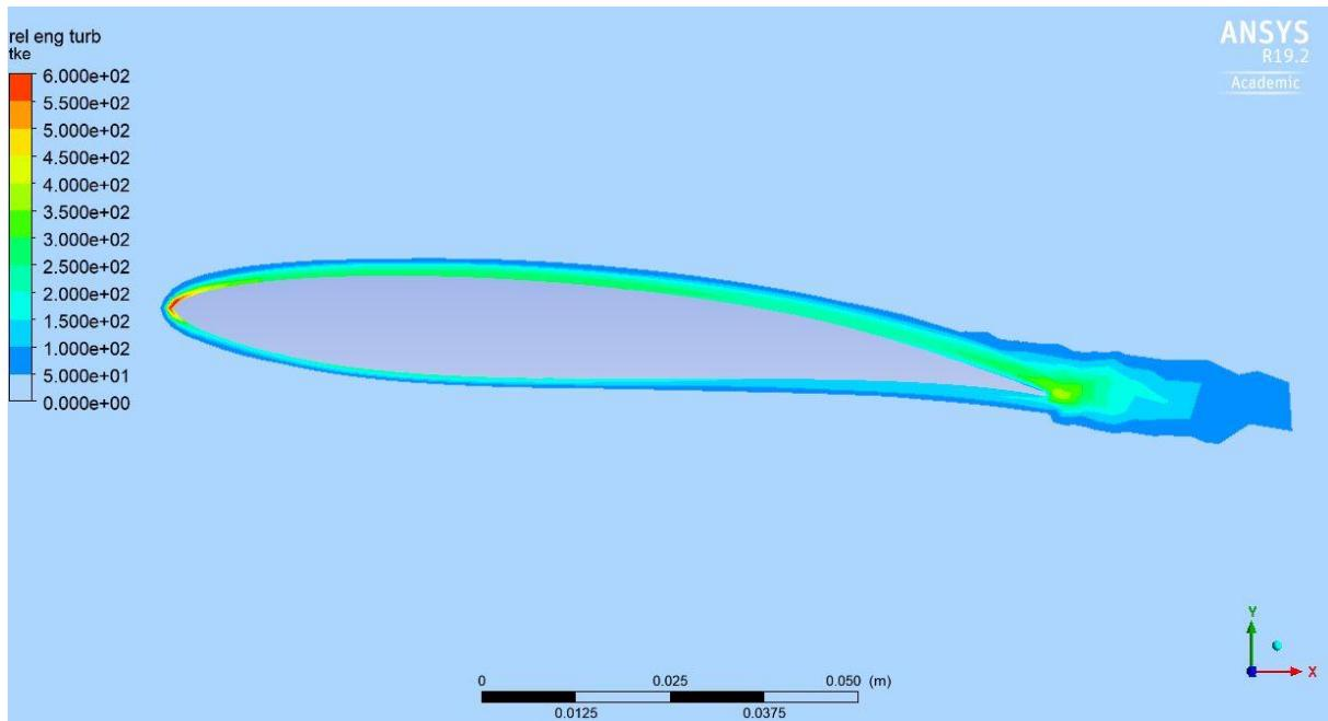
Slika 46. Polje bezdimenzijskog koeficijenta kinetičke energije turbulentacija  $C_{TKE} = k/k_{ulaz}$ ,  $\alpha = 6^\circ$ ,  $v_s = 6$  m/s, ravnina  $z = 0$
