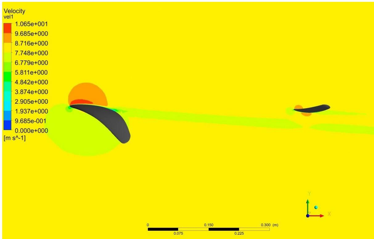
**Slika 72.** Ravninski prikaz  $z = 0$  polja brzine pri strujanju oko oba krila,  $\alpha = 6.5^\circ$ ,  $v_s = 8 \text{ m/s}$
