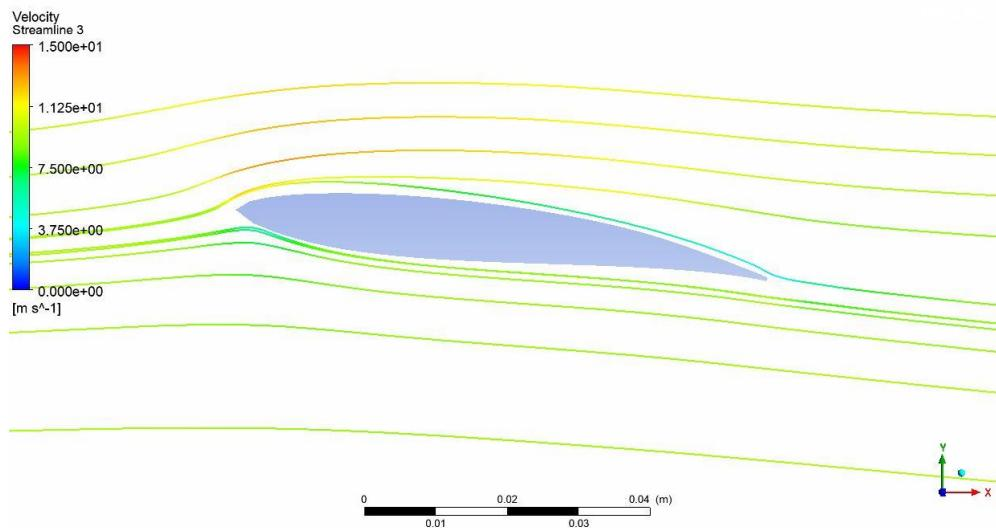
Slika 35. Strujnice  $\alpha = 8^\circ$ ,  $v_s=10 \text{ m/s}$ , ravnina  $z = 0,75w$
