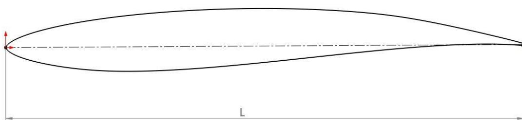
Slika 25. Poprečni presjek prednjeg krila u vertikalnoj ravnini simetrije
