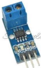
Slika 40. Senzor struje
