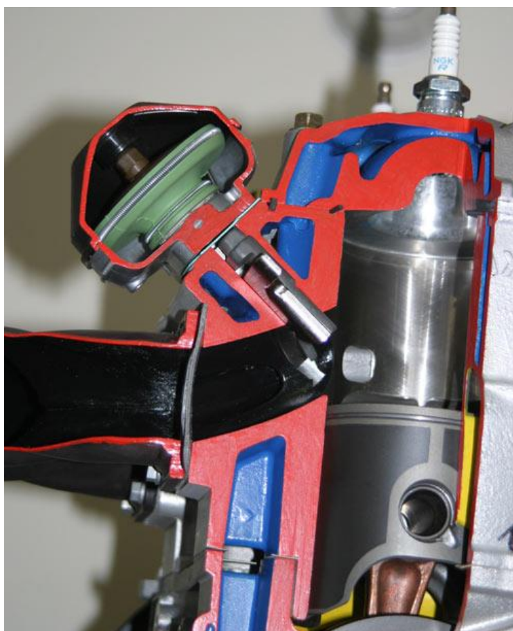
Slika 4. ROTAX R.A.V.E sistem s ispušnim ventilom [6]
