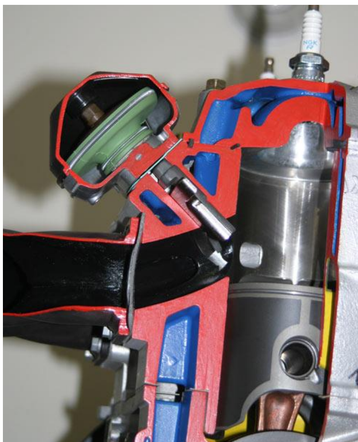
Slika 4. ROTAX R.A.V.E sistem s ispušnim ventilom [6]
