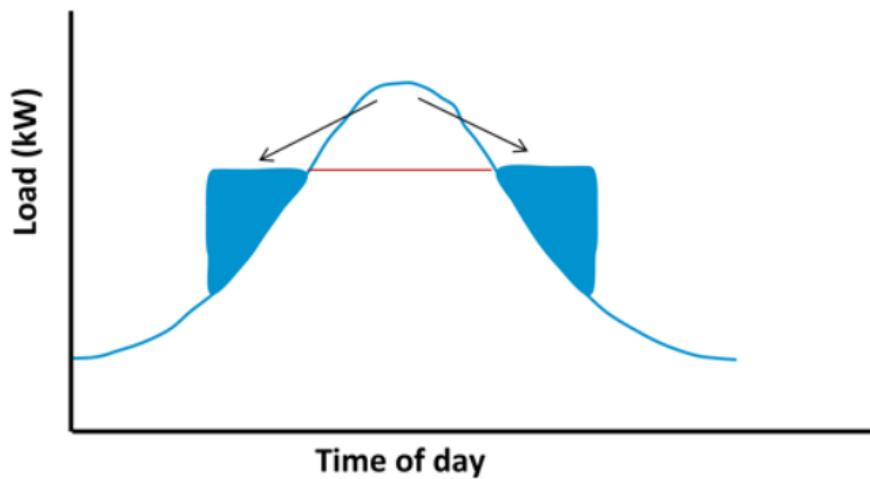
Slika 27. Prebacivanje opterećenja (engl. *Load shifting*) [18]
