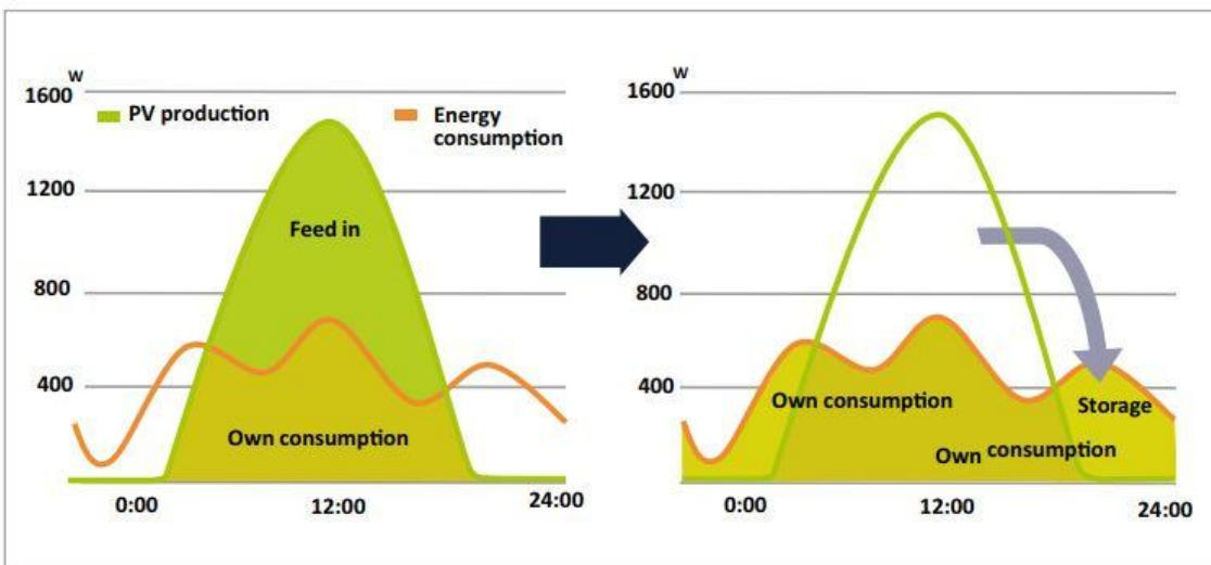
Slika 49. Pohranjivanje viška proizvedene električne energije u baterije [24]
