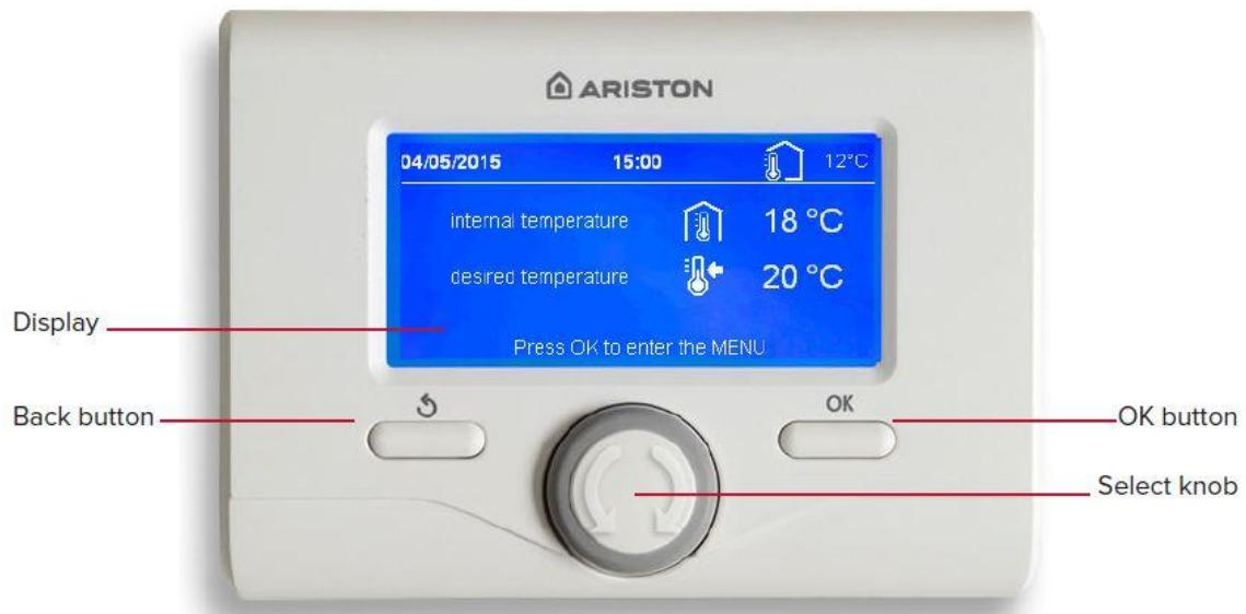
Slika 20. Izgled Sensys upravljačkog uređaja [19]
