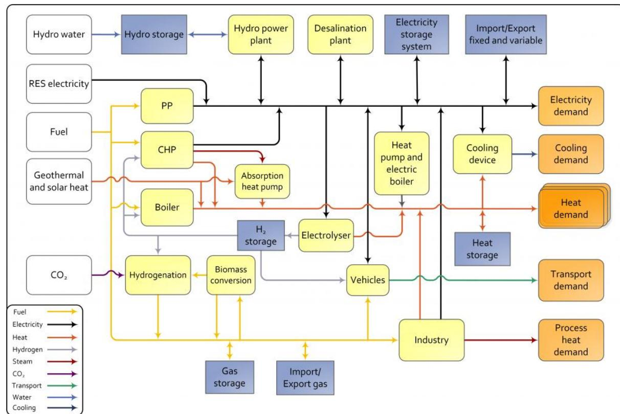
Slika 9. Dijagram toka modeliranja u softveru *EnergyPLAN* [15]
