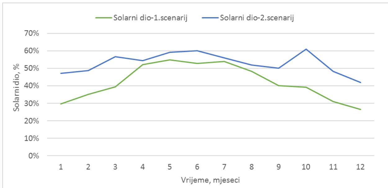
**Slika 46. Solarni dio za 1. i 2. scenarij**
