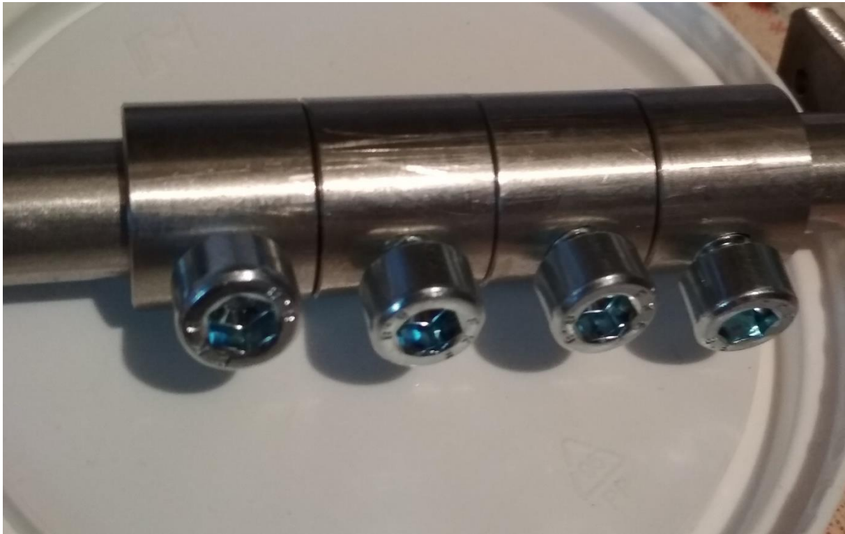
Slika 6. Pozicija grebena na vratilu
