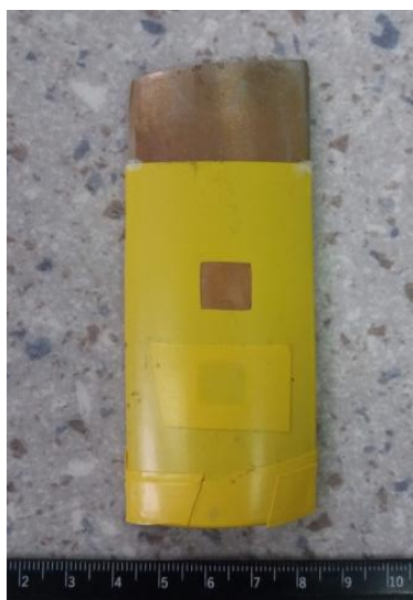
Slika 29. Uzorak pripremljen za elektrokemijsko ispitivanje
