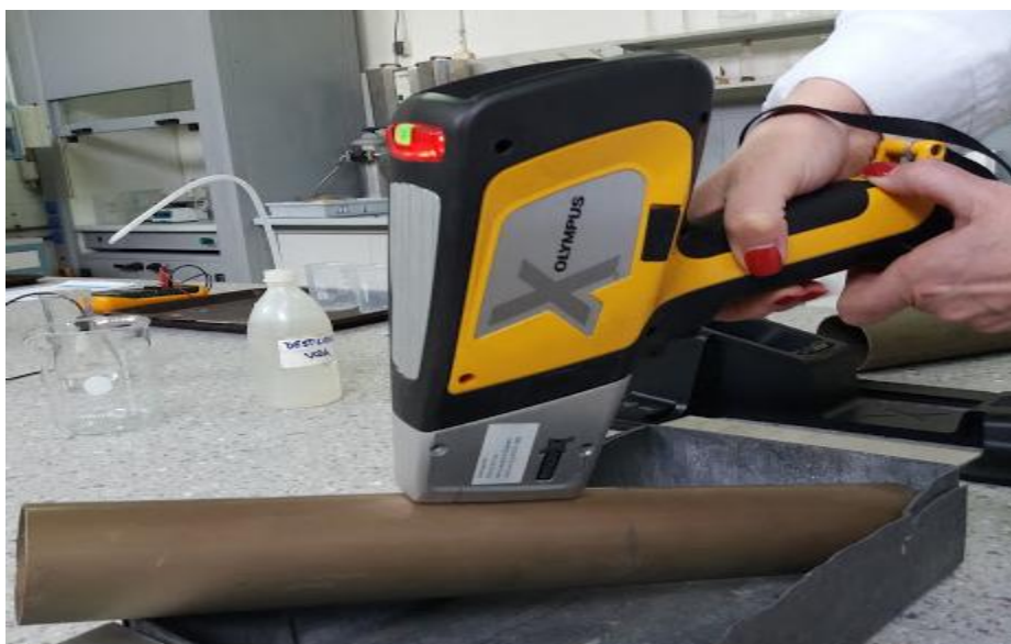
Slika 28. Ispitivanje kemijskog sastava uređajem Olympus XRF
