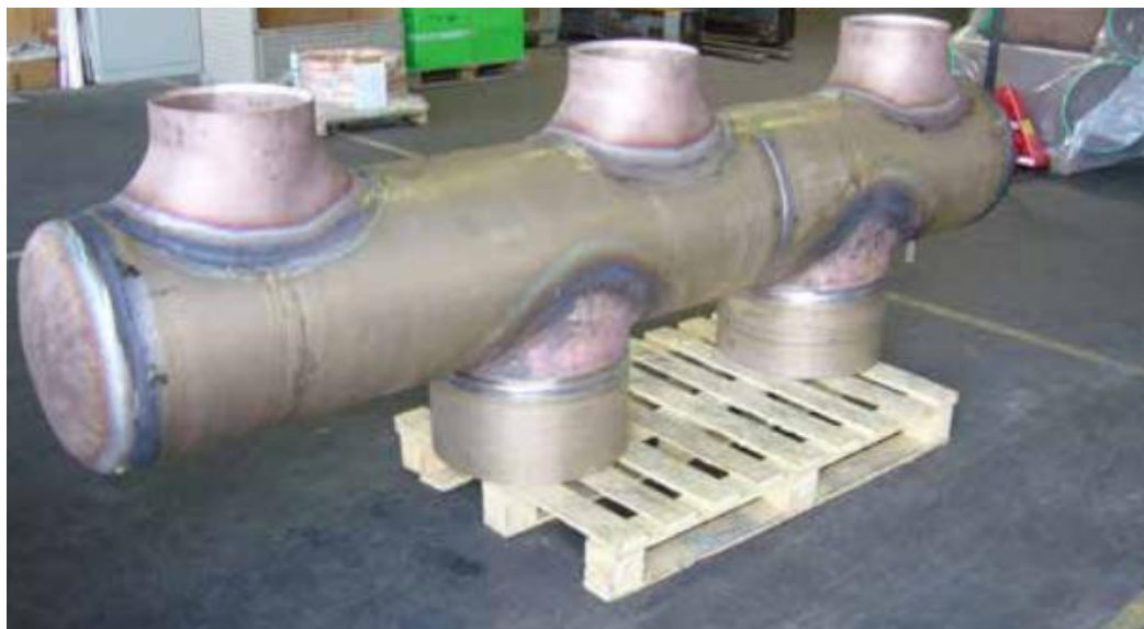
Slika 7. Zavarena konstrukcija izrađena od Cu – Ni legure [10]
