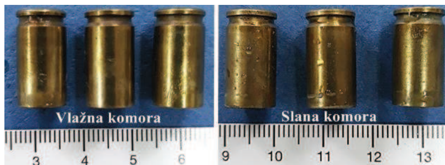
Slika 36. Uzorci čahura zaštićeni hlapivim inhibitorom VCI-369 nakon ispitivanja.
