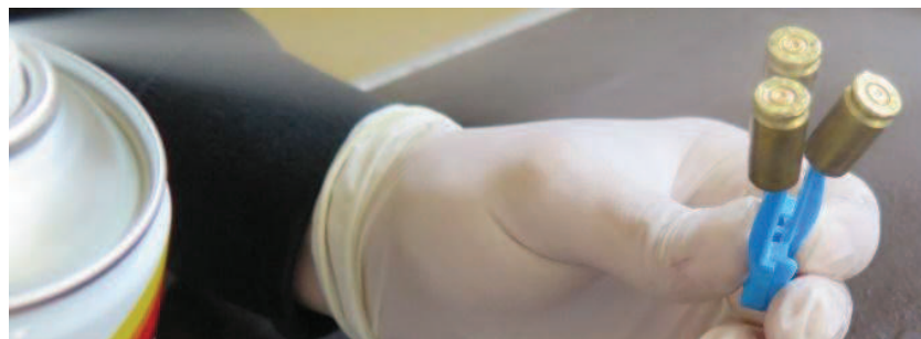
Slika 29. Nanošenje sredstva za podmazivanje i zaštitu od korozije Fluid Film.
