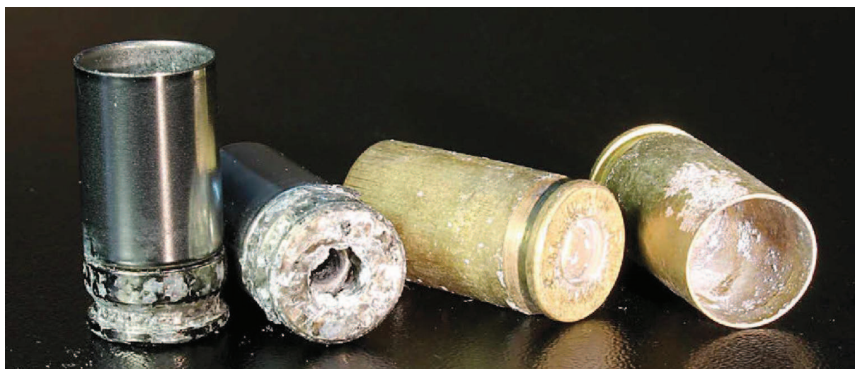
Slika 17. Nehrđajući dio koji nije korodirao [15].
