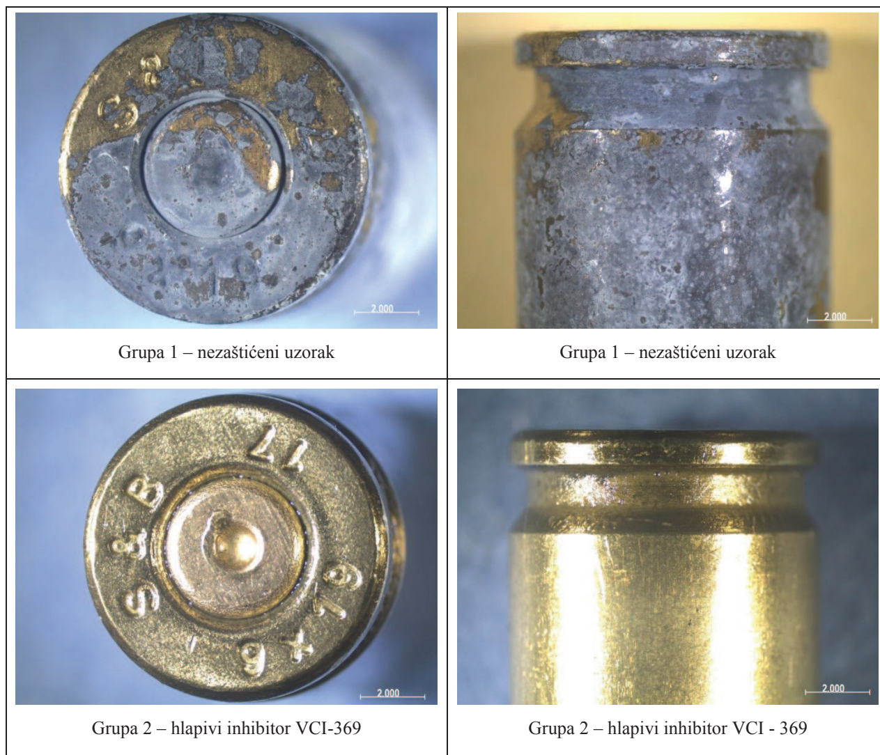
Tablica 13. Prikaz površine uzoraka nakon provedenih ispitivanja u vlažnoj komori.
