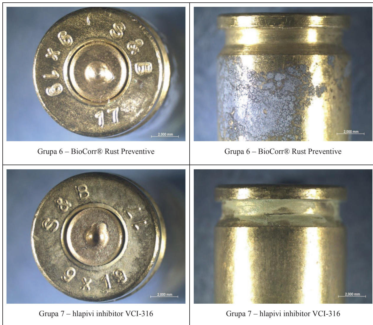
Tablica 13. Prikaz površine uzoraka nakon provedenih ispitivanja u vlažnoj komori (nastavak).
