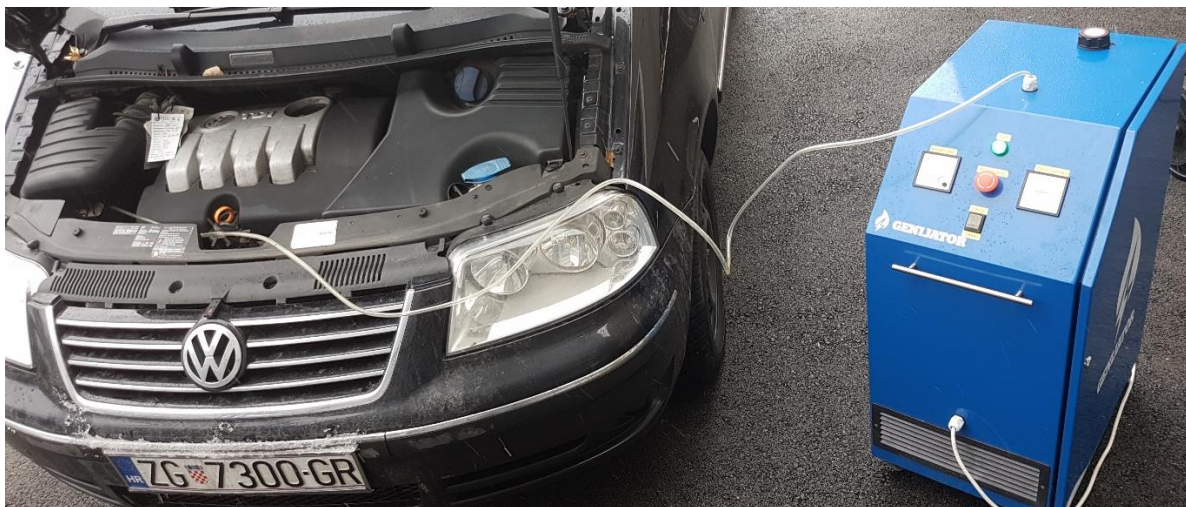
Slika 34. „Čišćenje“ vozila uređajem „Genijator“
