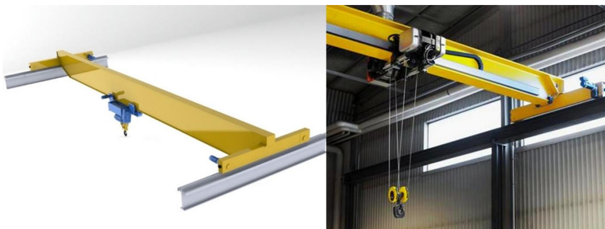
Slika 3. Mosni granici s jednim glavnim nosačem (jednogredni) [6],[5]
