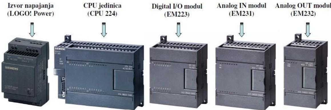
Slika 39. Tipične komponente SIMATIC S7-200 sustava [10]
