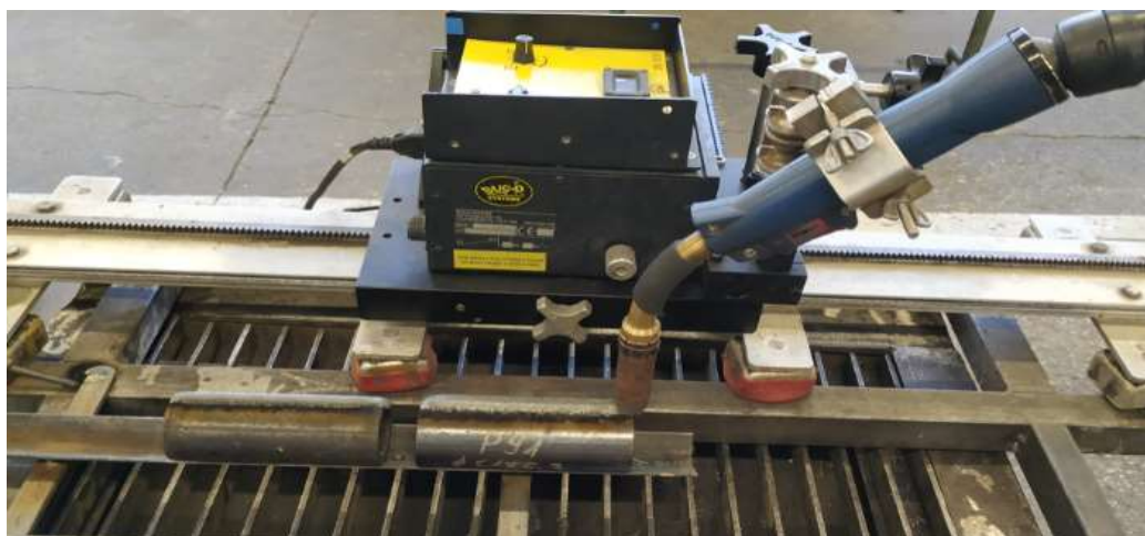
Slika 23. Radno mjesto s uređajem za automatizirano zavarivanje
