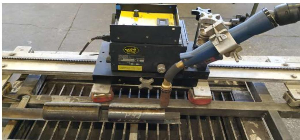
Slika 23. Radno mjesto s uređajem za automatizirano zavarivanje
