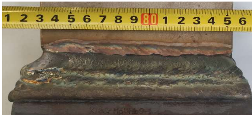
Slika 43. Uzorak 1 – druga strana; ručni MIG, tehnika njihanja
