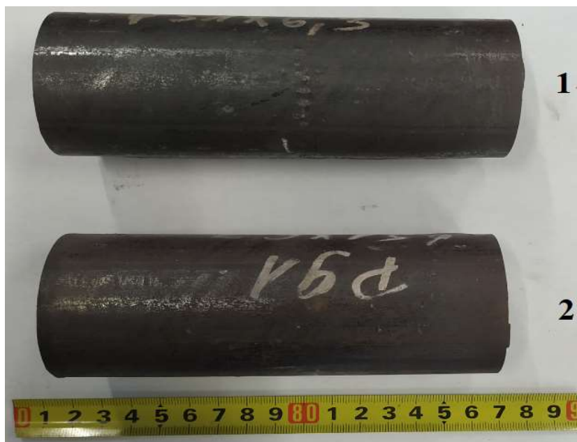
Slika 26. Izgled uzoraka prije navarivanja Inconel legure
