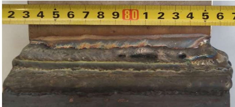
Slika 42. Uzorak 1 – prva strana; automatizirani MIG, neutralna tehnika
