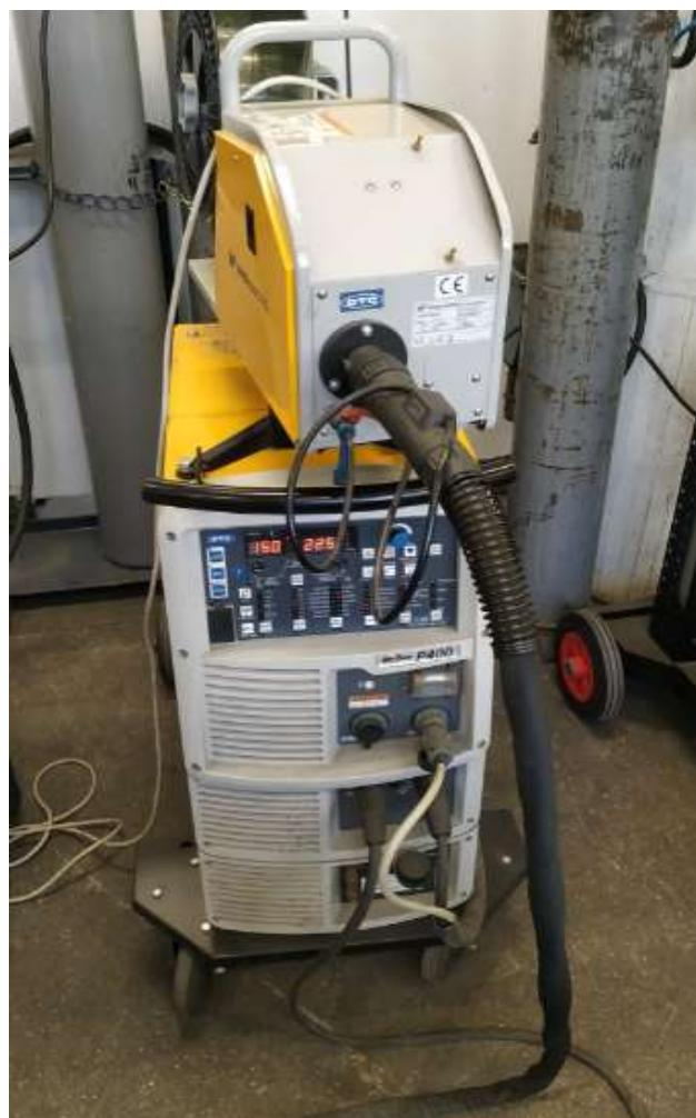
Slika 24. Izvor struje za zavarivanje Welbee P400
