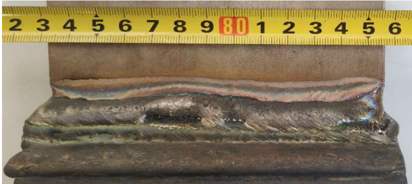
Slika 44. Uzorak 2 – prva strana; automatizirani MIG, neutralna tehnika
