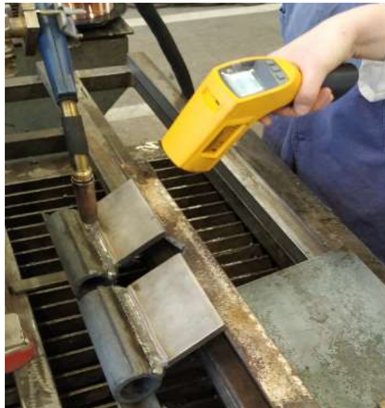
Slika 40. Provjera međuprolazne temperature Fluke 568 IR termometrom
