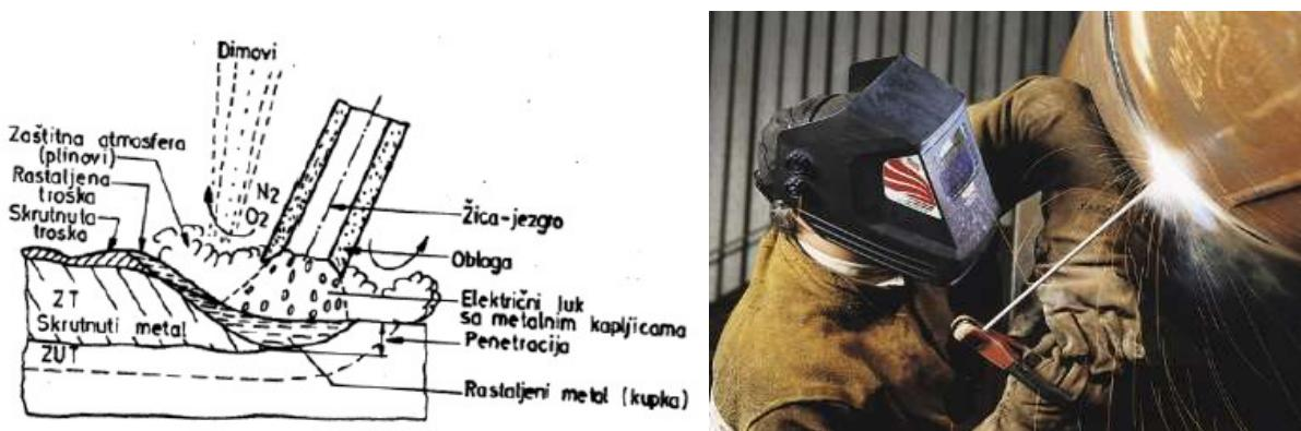
**Slika 18. REL zavarivanje; lijevo-shematski prikaz, desno-realni prikaz [19,27]**
