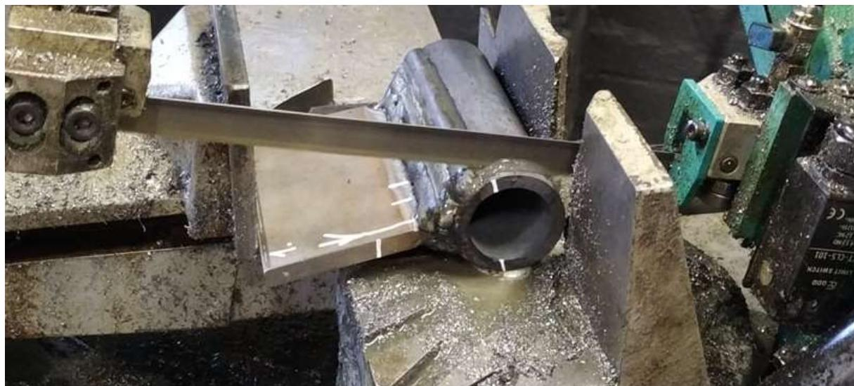
Slika 46. Izrezivanje makroizbrusaka tračnom pilom
