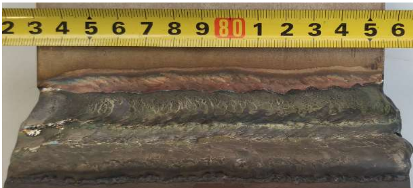
Slika 45. Uzorak 2 – druga strana; ručni MIG, tehnika njihanja
