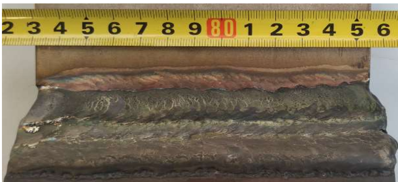
Slika 45. Uzorak 2 – druga strana; ručni MIG, tehnika njihanja
