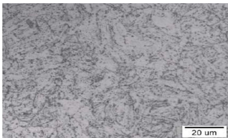
Slika 11. Mikrostruktura čelika P91 (svjetlosni mikroskop - 1000x) [13]
