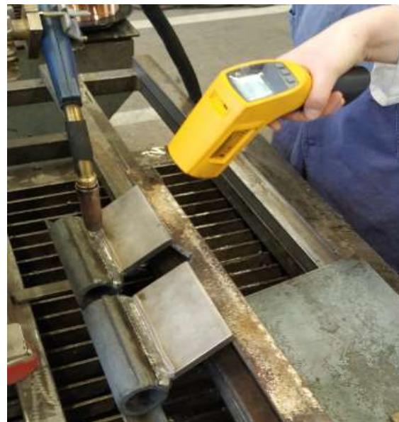
**Slika 40. Provjera međuprolazne temperature Fluke 568 IR termometrom**
