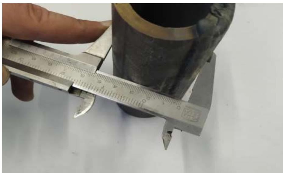
**Slika 35. Indirektno mjerjenje visine navarenog sloja**
