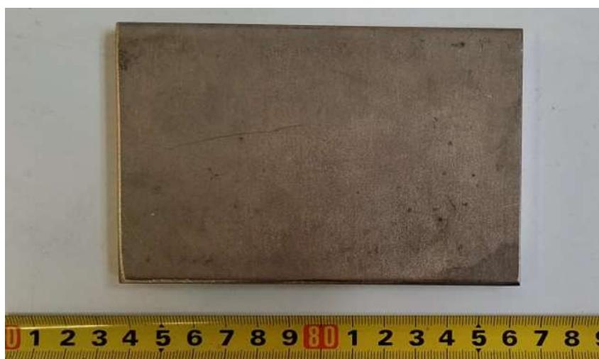
Slika 27. Izgled ploče od čelika X5CrNi18-10
