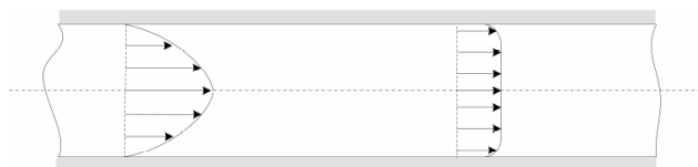
Slika 59. Laminarno strujanje (desno) i turbulentno strujanje (lijevo)
