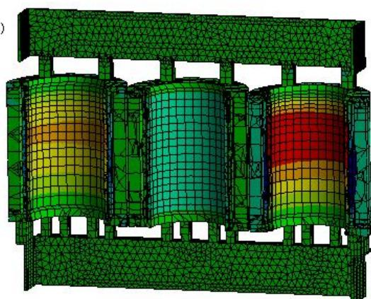
Slika 60. Peta forma vibriranja transformatora
