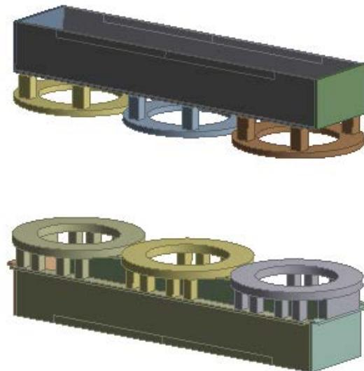
**Slika 26. Tlačne ploče i klocne na i ispod steznih ploča modelirane u ANSYS DesignModeleru**
