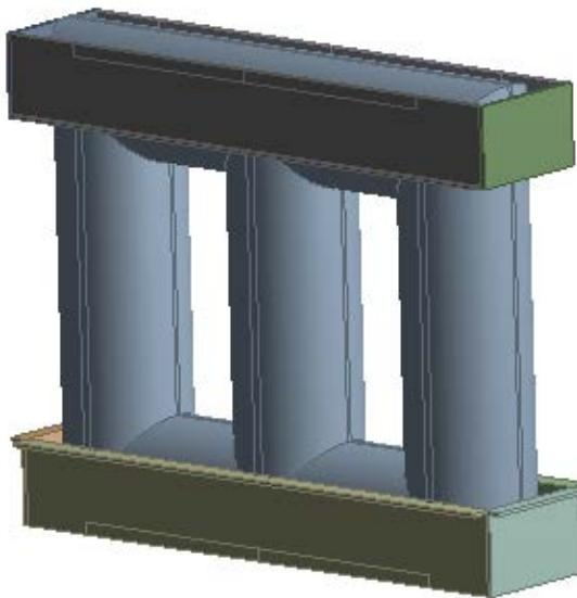
**Slika 21. Stezne ploče modelirane u ANSYS *DesignModeleru***
