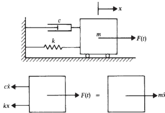
Slika 15. Prisilne vibracije sustava s jednim stupnjem slobode
