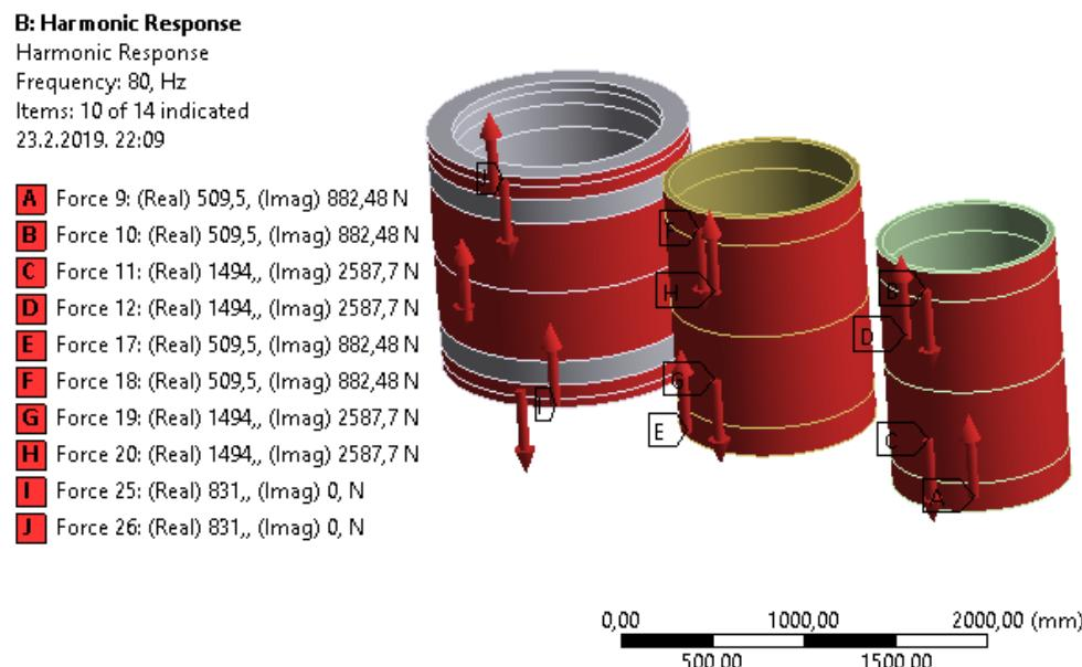
**Slika 35. Definiranje uzbude u vibracijskoj analizi**
