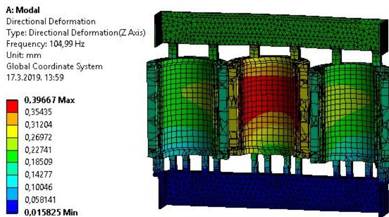
**Slika 56. Prva forma vibriranja transformatora**
