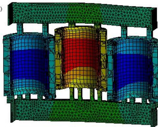
Slika 58. Treća forma vibriranja transformatora
