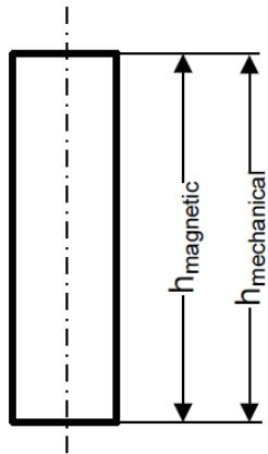
**Slika 6. Prikaz magnetske i mehaničke visine disk namota**
