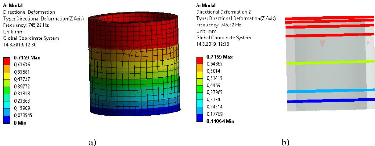
**Slika 46. Pomaci prve forme vibriranja za a) cijeli model VN namota te na b) pojedinim rubovima**
