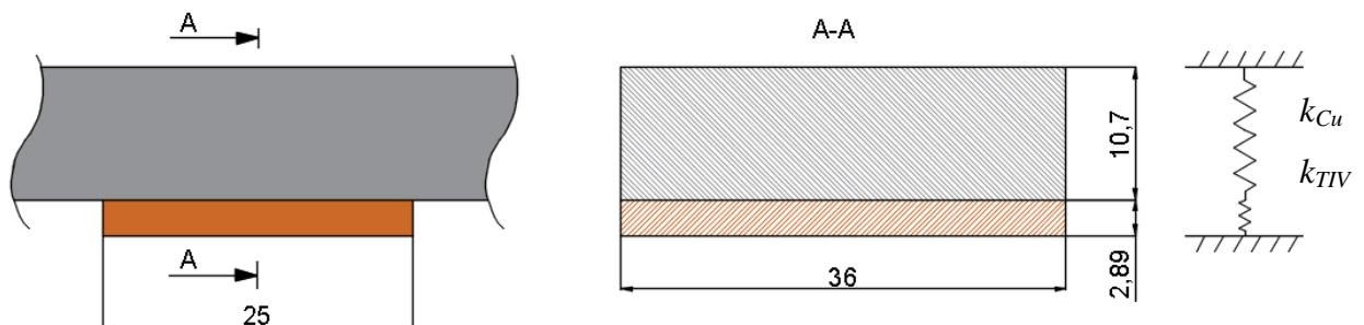
**Slika 25. Jedan vodič NN namota i jedna pločica u nacrtu, presjeku i aproksimirani serijom opruga**
