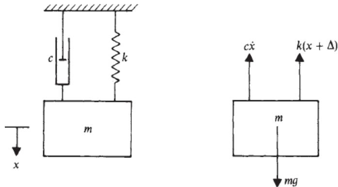
**Slika 12. Vibracijski sustav s jednim stupnjem slobode**
