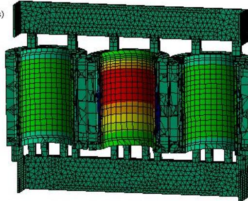
Slika 59. Četvrta forma vibriranja transformatora
