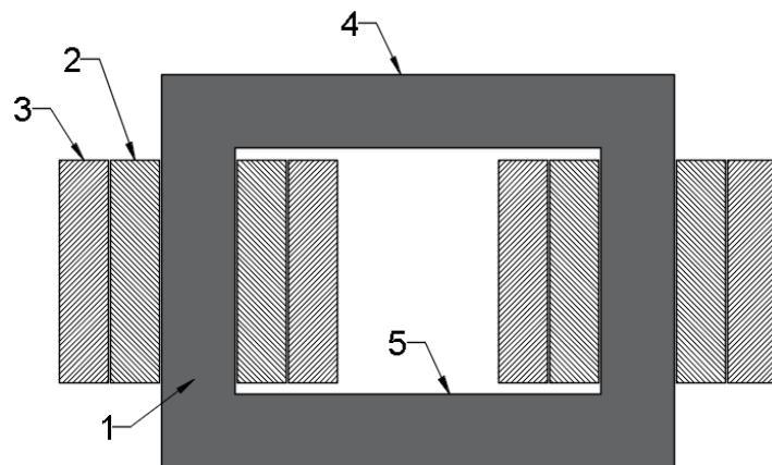
**Slika 1. Načelna izvedba jezgrastog transformatora**
