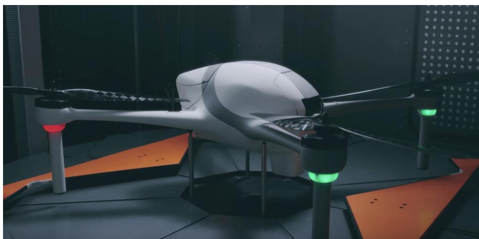
Slika 27. Pozicioniranje drona unutar stanice[7]
