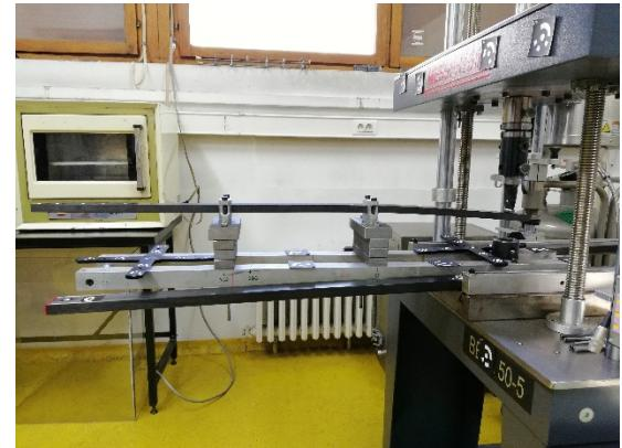
Slika 37. Testiranje lisnate opruge opterećivanjem opruge na jednom kraju
