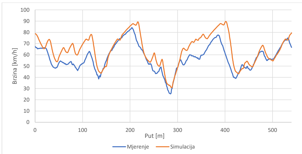
Slika 22. Usporedba grafa brzine u ovisnosti o putu između mjerenja i simulacije definirane parametrima vozača iz priručnika
