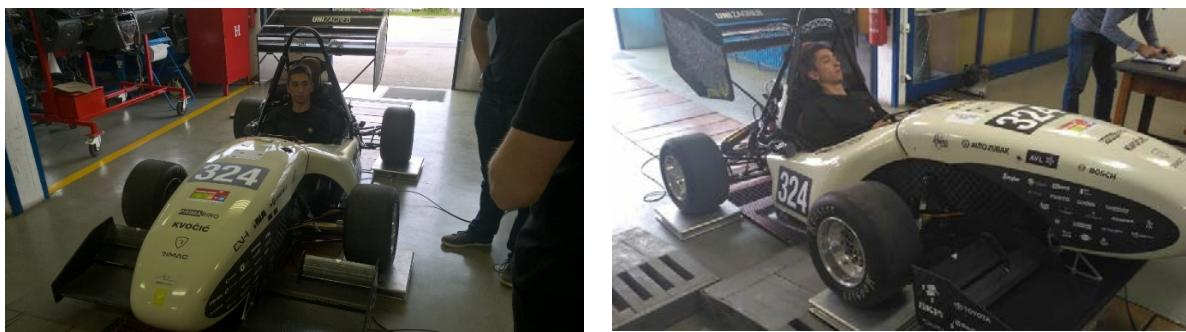
Slika 29. Mjerjenje težišta bolida *Strix* s vozačem na horizontalnoj podlozi (lijevo) te na kosini (desno)
