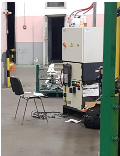
Slika 12. Upravljačka jedinica robota, R30iB Plus
